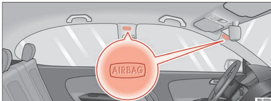
**Fig. 22** Ubicación de los airbags para la cabeza en el lado izquierdo del vehículo
