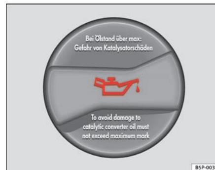
**Fig. 128** Tapón de la boca de llenado de aceite del motor en el vano motor
