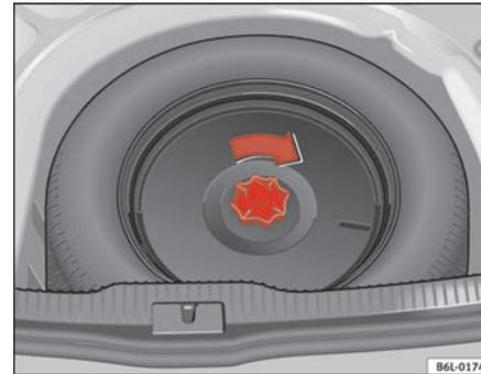
Fig. 138 Fijación de la rueda averiada
