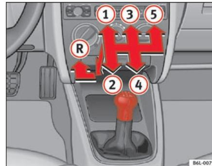
Fig. 100 Consola Central: esquema de una cambio manual de 5 marchas
