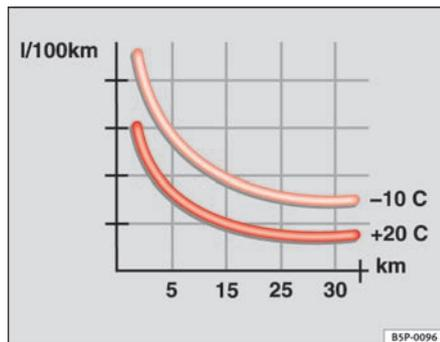
Fig. 122 Consumo de combustible (l/100 km) a dos temperaturas ambiente
