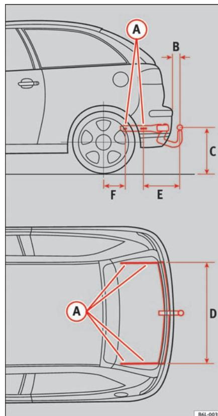
**Fig. 123** Puntos de fijación del dispositivo de remolque
