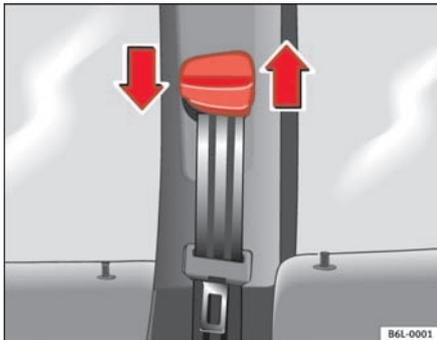
**Fig. 1** Ubicación del regulador de la altura del cinturón
