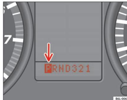
**Fig. 103 Pantalla del cuadro de instrumentos: bloqueo de la palanca selectora en la posición P**
