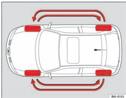
**Fig. 135** Esquema para el cambio de ruedas
