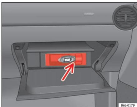
**Fig. 88** Conexión USB\* en guantera lado acompañante.
