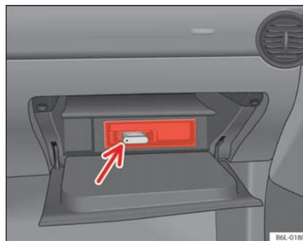
Fig. 87 Conexión iPod en guantera lado acompañante.
