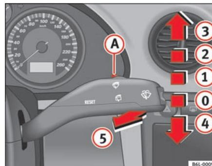
Fig. 65 Palanca del limpia-lavacristales
