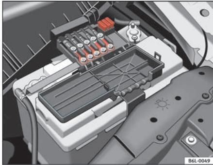
Fig. 147 Caja de fusibles sobre la batería
