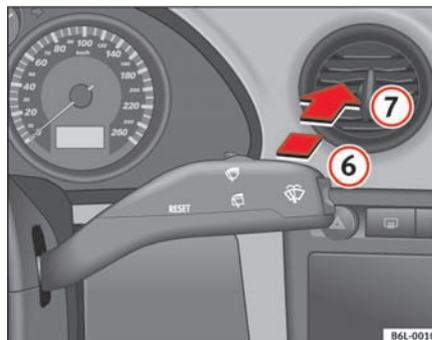
Fig. 67 Palanca del limpia-lavacristales: limpialuneta
