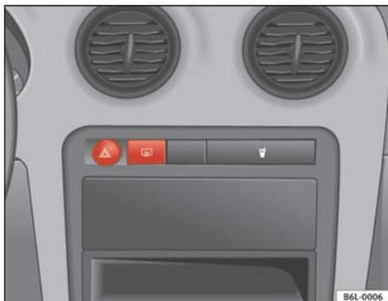
**Fig. 58** Tablero de instrumentos: conmutador de luneta térmica
