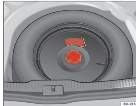
Abb. 138 Ausgewechseltes Rad befestigen
