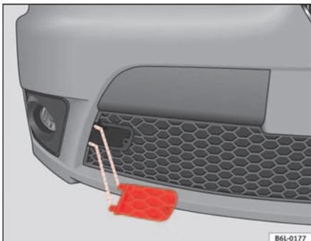
Abb. 173 Deckel der Abschleppöse unten am mittleren Gitter
