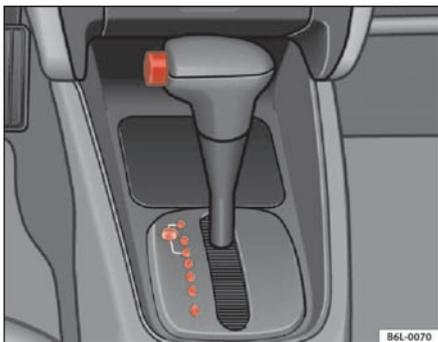
Abb. 102 Ausschnitt aus der Mittelkonsole: Wählhebel vom Automatikgetriebe
