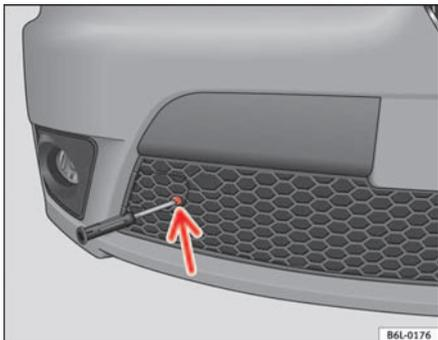
Abb. 172 Deckel der Abschleppöse unten am mittleren Gitter
