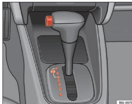
Abb. 101 Ausschnitt aus der Mittelkonsole: Wählhebel vom Automatikgetriebe
