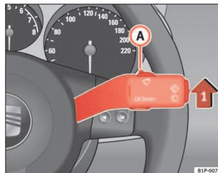
**Abb. 66** Scheibenwischerhebel
