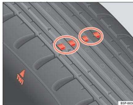
Abb. 134 Prinzipdarstellung Reifenprofil: Verschleißanzeiger ▶
