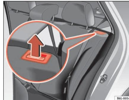
Abb. 77 Entriegelungstaste für die Rücksitzlehne
