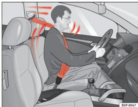
**Abb. 10** Angegurteter Fahrer, der bei einem plötzlichem Bremsmanöver vom richtig angelegten Sicherheitsgurt aufgefangen wird
