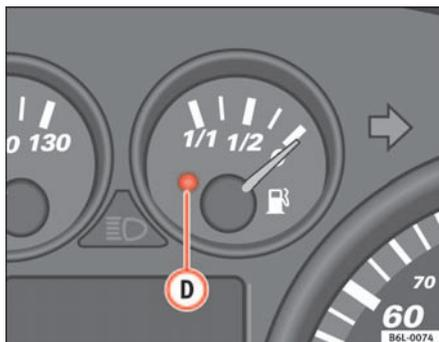
Abb. 33 Kraftstoffvorrats-Anzeige
