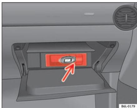
Abb. 88 Anschluss USB\* im Handschuhfach auf der Beifahrerseite.
