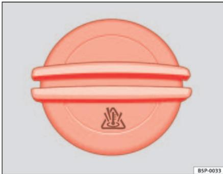
Abb. 129 Im Motorraum: Deckel des Kühlmittel-Ausgleichsbehälters
