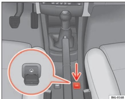
Abb. 86 Anschluss für einen zusätzlichen Audio-Eingang
