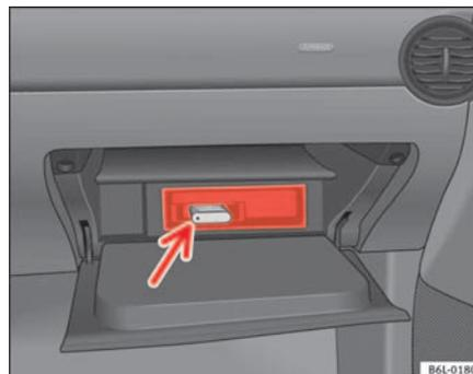
Abb. 87 Anschluss iPod im Handschuhfach auf der Beifahrerseite.
