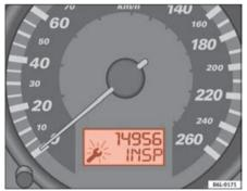
Fig. 39 Service interval display
