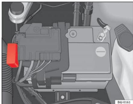
Fig. 132 Fusibles en el compartimento motor
