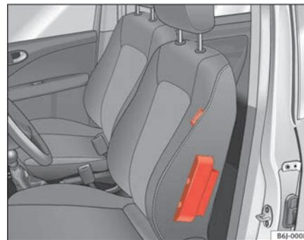
Fig. 19 Airbag lateral en el asiento del conductor ▶
