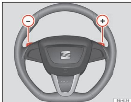
Fig. 102 Volante con levas para cambio automático
