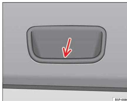
Fig. 47 Detalle del guardacavidad interior del portón trasero: cavidad para tirar
