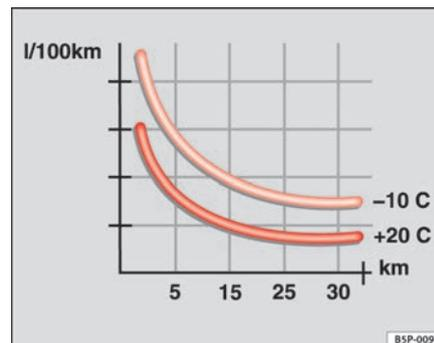
Fig. 110 Consumo de combustible (l/100 km) a dos temperaturas ambiente
