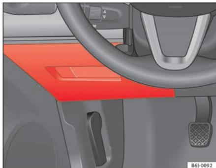
**Fig. 131** Fusibles en tablero de instrumentos
