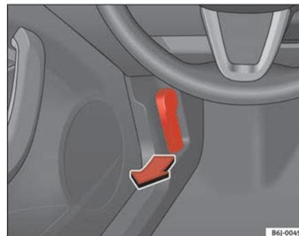
**Fig. 113** Palanca apertura capó motor
