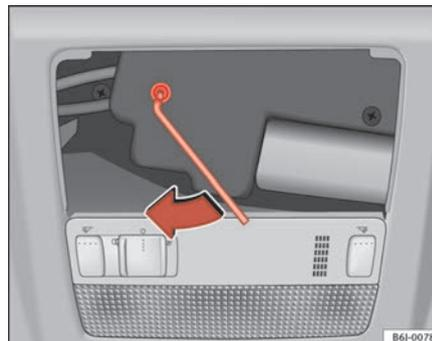
**Fig. 51** Accionamiento de emergencia techo panorámico/deflector ▶
