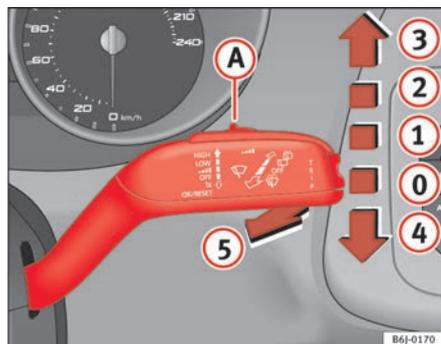
Fig. 61 Palanca del limpi-lavacristales
