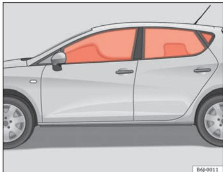
Fig. 22 Airbags para la cabeza inflados
