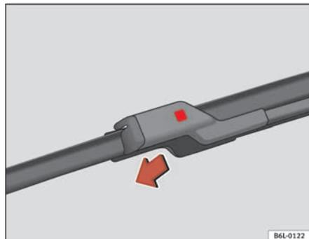
Fig. 120 Cambio escobilla limpiaparabrisas
