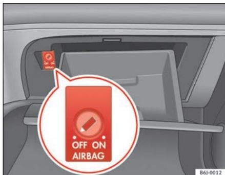
Fig. 23 En la guantera: conmutador con llave para activar y desactivar el airbag del acompañante
