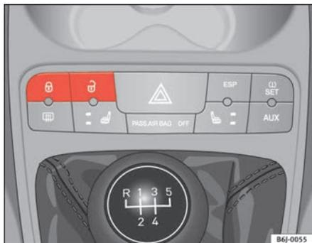
Fig. 41 Pulsador del cierre centralizado
