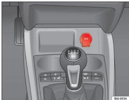
Fig. 83 Toma de corriente delantera
