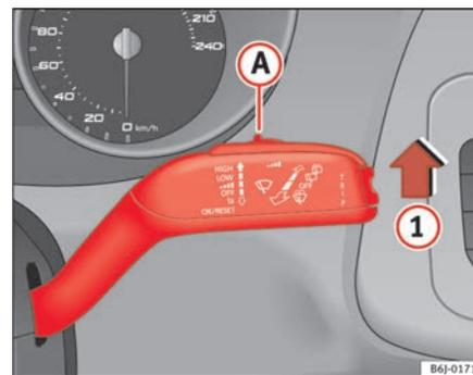
**Fig. 62 Palanca del limpiaparabrisas**
