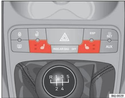
Fig. 70 Conmutador de la calefacción de los asientos delanteros
