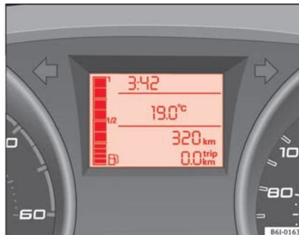
Fig. 31 Indicador de nivel del depósito de combustible
