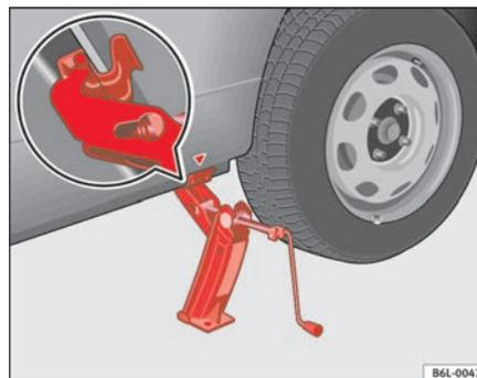
**Fig. 128** Colocación del gato
