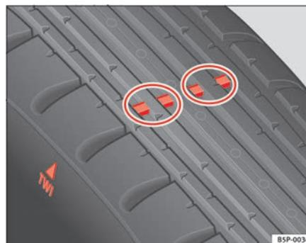
**Fig. 123** Indicadores de desgaste del perfil del neumático
