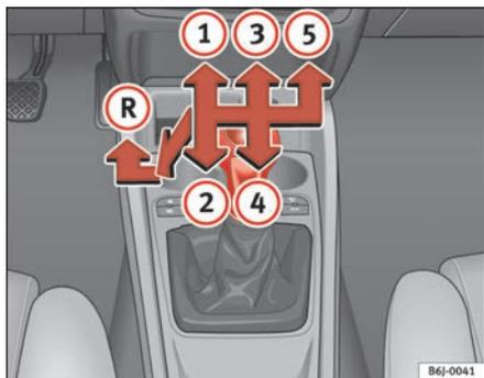
Fig. 96 Consola Central: esquema de una cambio manual de 5 marchas
