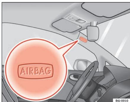
Fig. 21 Ubicación del airbag para la cabeza en el lado izquierdo del vehículo
