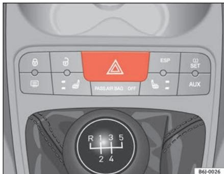
**Fig. 56 Consola central: conmutador de los intermitentes de emergencia**
