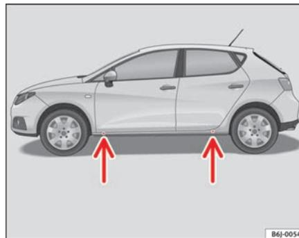
**Fig. 127** Puntos de apoyo del gato
