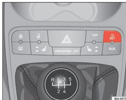
Fig. 38 Consola central: tecla del sistema de control de los neumáticos ▶
