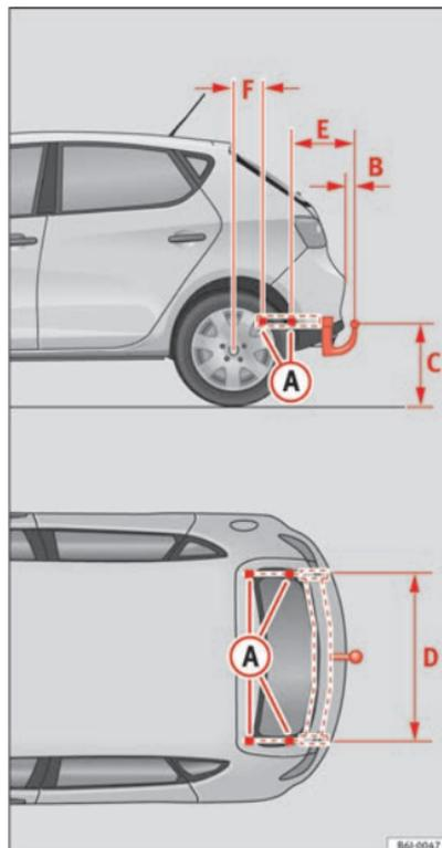
Fig. 111 Puntos de fijación del dispositivo de remolque
