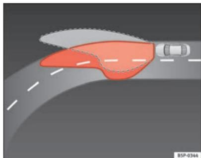
Fig. 54 Iluminación de la curva con faros autodireccionables
