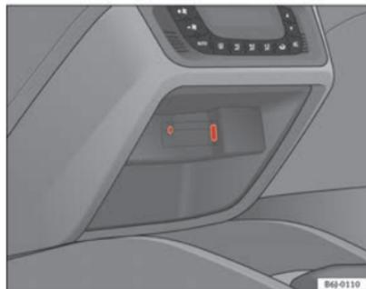
Fig. 85 Conexión entrada AUX/USB\* (en función del equipamiento)
