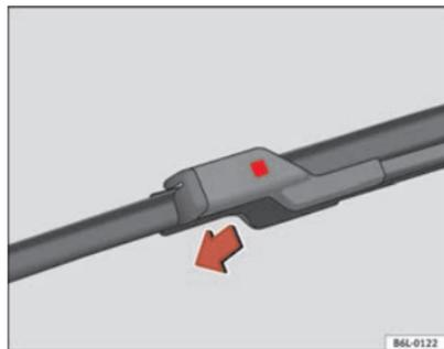
Fig. 120 Cambio escobilla limpiaparabrisas
