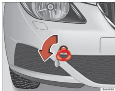
Fig. 152 Atornillado de la argolla de remolque en la parte delantera del vehículo
