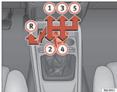
Fig. 96 Consola Central: esquema de un cambio manual de 5 marchas
