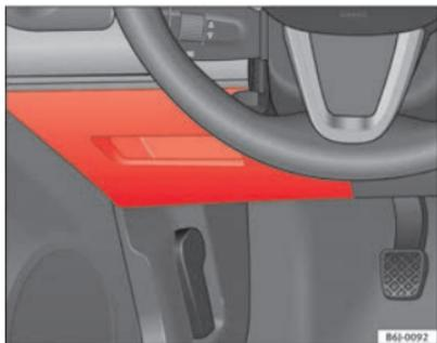
**Fig. 131** Fusibles en tablero de instrumentos
