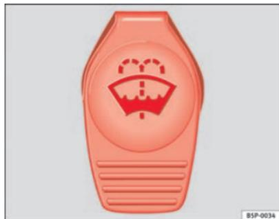
Fig. 119 Tapón del depósito del lavacristales en el vano motor.
