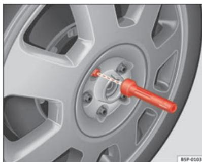
**Fig. 129** Cambio de rueda: Útil de hexágono interior para girar los tornillos
