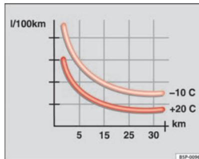
Fig. 110 Consumo de combustible (l/100 km) a dos temperaturas ambiente
