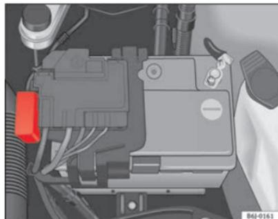
Fig. 132 Fusibles en el compartimiento motor
