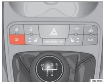
Fig. 55 Consola central: conmutador de luneta térmica
