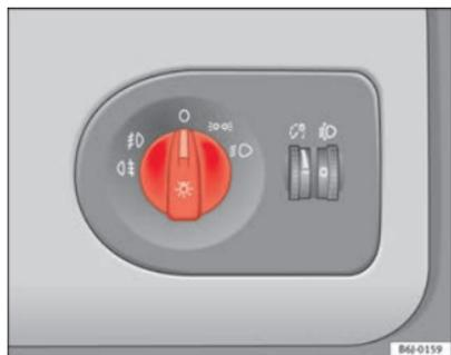
Fig. 52 Detalle del tablero de instrumentos: mando de las luces, faros antiniebla y luz trasera antiniebla
