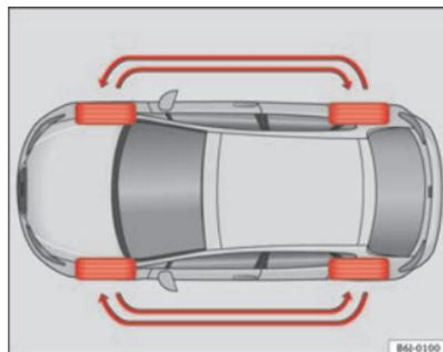
**Fig. 124** Esquema para el cambio de ruedas
