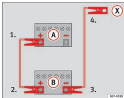
Fig. 151 Esquema de conexión de los cables de emergencia
