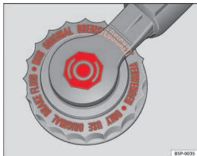
Fig. 122 Tapón del depósito del líquido de frenos en el vano motor
