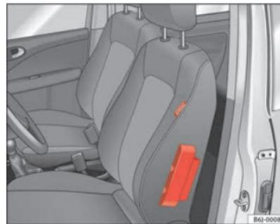
Fig. 19 Airbag lateral en el asiento del conductor ▶
