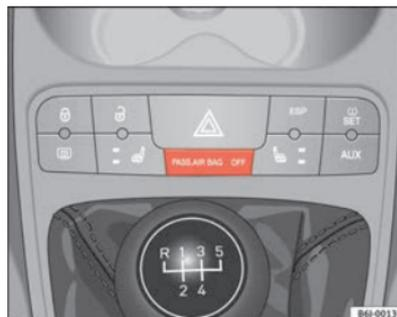
Fig. 24 Testigo de control de la desactivación del airbag del acompañante
