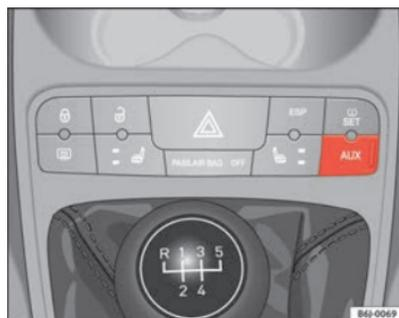
Fig. 84 Conexión AUX en consola central (en función del equipamiento)
