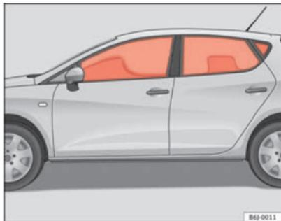
Fig. 22 Airbags para la cabeza inflados
