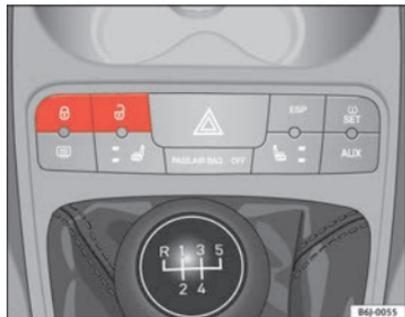
Fig. 41 Pulsador del cierre centralizado
