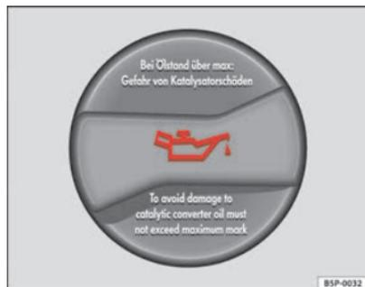
Fig. 117 Tapón de la boca de llenado de aceite del motor en el vano motor
