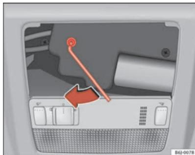
**Fig. 51** Accionamiento de emergencia techo panorámico/deflector ▶
