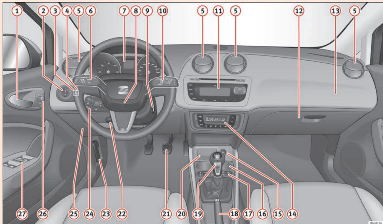
Fig. 29 Tablero de instrumentos
