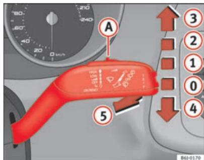
Fig. 61 Palanca del limpia-lavacristales
