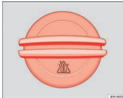
**Fig. 118** Tapón del depósito de expansión del líquido refrigerante en el vano motor
