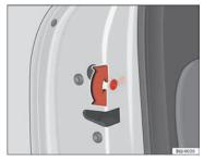
Fig. 40 Childproof lock on the left hand side door
