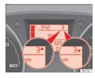
Fig. 33 Gear display
