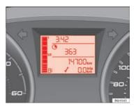
Fig. 37 Service interval display
