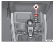
Fig. 100 The Start-Stop function button.
