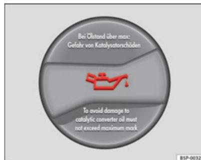
**Fig. 126** Dans le compartiment moteur : bouchon de l'orifice de remplissage d'huile moteur
