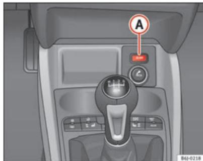
Fig. 101 Détail du bouton du fonctionnement Start-Stop.
