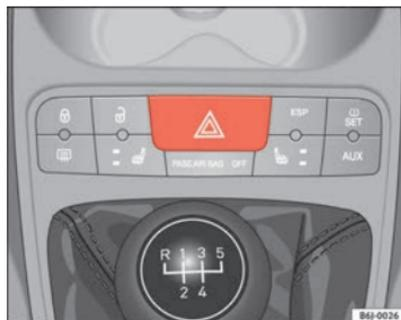
**Fig. 59** Console centrale : commande des feux de détresse
