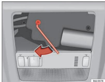
**Fig. 53 Actionnement d'urgence toit ouvrant / déflecteur**
