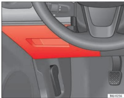
Fig. 141 Fusibles dans la planche de bord
