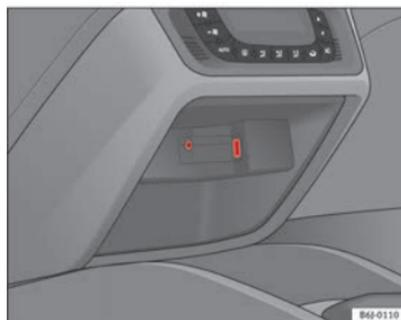
**Fig. 89** Connexion d'entrée AUX/USB (en fonction de l'équipement)
