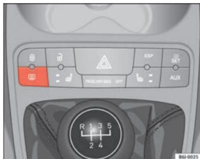
Fig. 58 Console centrale : contacteur de dégivrage de lunette arrière ▶
