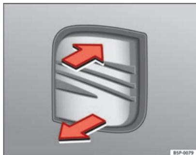
Fig. 48 Hayon : ouverture de l'extérieur
