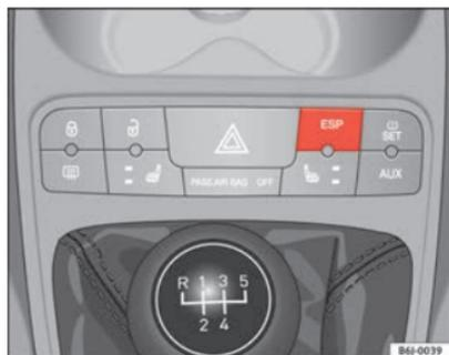
Fig. 98 Détail de la console centrale : touche ESP.
