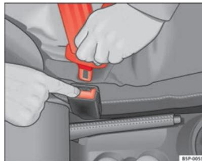
Fig. 15 Retrait du pêne du boîtier de verrouillage ▶
