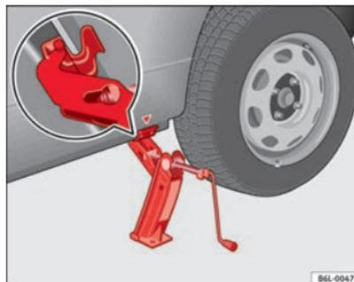
Fig. 139 Mise en place du cric
