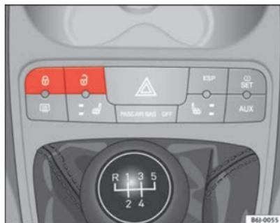
Fig. 43 Touche de verrouillage centralisé
