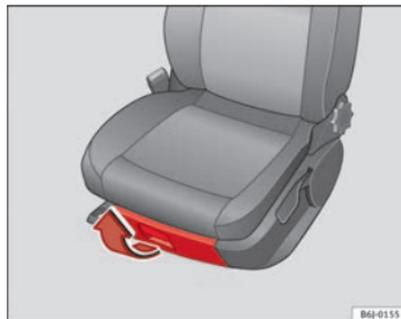
Fig. 81 Rangement sous le siège avant droit
