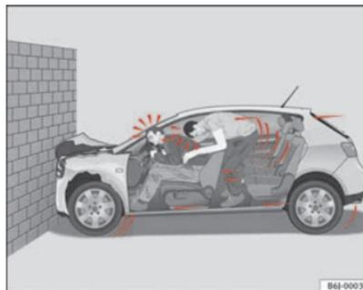
**Fig. 7** Le véhicule heurte le mur : les passagers n'ont pas bouclé leur ceinture
