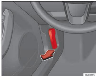
Fig. 123 Levier d'ouverture du capot-moteur
