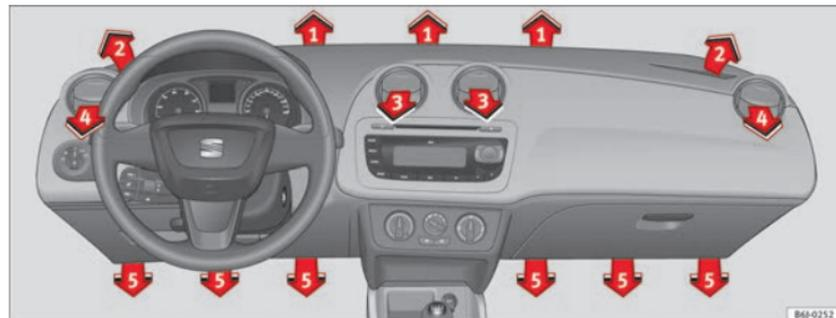
Fig. 93 Diffuseur d'air
