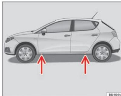
Fig. 138 Points d'appui du cric
