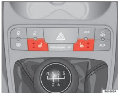
Fig. 73 Contacteur du chauffage des sièges avant
