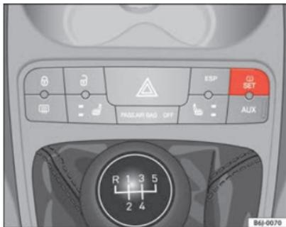
Fig. 40 Console centrale : touche du système de contrôle des pneus
