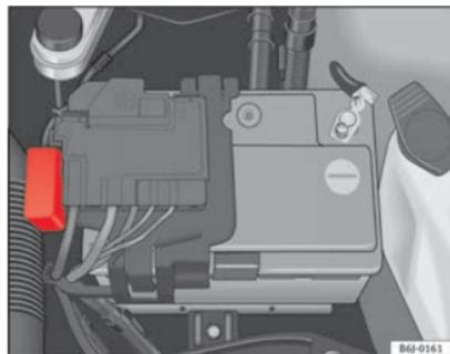
Fig. 142 Fusibles dans le compartiment-moteur
