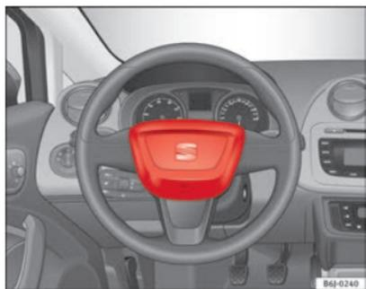
**Fig. 16 Airbag du conducteur dans le volant**
