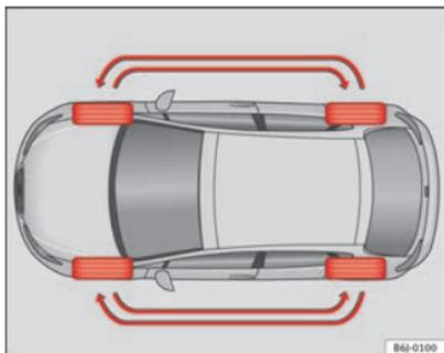
Fig. 135 Schéma de permutation des roues
