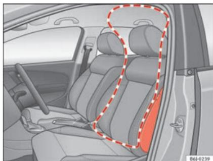
**Fig. 20** Airbag latéral dans le siège du conducteur
