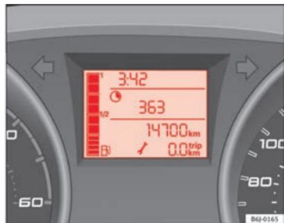
Fig. 37 Indicateur de fréquence d'entretien
