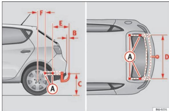
**Fig. 118** Points de fixation du dispositif d'attelage
