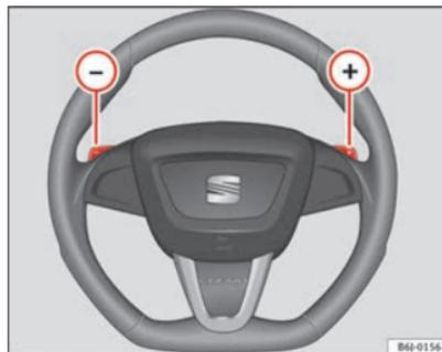
Fig. 109 Volant avec commandes pour boîte de vitesses automatique
