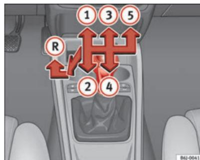
Fig. 103 Console centrale : schéma d'une boîte mécanique 5 vitesses
