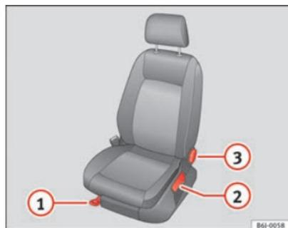
Fig. 72 Éléments de commande du siège avant gauche
