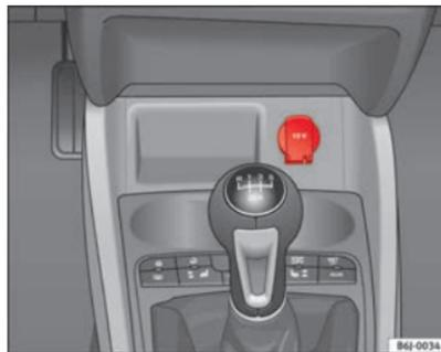
Fig. 87 Prise de courant avant
