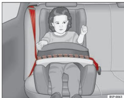
**Fig. 24** Siège pour enfant du groupe 1 monté dans le sens de la marche sur la banquette arrière.
