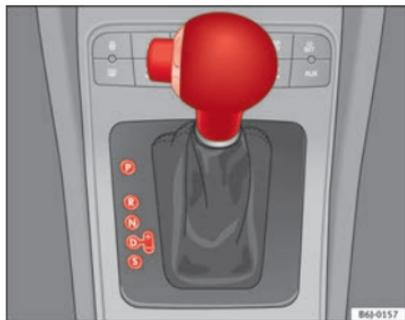
Fig. 108 Changement de vitesses avec la commande tiptronic
