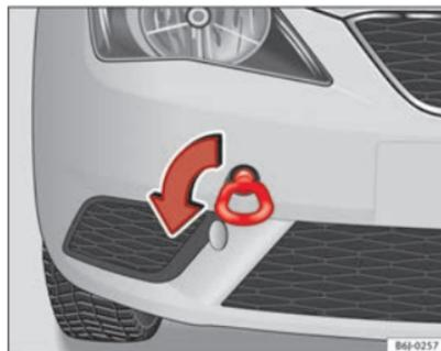
Fig. 170 Vissage de l'œillet de remorquage avant
