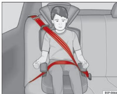
**Fig. 25** Siège pour enfants monté dans le sens de la marche sur la banquette arrière.
