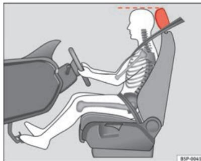
Fig. 2 Réglage correct de l'appui-tête du conducteur
