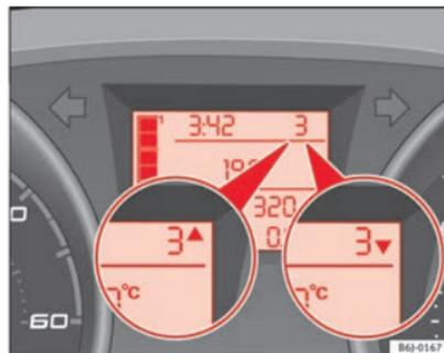
Fig. 33 Gear display
