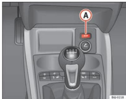
Fig. 101 The Start-Stop function button.
