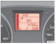
Fig. 37 Service interval display
