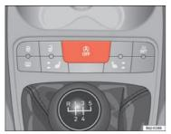
Fig. 101 The Start-Stop function button.
