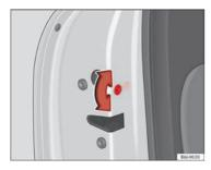
Fig. 44 Childproof lock on the left hand side door
