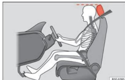
**Abb. 76** Die richtige Kopfstützeinstellung des Fahrers.
