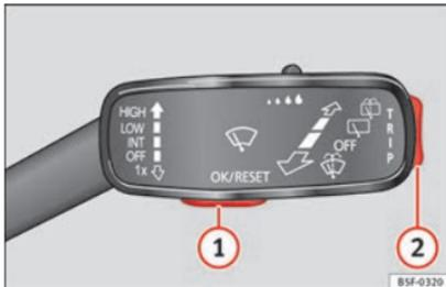
**Abb. 37** Scheibenwischerhebel: Steuertasten.
