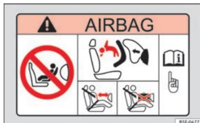
**Abb. 23** Sonnenblende auf der Beifahrerseite: Airbagaufkleber.
