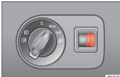
Abb. 134 Instrumententafel: Regler für Leuchtweitenregulierung.
