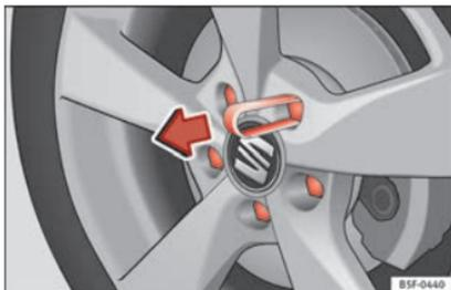
Abb. 63 Rad: Radschrauben mit Deckel.
