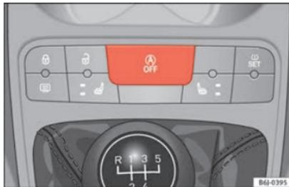
**Abb. 174** Ansicht des Tasters für den Start-Stopp-Betrieb
