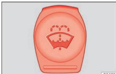
**Abb. 56** Im Motorraum: Deckel des Scheibenwaschbehälters.
