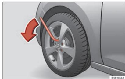
Abb. 65 Rad: Radschrauben lockern.
