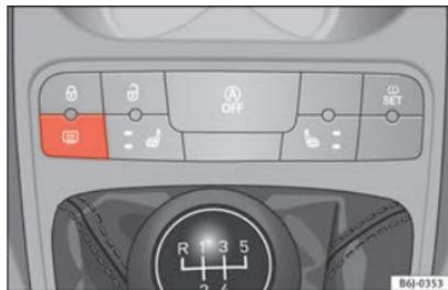
**Abb. 136** Mittelkonsole: Schalter für Heckscheibenbeheizung.
