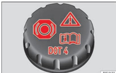
**Abb. 55** Motorraum: Deckel des Bremsflüssigkeitsbehälters
