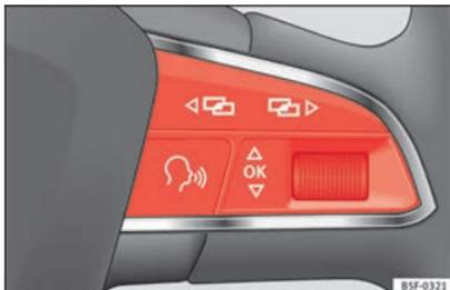
**Abb. 38** Rechte Seite Multifunktions-Lenkrad: Steuertasten.
