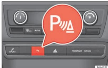
Abb. 177 Mittelkonsole: Taste für Einparkhilfe.
