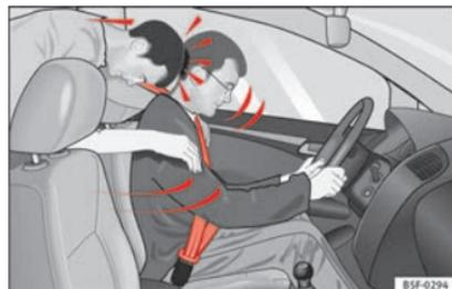
**Abb. 82** Der nicht angegurtete Mitfahrer auf dem Rücksitz schleudert nach vorn auf den angegurteten Fahrer.
