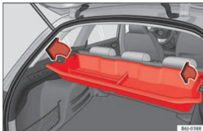
Abb. 160 Gepäckraum: Ausbau des Ablagefachs.
