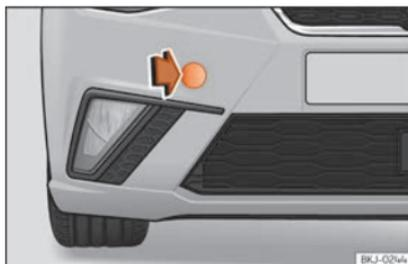
**Fig. 99** Parte derecha del parachoques delantero: retirar la tapa.
