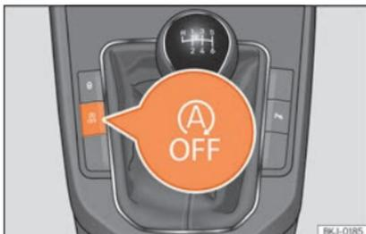
**Fig. 226** Consola central: tecla del sistema Start-Stop.
