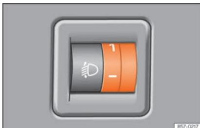
**Fig. 145** Tablero de instrumentos: regulador del alcance de los faros.
