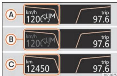
**Fig. 228** En la pantalla del cuadro de instrumentos: indicaciones del estado del limitador de velocidad.
