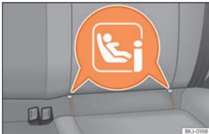
**Fig. 34** Anillos de sujeción ISOFIX/iSize.
