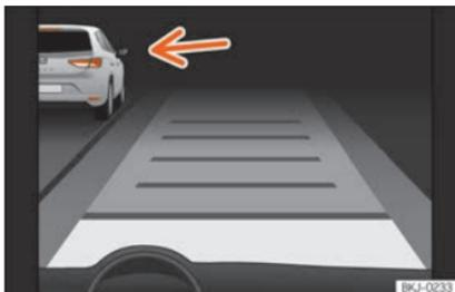
**Fig. 240** En la pantalla del cuadro de instrumentos: ACC activo, vehículo detectado por la izquierda
