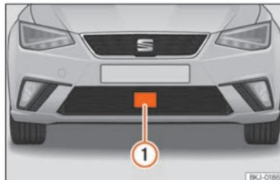
**Fig. 232** En el paragolpes delantero: sensor de radar.
