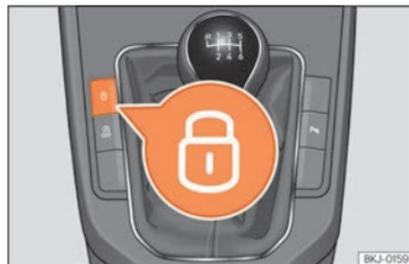
Fig. 134 Pulsador del cierre centralizado.
