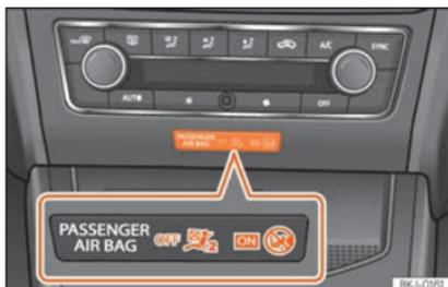
**Fig. 97** Parte central del tablero de instrumentos: testigo de control de la desactivación del airbag del acompañante.
