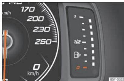
Fig. 121 Cuadro de instrumentos digital: indicador del nivel de combustible.
