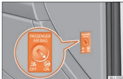
**Fig. 25** Conmutador del airbag frontal del acompañante.
