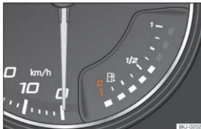
Fig. 120 Cuadro de instrumentos analógico: indicador de nivel de combustible
