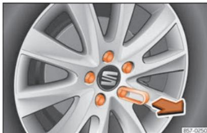
**Fig. 73** Rueda: tornillos de la rueda con capuchones.
