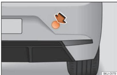
**Fig. 101** Parte derecha del parachoques trasero: tapa-cubierta.
