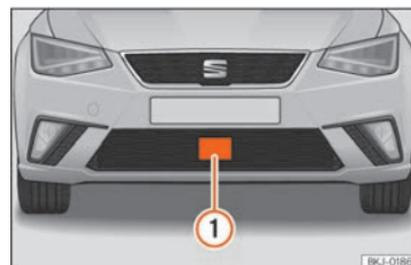
**Fig. 237** En el paragolpes delantero: sensor de radar.
