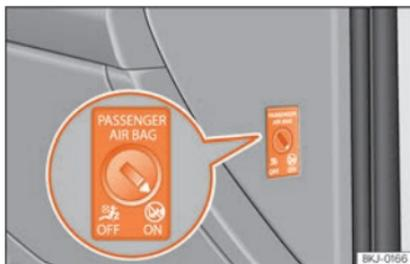
**Fig. 96** Conmutador con llave para activar y desactivar el airbag del acompañante.
