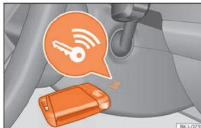
Fig. 218 A la derecha de la columna de dirección: arranque de emergencia.
