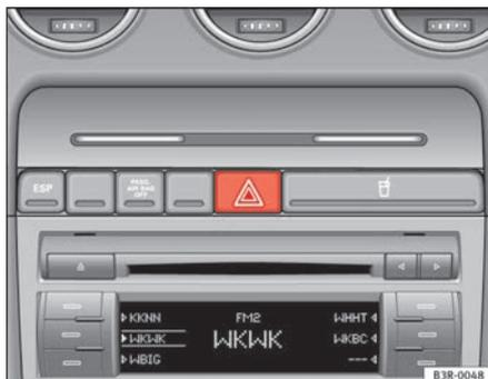
Fig. 92 Console centrale : commande du signal de détresse
