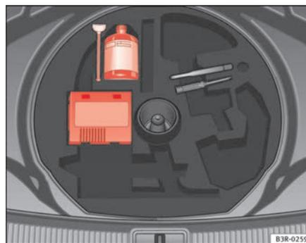
**Fig. 187** Kit anticrevaison (Tire Mobility System) logé sous le plancher de chargement dans le coffre à bagages
