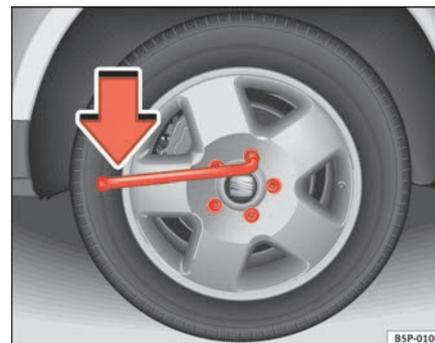
Fig. 189 Changement de roue : Desserrez les boulons de roue
