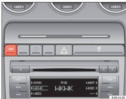
Fig. 146 Détail de la console centrale : touche ESP
