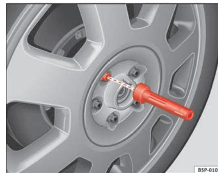
Fig. 192 Changement de roue : Outil à hexagone intérieur pour tourner les vis
