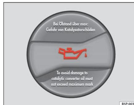
Fig. 174 Dans le compartiment-moteur : bouchon de l'orifice de remplissage d'huile-moteur
