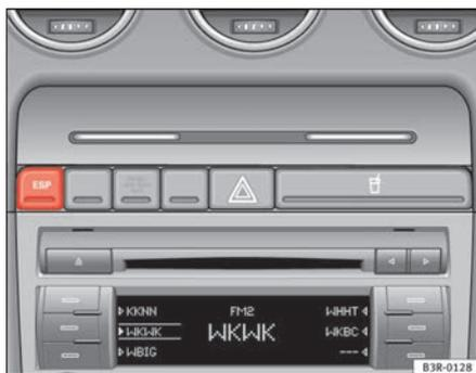
**Fig. 154** Console centrale avec commande du contrôle électronique de la stabilité.
