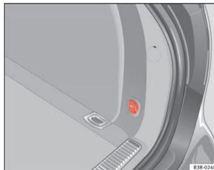
**Fig. 136** Vue partielle du revêtement latéral du coffre à bagages : prise de courant de 12 volts
