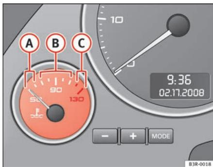
Fig. 38 Température de liquide de refroidissement
