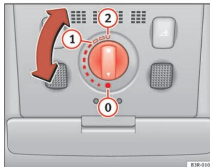
Fig. 82 Détail du ciel de pavillon : commande rotative du toit ouvrant coulissant/relevable
