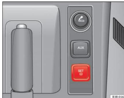
**Fig. 182** Détail de la console centrale : touche de l'indicateur de contrôle des pneus
