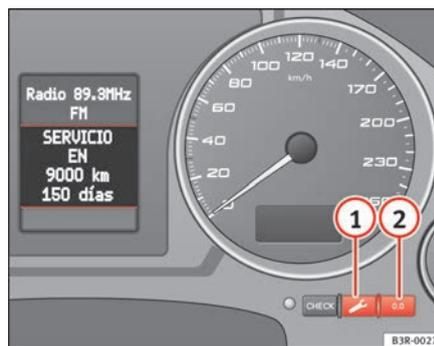
Fig. 52 Détail du combiné d'instruments : Indicateur de périodicité d'entretien
