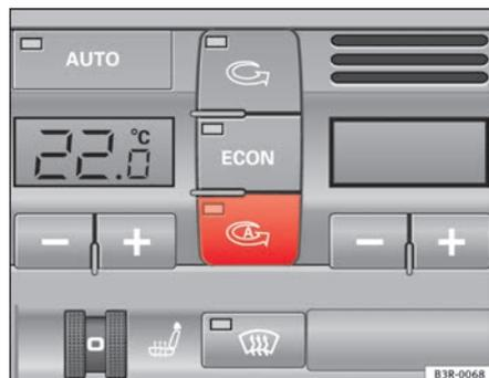
Fig. 142 Commande du mode de circulation d'air automatique
