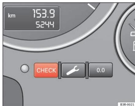
Fig. 57 Détail du combiné d'instruments : Touche de contrôle CHECK
