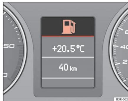
Fig. 55 Afficheur : niveau faible de carburant
