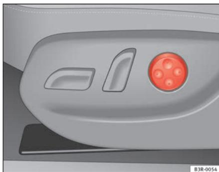
**Fig. 110** Siège avant : plaque de réglage de l'appui lombaire
