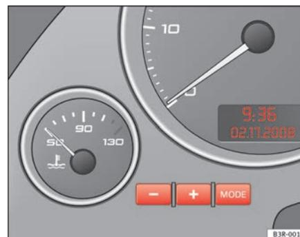
Fig. 40 Détail du combiné d'instruments : Horloge numérique
