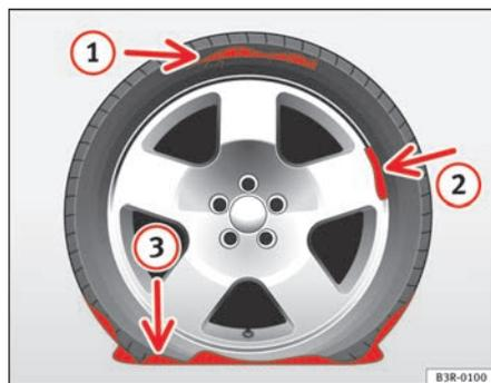
Fig. 194 Pinchazos para los que no se adecua el sistema tire mobility system
