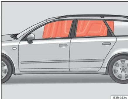
Fig. 26 Airbags para la cabeza inflados
