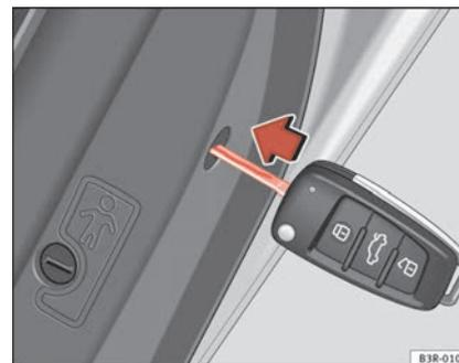
Fig. 73 Activar el bloqueo de emergencia ▶
