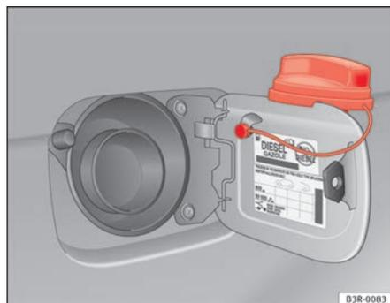
Fig. 168 Tapa del depósito con el tapón encajado
