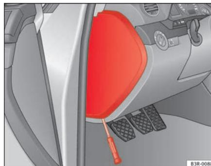
Fig. 196 Tapa de la caja de fusibles en el lado izquierdo del tablero de instrumentos
