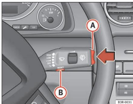
Fig. 63 Palanca del limpiaparabrisas: Tecla Reset y selector
