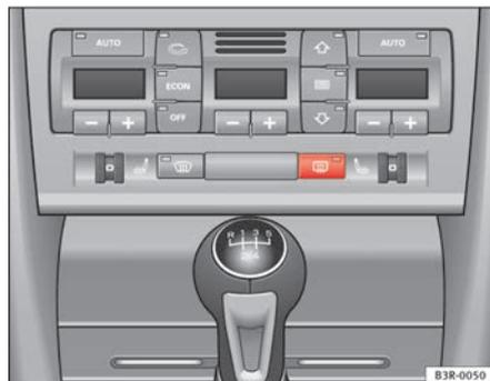
Fig. 98 Interruptor para luneta térmica
