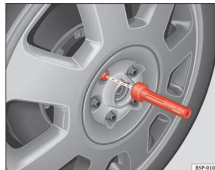
**Fig. 192 Cambio de rueda: Útil de hexágono interior para girar los tornillos**
