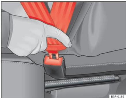
Fig. 11 Cierre y lengüeta del cinturón de seguridad
