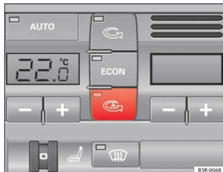
Fig. 142 Tecla para la recirculación de aire automática
