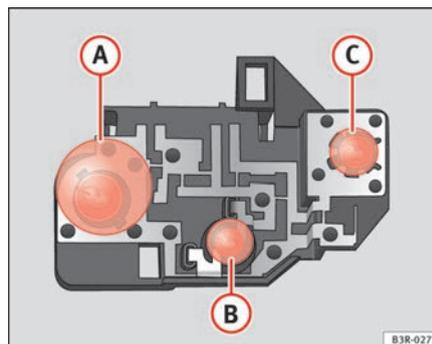
**Fig. 229** Ubicación de las lámparas de incandescencia en el portalámparas. Ejemplo: Luces posteriores en el portón del maletero
