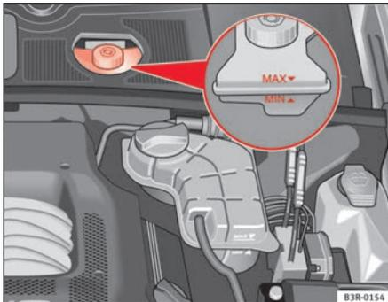
Fig. 181 Compartimento del motor: marcas en el depósito del líquido de frenos
