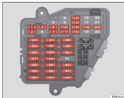
Fig. 197 Ilustración básica del portafusibles en la cubierta delantera izquierda del tablero de instrumentos: Fusibles (sin la tapa de los fusibles)
