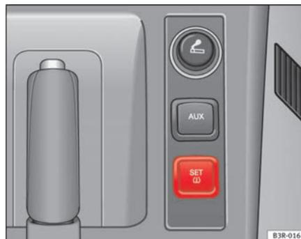
**Fig. 182** Detalle de la consola central: Tecla del indicador de la presión de los neumáticos
