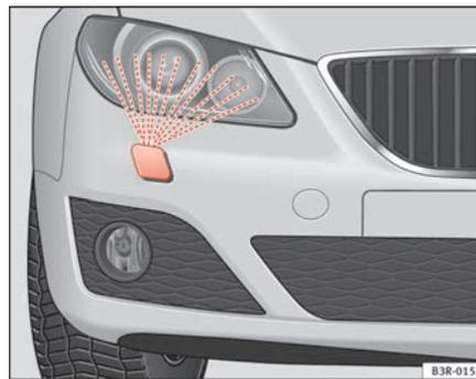
Fig. 103 Faro con eyector de lavado desplegado
