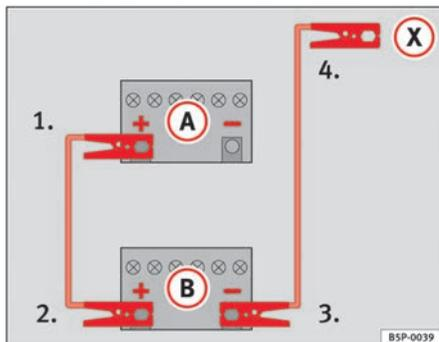
Fig. 237 Esquema de conexión de los cables de emergencia
