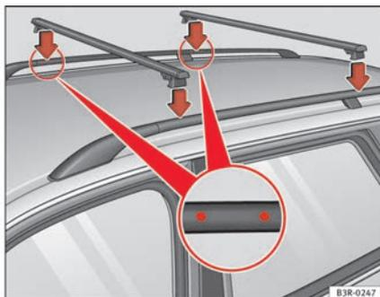
Fig. 130 Puntos de fijación de los soportes transversales
