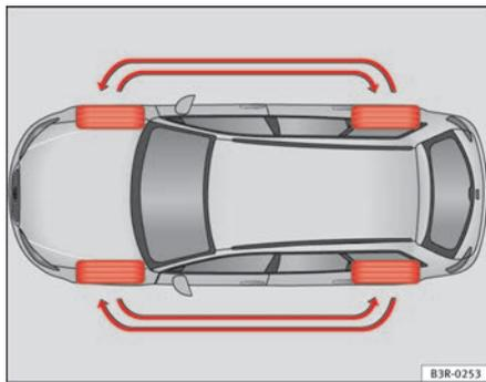
**Fig. 184** Esquema para el cambio de ruedas
