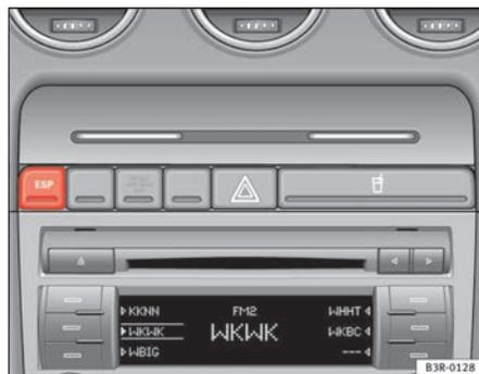
**Fig. 154** Consola central con el interruptor del ESP
