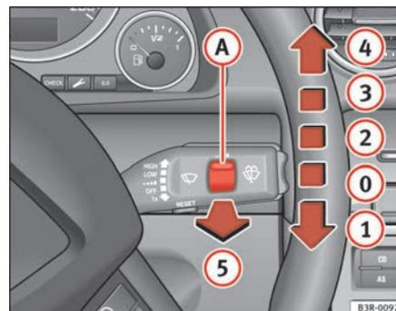
Fig. 101 Palanca del limpiaparabrisas
