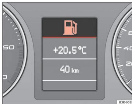
Fig. 55 Pantalla: Nivel de combustible bajo
