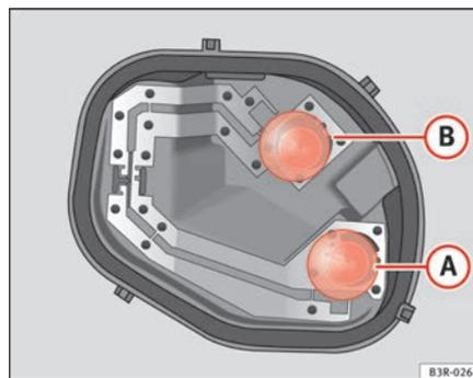
Fig. 222 Ubicación de las lámparas de incandescencia en el portalámparas: Ejemplo: Unidad de luz trasera izquierda exterior.
