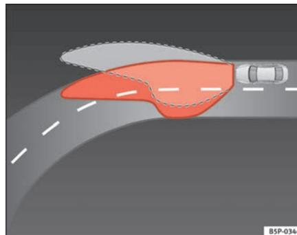
Fig. 91 Faros autodireccionables al conducir
