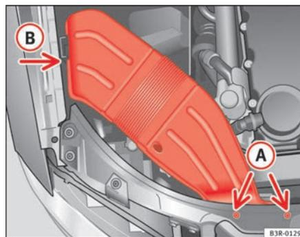
Fig. 211 Conducción de ventilación en el lado derecho del vehículo
