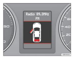
Fig. 51 Display: door catch/tailgate warning
