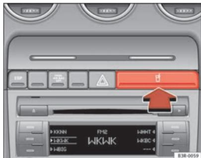
Fig. 131 Detalle del tablero de instrumentos: Portabebidas
