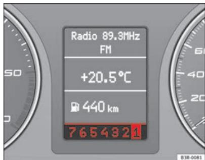
Fig. 158 Pantalla: Cambiar las marchas manualmente (modo tiptronic)
