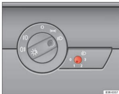
**Fig. 89** Regulación del alcance de las luces
