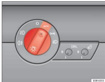
Fig. 86 Detalle del tablero de instrumentos: Conmutador de las luces
