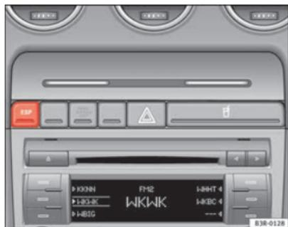
Fig. 146 Detalle de la consola central: tecla ESP
