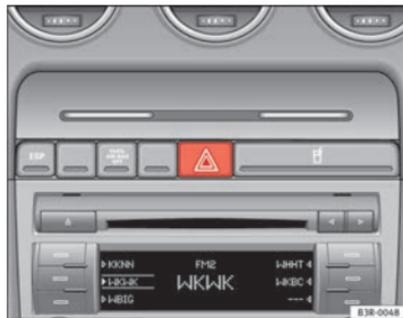
**Fig. 92 Consola central: Interruptor para intermitentes simultáneos de emergencia**
