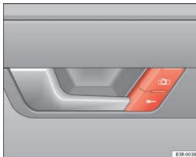
**Fig. 71** Detalle de la puerta del conductor: Conmutador del cierre centralizado
