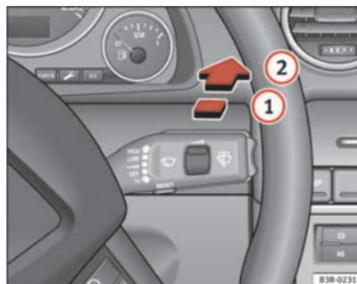
**Fig. 102** Palanca del limpiaparabrisas
