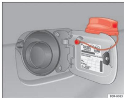
Fig. 174 Tapa del depósito con el tapón encajado
