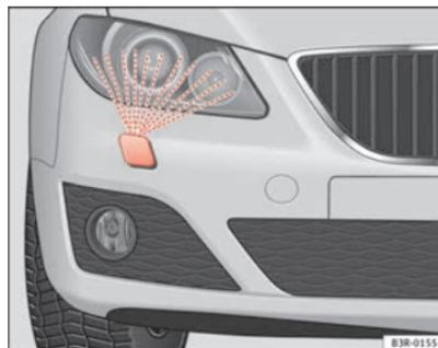
Fig. 103 Faro con inyector de lavado desplegado
