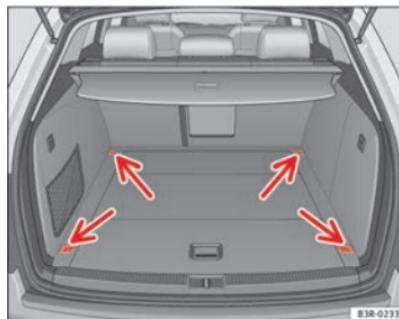
**Fig. 117** Disposición de las argollas de amarre en el maletero
