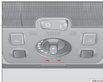
**Fig. 95** Detalle del revestimiento del techo: Iluminación ambiental
