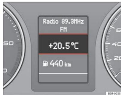
Fig. 49 Pantalla: Indicador de temperatura exterior
