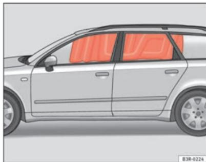
Fig. 26 Airbags para la cabeza inflados
