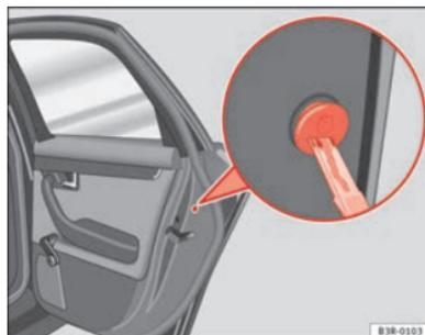
Fig. 72 Dispositivo de bloqueo de emergencia
