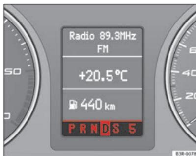
Fig. 155 Pantalla: Posiciones de la palanca selectora
