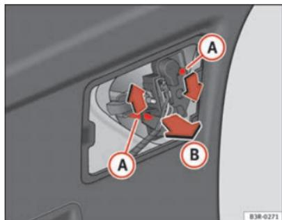
Fig. 235 Desmontar el portalámparas
