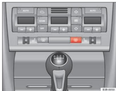
Fig. 98 Interruptor para luneta térmica
