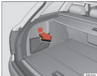
Fig. 126 Maletero: Recubrimiento lateral con compartimento cerrado
