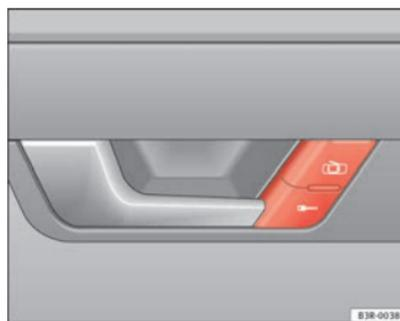
Abb. 71 Ausschnitt aus der Fahrertür: Zentralverriegelungsschalter
