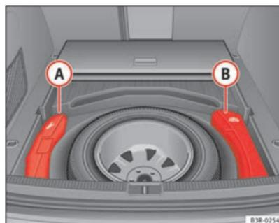
Abb. 190 Werkzeugbox und Wagenheber
