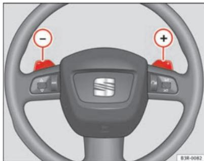
Abb. 159 Lenkrad: tiptronic-Schalter
