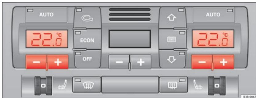
Abb. 141 Bedienelemente der Klimaanlage
