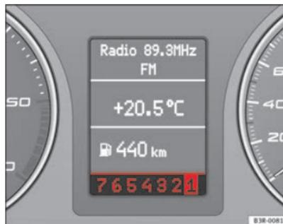
Abb. 158 Display: Manuelles Schalten (tiptronic-Betrieb)
