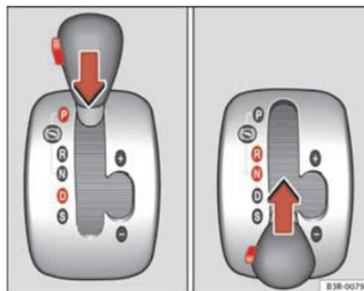
Abb. 156 Wählhebelsperre
