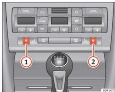
Abb. 144 Ausschnitt aus der Instrumententafel: Rändelräder der Sitzheizung
