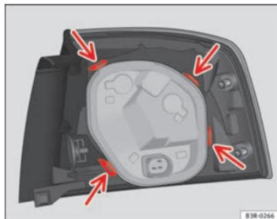
**Abb. 229** Befestigen Sie den Lampenträger an der Heckleuchte
