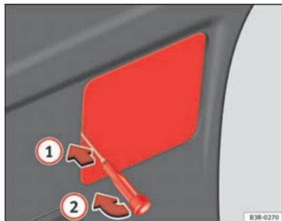
Abb. 234 Abdeckung in der Heckklappenverkleidung entfernen
