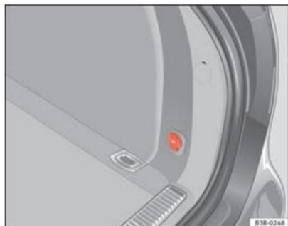
Abb. 136 Ausschnitt aus der Seitenverkleidung des Gepäckraums: 12-Volt-Steckdose
