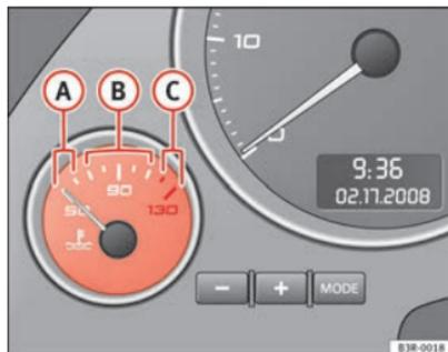
Abb. 38 Motorkühlmitteltemperaturanzeige
