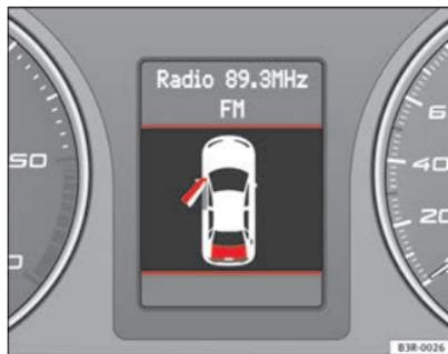
Abb. 51 Display: Tür- und Heckklappenwarnung
