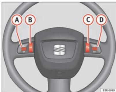
Abb. 64 Bedienelemente am Multifunktionslenkrad
