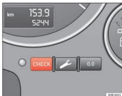
Abb. 53 Kombiinstrument: CHECK-Taste
