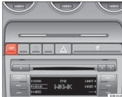
Abb. 146 Ansicht der Mittelkonsole: ESP-Taste ▶
