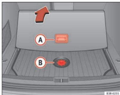
Abb. 189 Zugriff auf Werkzeugbox und Wagenheber
