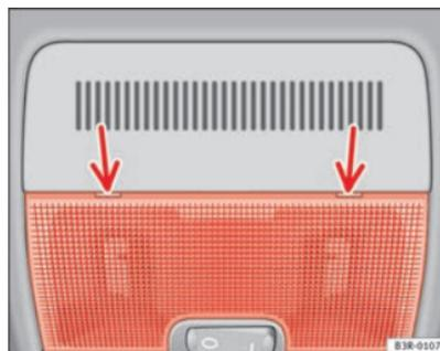
Abb. 83 Ausschnitt aus Dachhimmel: Ansatzpunkt des Schraubendrehers
