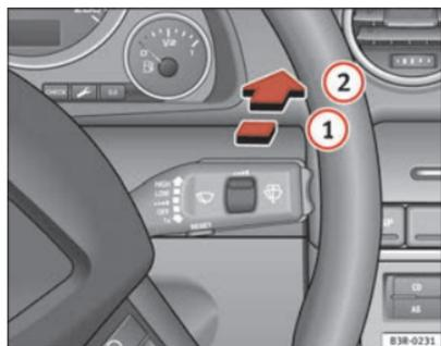
Abb. 102 Scheibenwischerhebel
