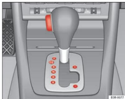
Abb. 154 Ansicht der Mittelkonsole: Wählhebel mit Sperrtaste
