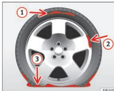
Abb. 198 Reifenschäden für die das Tire-Mobility-System nicht geeignet ist
