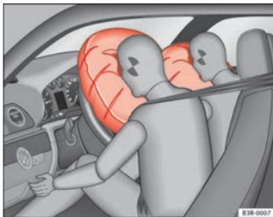
Abb. 19 Aufgeblasene Frontairbags
