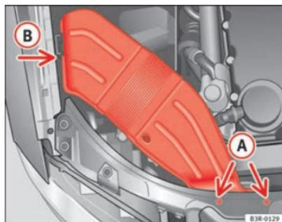
Abb. 215 Luftführungshutze an rechter Fahrzeugseite
