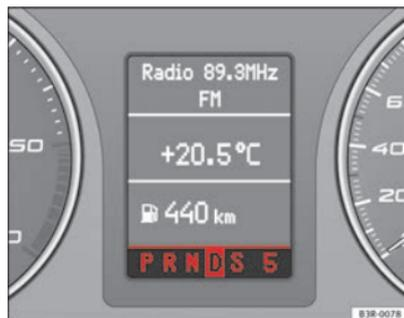
Abb. 155 Display: Wählhebelstellung
