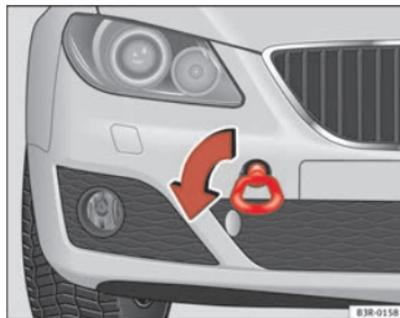
Abb. 246 Einschrauben der Abschleppöse vorne am Fahrzeug
