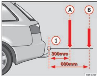
Abb. 161 Prinzipdarstellung der Lastverteilung von Anbauteilen und Zubehör
