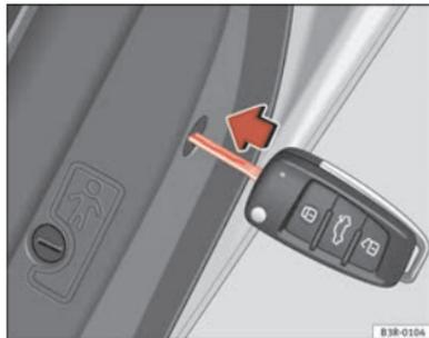
Abb. 73 Notverriegeln
