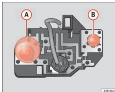
Abb. 237 Position der Glühlampen am Lampenträger. Beispiel: Heckleuchte in der Heckklappe
