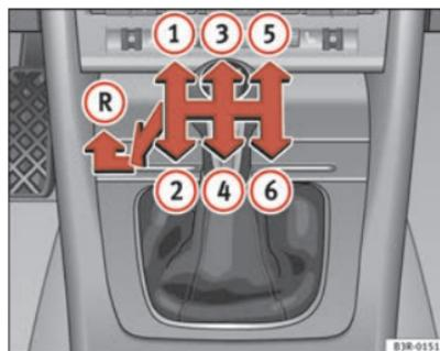
Abb. 153 Ansicht der Mittelkonsole: Schalt-schema eines 6-Gang-Schaltgetriebes
