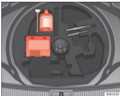
Abb. 191 Reifenreparaturset (Tire-Mobility-System) unter Ladeboden im Gepäckraum
