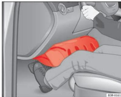
**Abb. 22** Die aufgeblasenen Airbags schützen bei einem Frontaufprall
