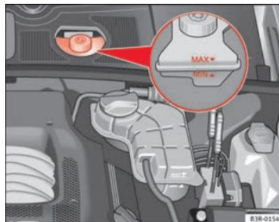
Abb. 185 Motorraum: Markierungen am Bremsflüssigkeitsbehälter
