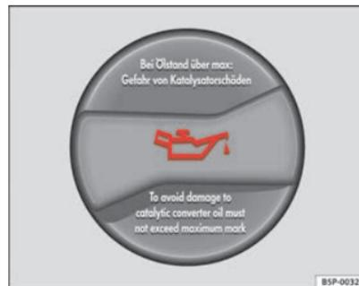
Abb. 178 Deckel der Motoröl-Einfüllöffnung im Motorraum
