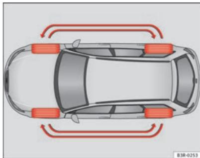
Abb. 188 Schema für das Tauschen der Räder
