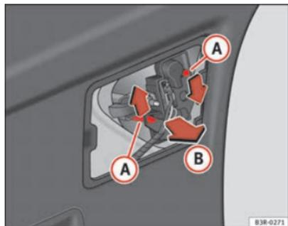
Abb. 235 Lampenträger ausbauen
