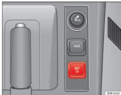
**Abb. 186** Ansicht der Mittelkonsole: Taste für die Reifenkontrollanzeige
