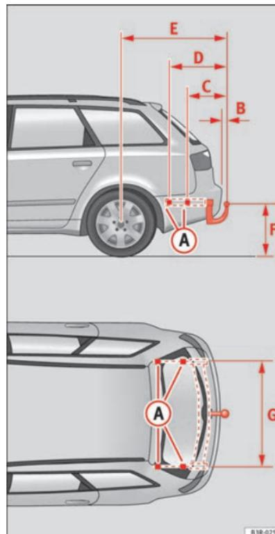
Abb. 172 Befestigungspunkte für die Anhangevorrichtung
