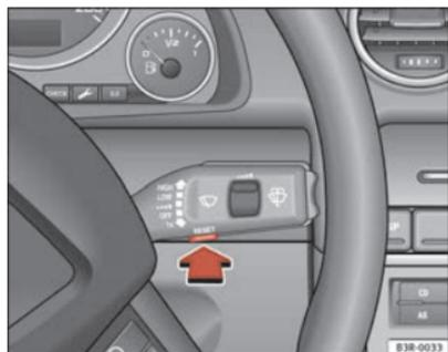
Abb. 61 Scheibenwischerhebel: Bedientaste für Menüwahl
