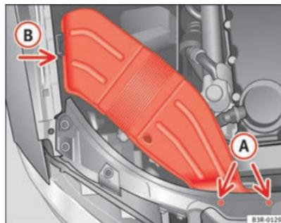
Abb. 203 Luftführungshutze an rechter Fahrzeugseite
