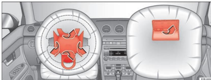
Abb. 20 Airbagabdeckungen bei ausgelösten Frontairbags
