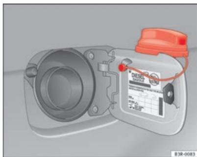
Abb. 174 Tankklappe mit aufgestecktem Tankverschluss
