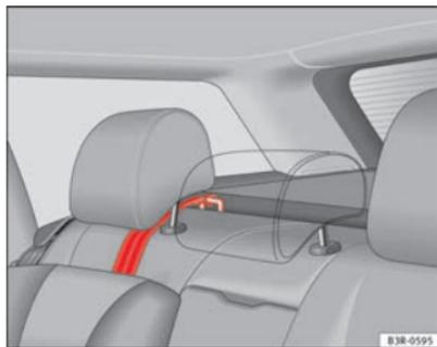
Abb. 35 Befestigungsgurt: korrekte Einstellung und korrekter Einbau
