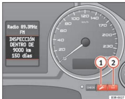
Abb. 52 Ausschnitt aus Kombiinstrument: Service-Intervall-Anzeige
