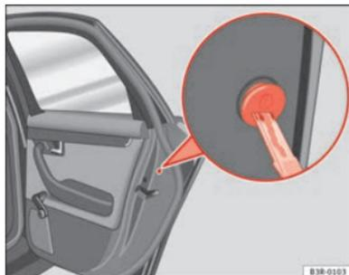
Abb. 72 Notverriegelungsvorrichtung
