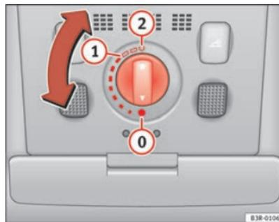
Abb. 82 Ausschnitt aus Dachhimmel: Drehschalter für Schiebe-/Ausstelldach
