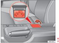
Fig. 137 Centre console: 230 volt socket
