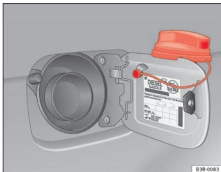
**Fig. 160** Tampa do depósito com o tampão encaixado
