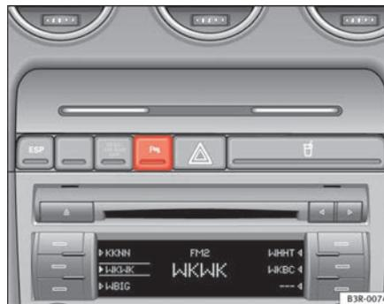
Fig. 142 Consola central: Interruptor do auxílio de estacionamento
