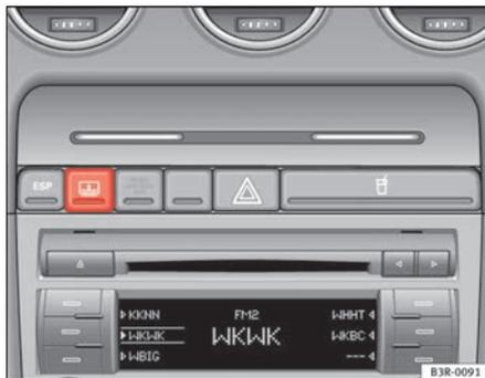
Fig. 99 Tecla para a cortina eléctrica do vidro traseiro
