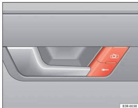
**Fig. 70** Pormenor da porta do condutor: Comutador do fecho centralizado
