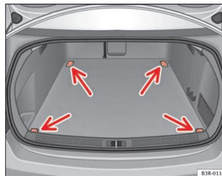
**Fig. 115** Disposição das argolas de fixação na bagageira
