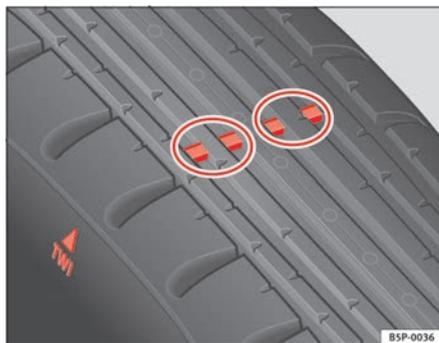
**Fig. 173** Indicadores de desgaste no perfil do pneu
