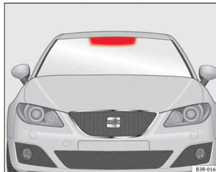
Fig. 159 Área de colocação do identificador de teleportagem
