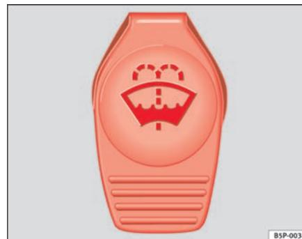
**Fig. 168** Tampão do reservatório do limpa-vidros no compartimento do motor.
