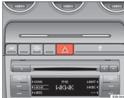
Fig. 90 Consola central: Interruptor para as luzes simultâneas de emergência
