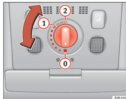
Fig. 80 Pormenor do revestimento do tecto: Comando giratório do tecto de abrir/deflector
