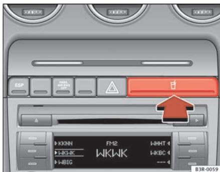
Fig. 123 Pormenor do painel de instrumentos: Suporte de bebidas
