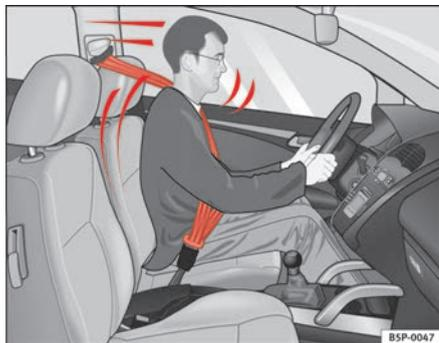
**Fig. 10** Condutor com o cinto de segurança correctamente colocado: é retido pelo mesmo numa travagem brusca
