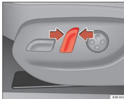
**Fig. 107 Banco dianteiro: Comando da inclinação do encosto**
