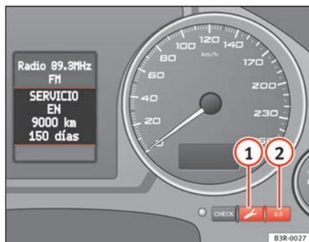
**Fig. 51 Pormenor do painel de instrumentos: Indicação dos intervalos de serviço**
