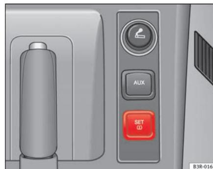
**Fig. 172** Pormenor da consola central: Botão do indicador da pressão dos pneus
