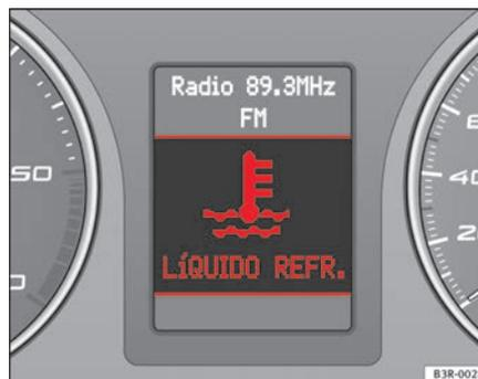
Fig. 53 Visor: Aviso do nível do líquido de refrigeração
