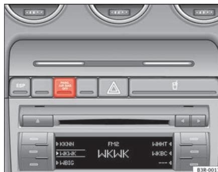
Fig. 28 Luz avisadora da desactivação do airbag do acompanhante
