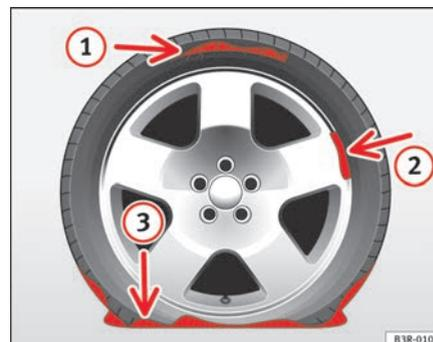
**Fig. 183** Furos nos pneus que não podem ser solucionados com o Tire Mobility System
