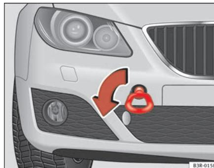
Fig. 226 Enroscamento da argola de reboque na parte dianteira do veículo
