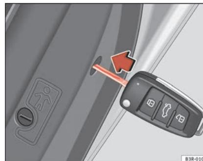
Fig. 72 Activar a trancagem de emergência
