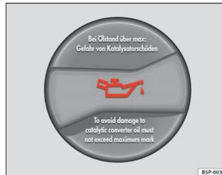
Fig. 166 Tampão do bocal de enchimento do óleo do motor no compartimento do motor
