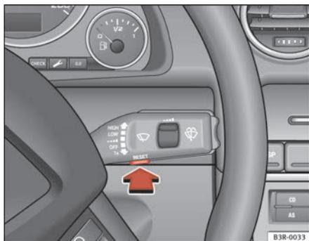
Fig. 60 Alavanca do limpador pára-brisas: Teclas de comando para seleccionar menus
