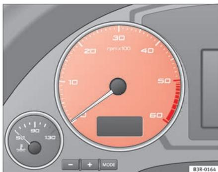
**Fig. 39** Pormenor do painel de instrumentos. Conta-rotações
