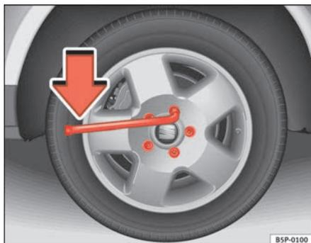
Fig. 178 Changement de roue : Desserrez les boulons de roue
