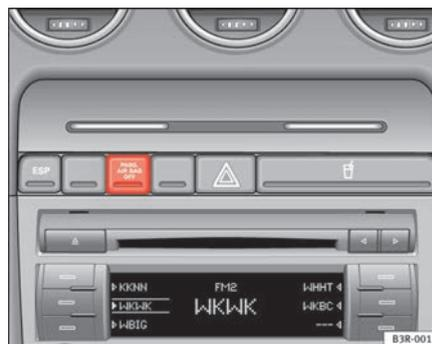
Fig. 28 Témoin de désactivation de l'airbag du passager
