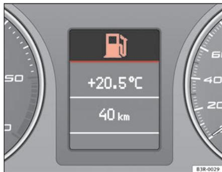
Fig. 54 Afficheur : niveau faible de carburant
