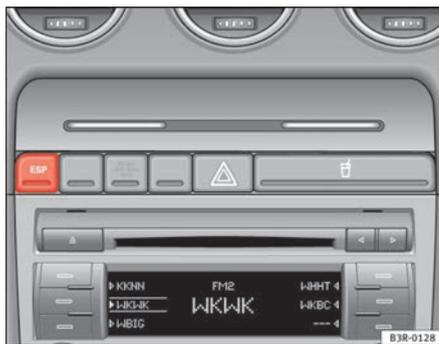
**Fig. 146** Console centrale avec commande du contrôle électronique de la stabilité.
