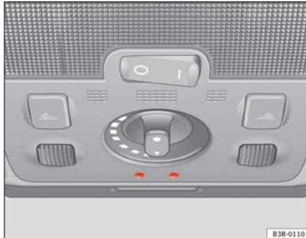
**Fig. 93** Détail du ciel de pavillon : Éclairage d'ambiance
