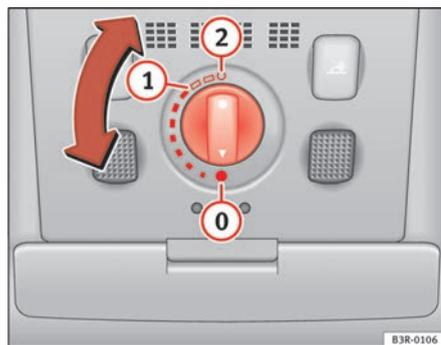
Fig. 80 Détail du ciel de pavillon : commande rotative du toit ouvrant coulissant/relevable
