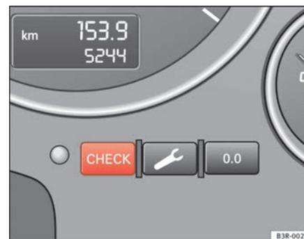
Fig. 52 Tableau de bord : Touche de contrôle CHECK
