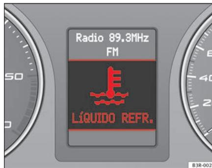
Fig. 53 Afficheur : alerte de niveau de liquide de refroidissement
