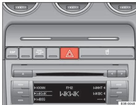
**Fig. 90** Console centrale : commande du signal de détresse
