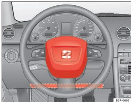
**Fig. 17** Airbag du conducteur sur le volant et airbag genoux dans le tableau de bord
