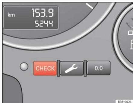
Fig. 43 Détail du combiné d'instruments : Touche de contrôle CHECK
