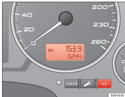
Fig. 42 Détail du combiné d'instruments : Totalisateurs kilométriques
