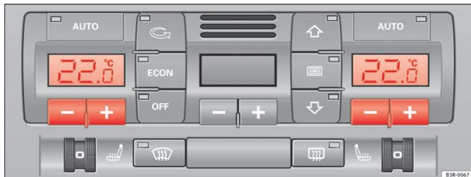
Fig. 133 Éléments de commande de la barre climatiseur
