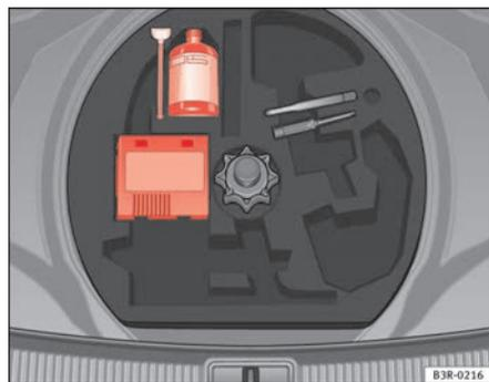
**Fig. 176** Kit antirevaision (Tire Mobility System) logé sous le plancher de chargement dans le coffre à bagages
