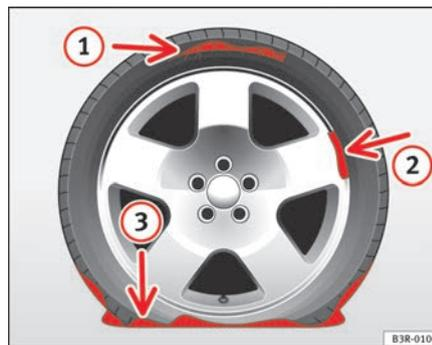
**Fig. 183** Dommages pour lesquels le Tire-Mobility-System ne convient pas.
