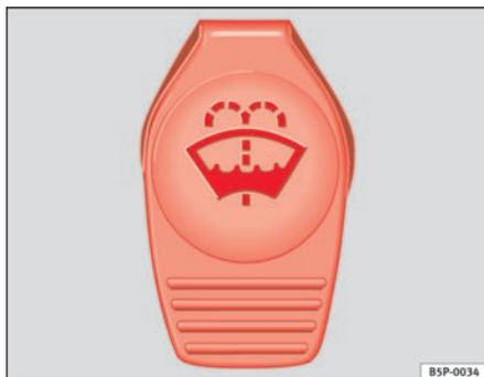
**Fig. 168** Dans le compartiment-moteur : bouchon du réservoir de lave-glace
