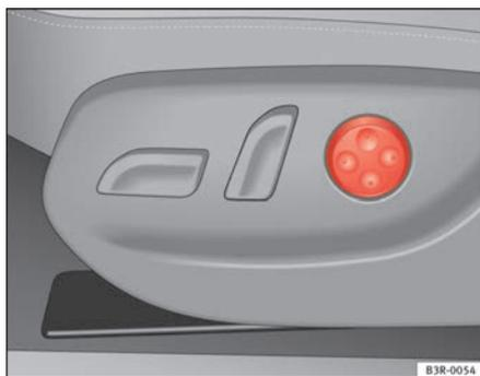
Fig. 108 Siège avant : plaque de réglage de l'appui lombaire
