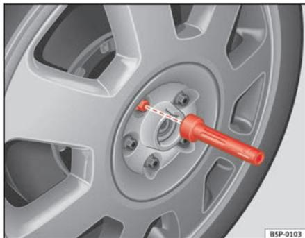
Fig. 181 Changement de roue : Outil à hexagone intérieur pour tourner les vis
