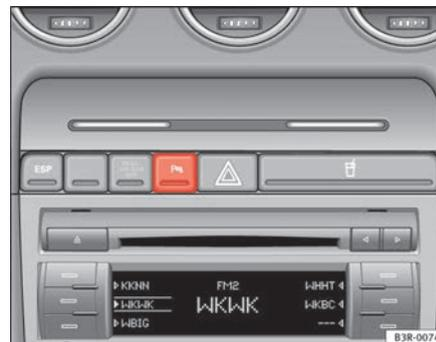
Fig. 142 Console centrale : touche du système d'aide au stationnement
