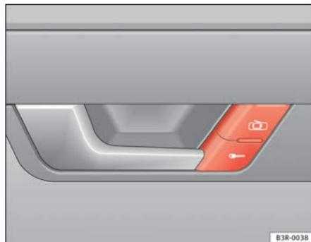
**Fig. 70** Détail de la porte du conducteur : commande de verrouillage centralisé
