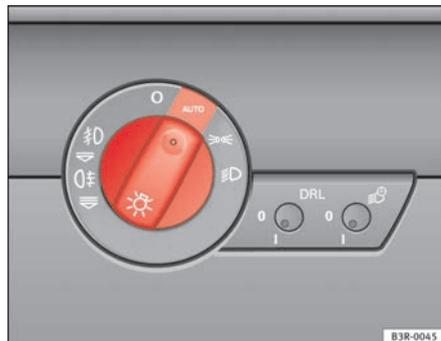
Fig. 84 Détail du tableau de bord : Commande d'éclairage
