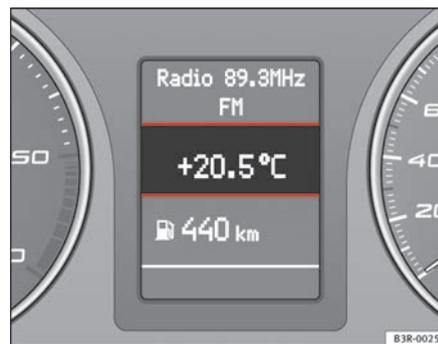
Fig. 49 Afficheur : Indicateur de température extérieure
