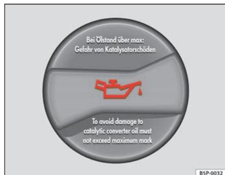
**Fig. 166** Dans le compartiment-moteur : bouchon de l'orifice de remplissage d'huile-moteur
