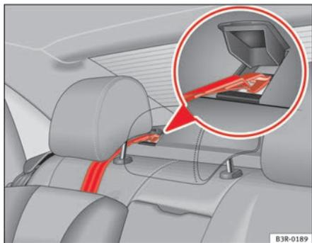
Fig. 35 Sangle de fixation : pose et dépose correcte
