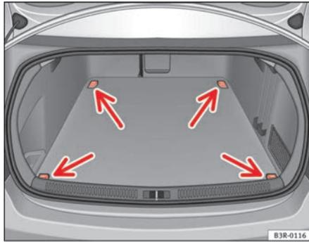
Fig. 115 Emplacements des œillets d'arrimage dans le coffre à bagages
