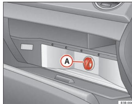
Fig. 130 Boîte à gants avec réfrigérateur ouvert
