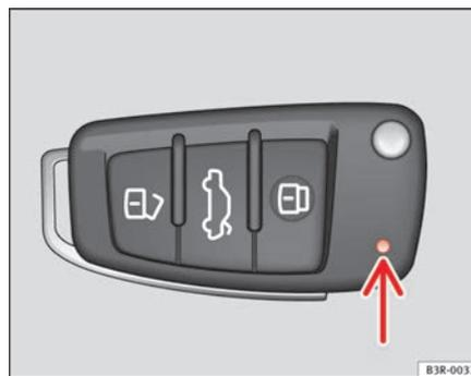
**Fig. 67 Témoin dans la clé à radiocommande**
