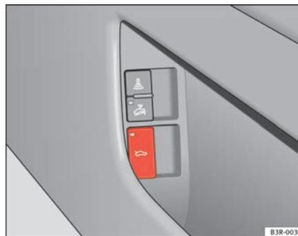
Fig. 73 Porte du conducteur : Déverrouillage du hayon
