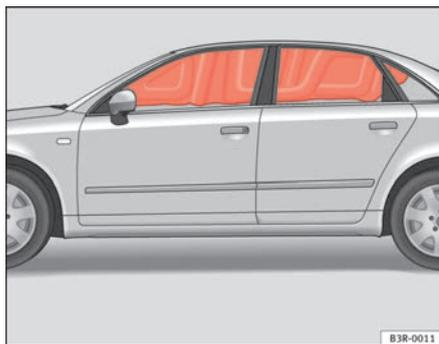
Fig. 26 Schéma de principe : airbags de tête gonflés
