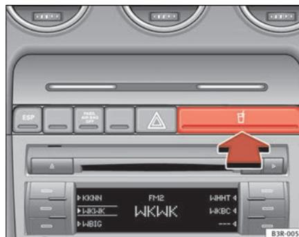
Fig. 123 Détail du tableau de bord : Porte-gobelets
