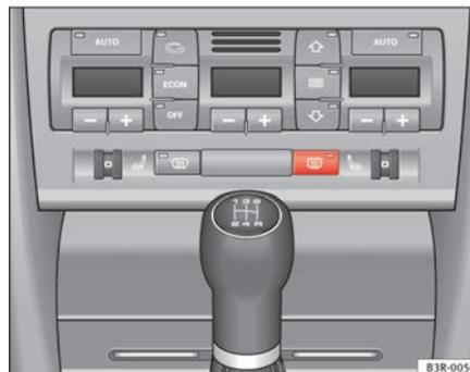
Fig. 96 Commande de dégivrage de lunette arrière
