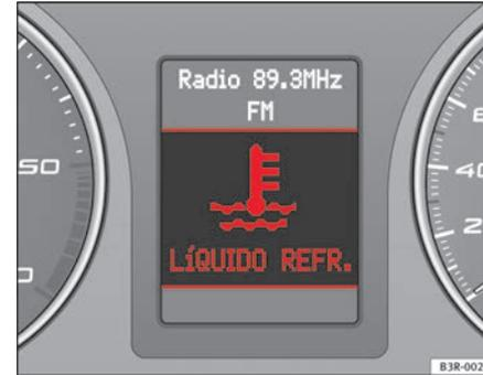
Abb. 53 Display: Kühlwasserstandswarnung
