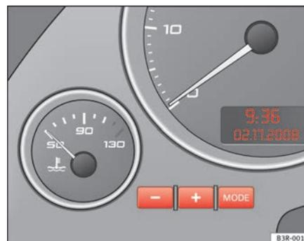
Abb. 40 Ausschnitt aus Kombiinstrument: Digitaluhr
