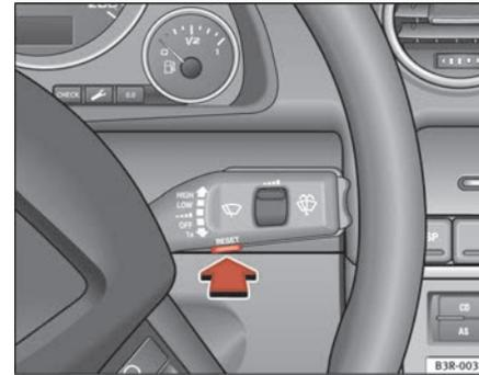
Abb. 60 Scheibenwischerhebel: Bedientaste für Menüwahl
