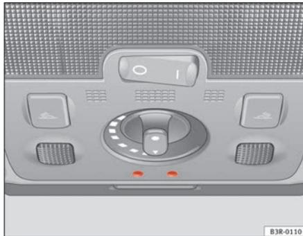
Abb. 93 Ausschnitt aus Dachhimmel: Ambientebeleuchtung
