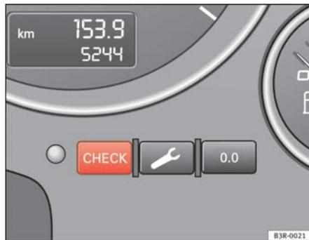
Abb. 43 Ausschnitt aus Kombiinstrument: CHECK-Taste
