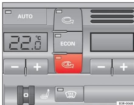
**Abb. 134** Bedientaste für den automatischen Umluftbetrieb
