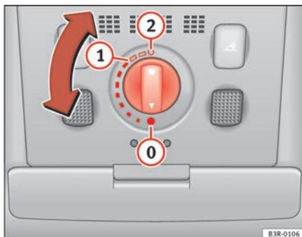
Abb. 80 Ausschnitt aus Dachhimmel: Drehschalter für Schiebe-/Ausstelldach
