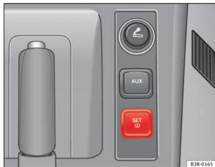
**Abb. 172** In der Mittelkonsole: Taste für die Reifenkontrollanzeige
