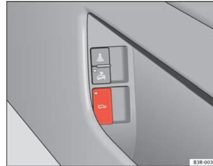
Abb. 73 Fahrertür: Gepäckraumklappe entriegeln
