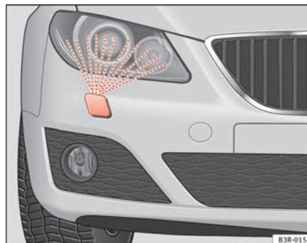
Abb. 101 Scheinwerfer mit ausgefahrener Waschlösung
