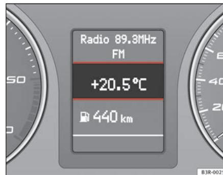
Abb. 49 Display: Außentemperaturanzeige
