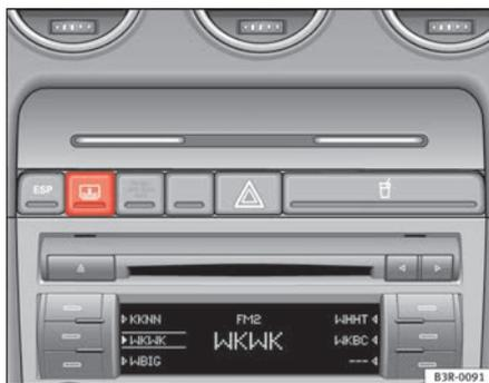
Abb. 99 Taste für elektrisches Heckrollo
