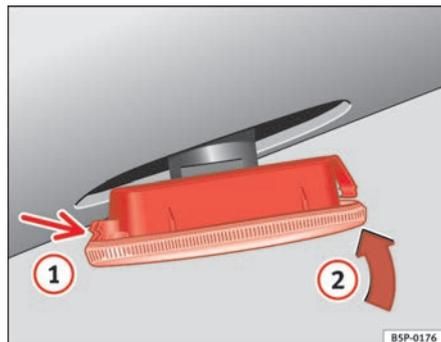
Abb. 218 Seitlicher Blinker
