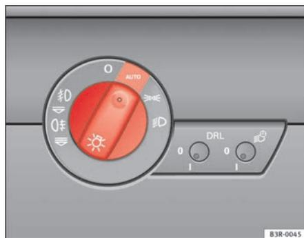
Abb. 84 Ausschnitt aus der Instrumententafel: Lichtschalter
