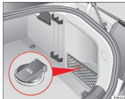
**Abb. 128** Ausschnitt aus der Seitenverkleidung des Gepäckraums: 12-Volt-Steckdose
