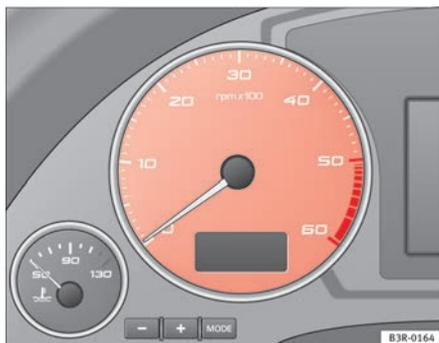
Abb. 39 Ausschnitt aus Kombiinstrument. Drehzahlmesser
