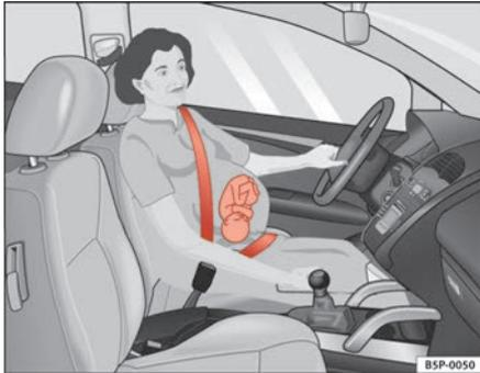
Abb. 14 Gurtbandverlauf bei schwangeren Frauen
