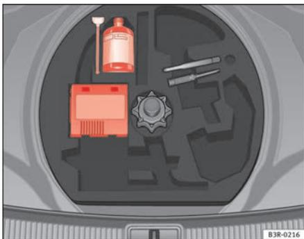
**Abb. 176** Reifenreparaturset (Tire-Mobility-System) unter Ladeboden im Gepäckraum
