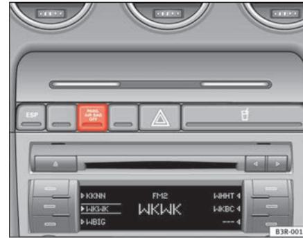
Abb. 28 Kontrollleuchte für Abschaltung der Beifahrerairbags
