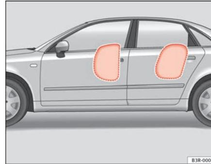
**Abb. 24** Aufgeblasener Seitenairbag auf der linken Fahrzeugseite
