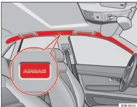
**Abb. 25 Einbauort der Kopfairbags auf der linken Fahrzeugseite**
