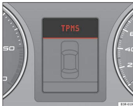
Abb. 45 Display: Systemstörung
