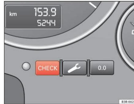
Abb. 56 Ausschnitt aus Kombiinstrument: CHECK-Taste
