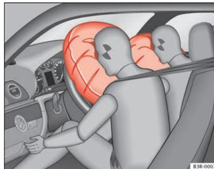
**Abb. 19 Aufgeblasene Frontairbags**
