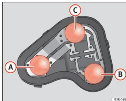
Abb. 211 Position der Glühlampen am Lampenträger: Z.B.: linke Heckleuchte im Seitenteil.
