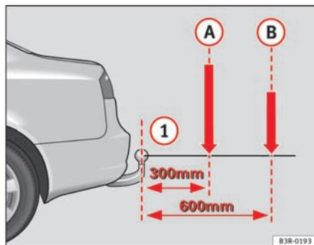
Abb. 147 Prinzipdarstellung der Lastverteilung von Anbauteilen und Zubehör
