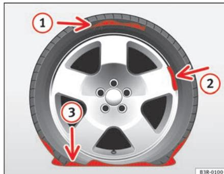
Abb. 183 Reifenschäden für die das Tire-Mobility-System nicht geeignet ist
