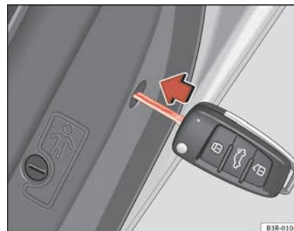
Abb. 72 Notverriegeln ▶
