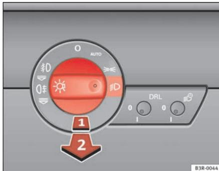
Abb. 83 Ausschnitt aus der Instrumententafel: Lichtschalter
