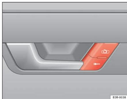
Abb. 70 Ausschnitt aus der Fahrertür: Zentralverriegelungsschalter
