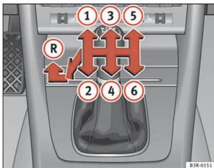
Abb. 145 In der Mittelkonsole: Schaltschema eines 6-Gang-Schaltgetriebes
