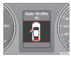
Fig. 50 Display: door catch/tailgate warning
