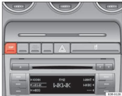
Fig. 151 Console centrale con interruttore ESP
