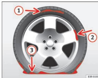
**Fig. 188** Danni per i quali non è possibile l'utilizzo del set Tire Mobility System.
