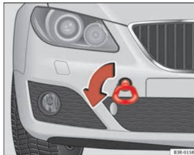
Fig. 231 Lato anteriore del veicolo: montaggio dell'anello per traino
