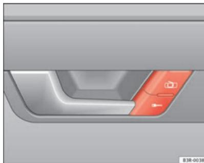
Fig. 71 Dettaglio della porta del conducente: interruttore della chiusura centralizzata
