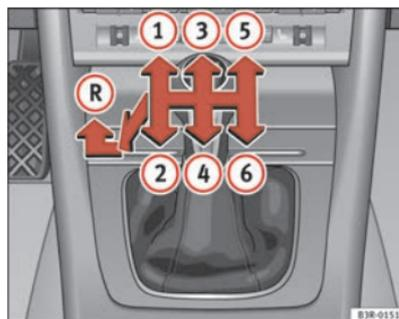
Fig. 144 Dettaglio della console centrale: schema delle marce nel cambio meccanico a 6 rapporti
