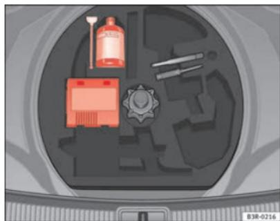
Fig. 181 Kit per la riparazione dei pneumatici (tire mobility system) sotto il piano di carico del bagagliaio
