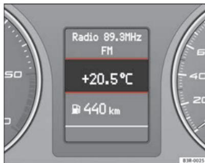
Fig. 49 Display: Indicazione della temperatura esterna
