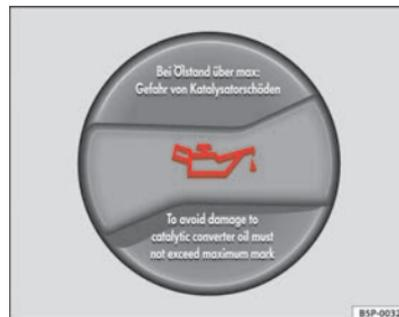
Fig. 171 Vano motore: tappo del bocchettone di rifornimento dell'olio motore
