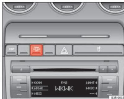
Fig. 28 Spia della disattivazione degli airbag del passeggero anteriore
