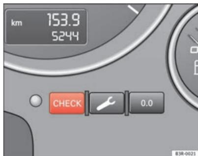
Fig. 53 Quadro strumenti: Tasto CHECK
