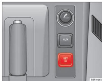
**Fig. 177** Dettaglio della console centrale: Tasto del sistema di controllo della pressione dei pneumatici
