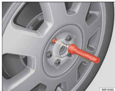
Fig. 186 Cambio di una ruota: utensile ad esagono cavo per svitare le viti
