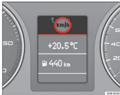
Fig. 56 Display: Controllo automatico della velocità
