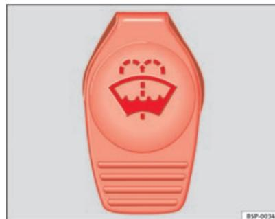
Fig. 173 Vano motore: tappo del serbatoio del liquido lavacrystalli
