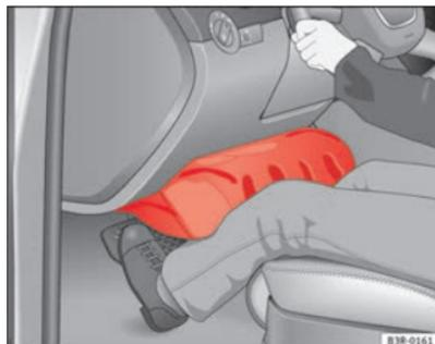
**Fig. 22** Gli airbag gonfiati proteggono in caso di collisione frontale
