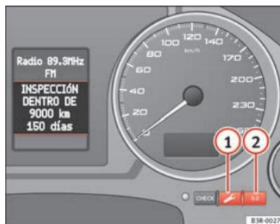
Fig. 52 Dettaglio del quadro strumenti: Indicatore di intervalli di Service
