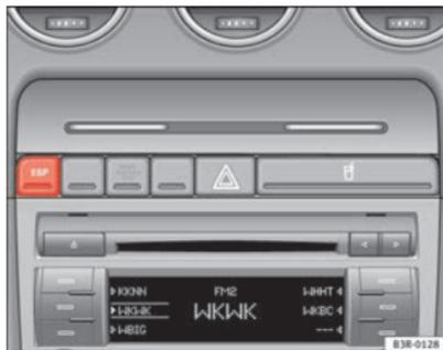
Fig. 137 Dettaglio della console centrale: tasto ESP
