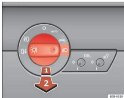
Fig. 84 Dettaglio della plancia portastrumenti: Interruttore luci
