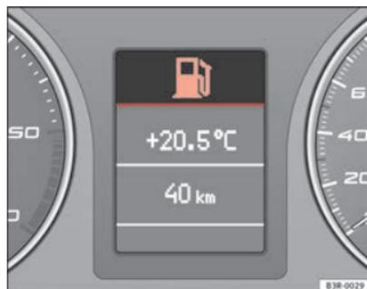
Fig. 55 Display: Livello carburante basso
