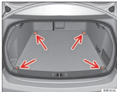
Fig. 116 Posizione degli occhielli di ancoraggio nel bagagliaio.
