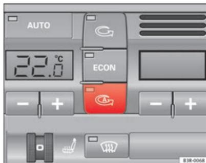
Fig. 133 Tasto del ricircolo aria automatico
