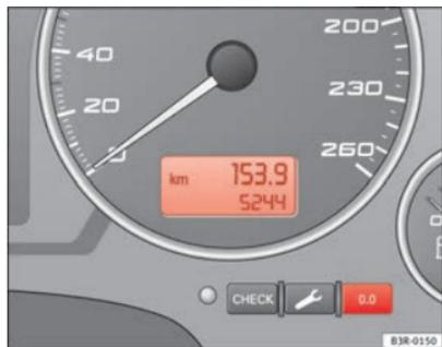
Fig. 42 Dettaglio del quadro strumenti: Contachilometri
