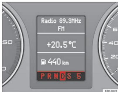
Fig. 146 Display: Posizioni della leva selettoria
