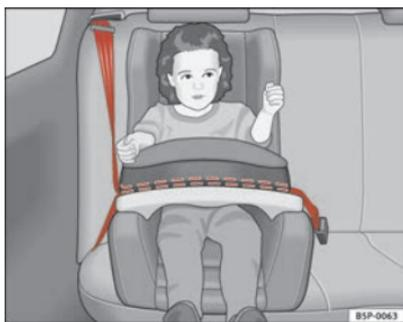
Fig. 30 Seggiolino del gruppo 1 montato sul sedile posteriore; il bambino siede rivolto verso il senso di marcia
