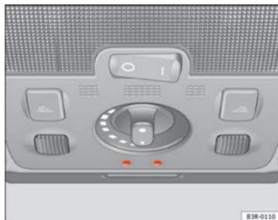
Fig. 94 Dettaglio del rivestimento del tetto: Illuminazione della console centrale
