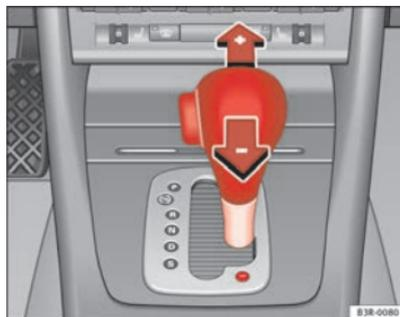
Fig. 148 Console centrale: Cambio marce manuale (modalità tiptronic)
