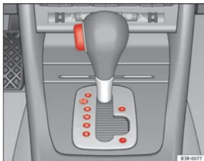
Fig. 145 Dettaglio della console centrale: Leva selettoria con tasto di sbloccaggio
