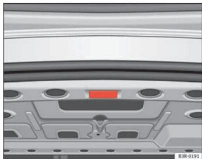
**Fig. 96** Particolare sul lato superiore del bagagliaio Illuminazione del bagagliaio
