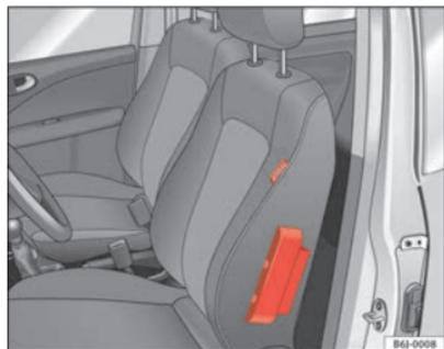
**Fig. 23** Airbag laterale all'interno del sedile del conducente
