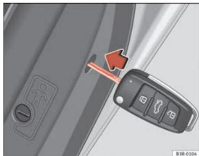
**Fig. 73** Bloccaggio di emergenza
