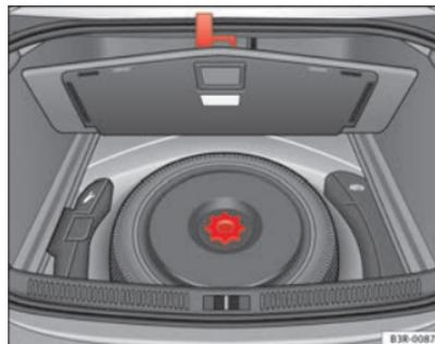
Fig. 182 Ruota di scorta con cerchio in acciaio
