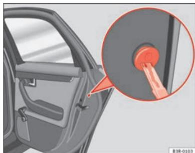
**Fig. 72** Dispositivo per il bloccaggio di emergenza
