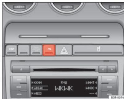
Fig. 141 Console centrale: interruttore del sistema di assistenza per il parcheggio ▶
