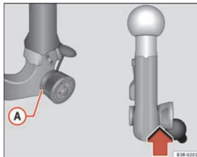
Fig. 157 Dispositivo de reboque desmontável: Controle de segurança
