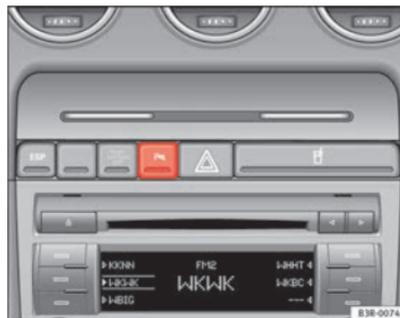
**Fig. 139** Consola central: Interruptor de auxílio de estacionamento ▶
