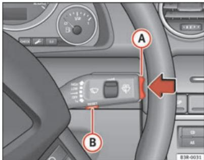
Fig. 63 Manípulo do limpador pára-brisas: Tecla Reset e selector
