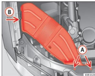
Fig. 189 Condutas de ventilação no lado direito do veículo
