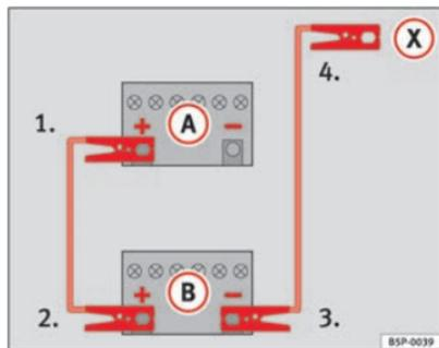
Fig. 230 Esquema de ligação dos cabos auxiliares do arranque
