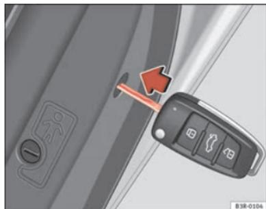
**Fig. 73** Activar a trancagem de emergência
