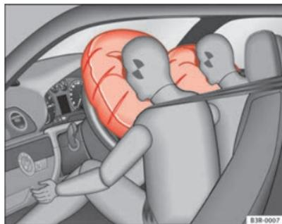
Fig. 19 Airbags frontais insuflados
