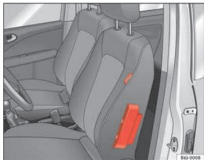
**Fig. 23** Airbag lateral no banco do condutor
