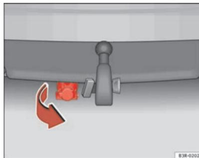
Fig. 158 Pára-choques traseiro: Rodar para baixo a tomada de corrente para o reboque
