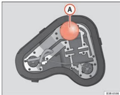
Fig. 214 Localização da lâmpada de incandescência no porta-lâmpadas. Exemplo: Farol traseiro esquerdo na lateral.
