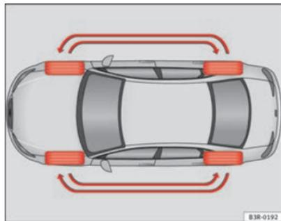
**Fig. 175** Esquema de troca dos pneus
