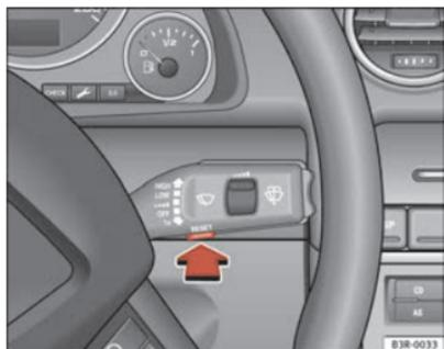
Fig. 61 Manípulo do limpador pára-brisas: Teclas de comando para seleccionar menus
