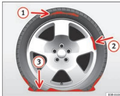
**Fig. 184** Furos nos pneus que não podem ser solucionados com o Tire Mobility System
