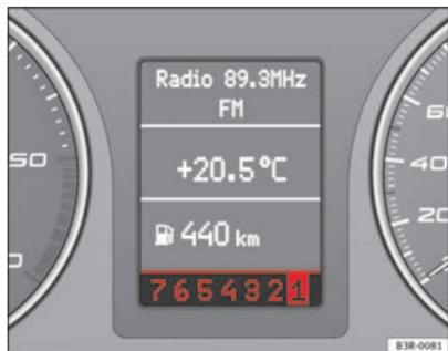
**Fig. 147** Visor: Escolher as mudanças manualmente (modo tiptronic)
