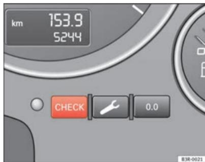
Fig. 53 Painel de instrumentos: Tecla CHECK
