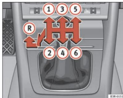
Fig. 142 Pormenor da consola central: esquema de uma caixa de velocidades manual de 6 velocidades
