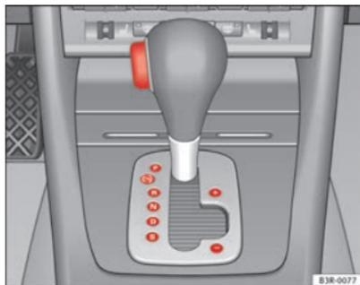
Fig. 143 Pormenor da consola central: Alavanca selectora com botão de bloqueio
