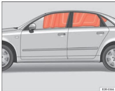
Fig. 26 Airbags da cabeça activados
