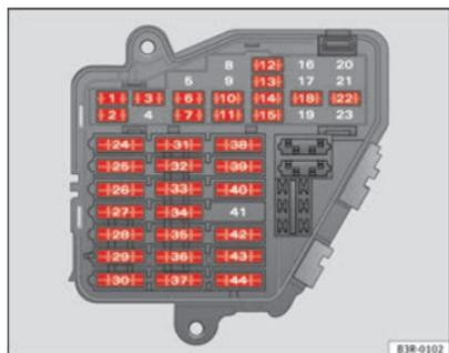
Fig. 187 Ilustração básica do porta-fusíveis na cobertura dianteira esquerda do painel de instrumentos: Fusíveis (sem a tampa dos fusíveis)
