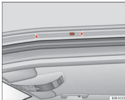
Fig. 119 Pontos de fixação dos suportes básicos
