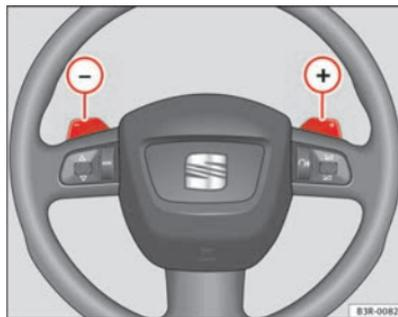
Fig. 148 Volante: Comandos do tiptronic
