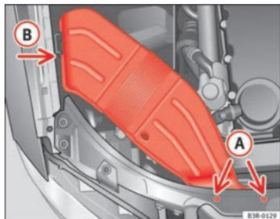
Fig. 201 Condutas de ventilação no lado direito do veículo
