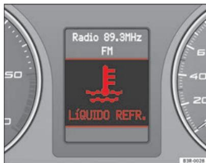
Fig. 54 Visor: Aviso do nível do líquido de refrigeração
