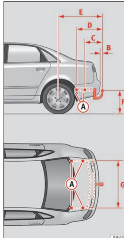
Fig. 161 Pontos de fixação do dispositivo de reboque
