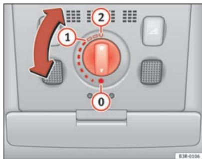
Fig. 81 Pormenor do revestimento do tecto: Comando giratório do tecto de abrir/deflector
