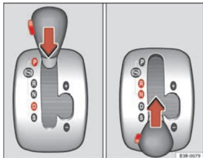
Fig. 145 Bloqueio da alavanca selectora
