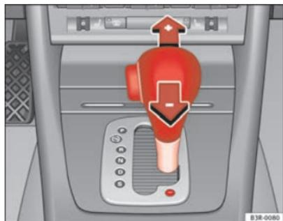
**Fig. 146** Consola central: Escolher as mudanças manualmente (modo tiptronic)
