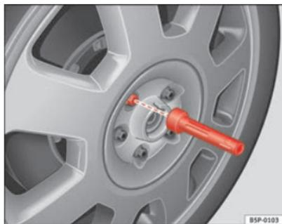
Fig. 182 Substituição de pneu: Ferramenta com sextavado interior para rodar os parafusos
