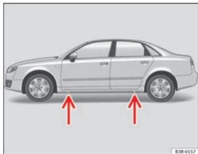
Fig. 180 Substituição de pneu: Pontos de recepção do macaco
