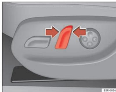
Fig. 108 Banco dianteiro: Comando da inclinação do encosto
