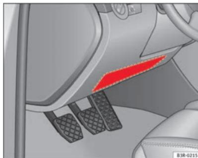
Fig. 21 Airbag de joelhos do condutor
