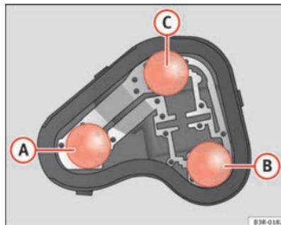
Fig. 213 Localização das lâmpadas de incandescência no porta-lâmpadas. Exemplo: Farol traseiro esquerdo na lateral.
