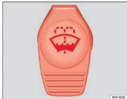
**Fig. 169** Tampa do reservatório do limpa-vidros no compartimento do motor.
