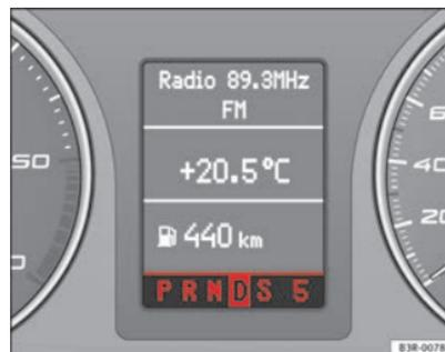
Fig. 144 Visor: Posições da alavanca selectora
