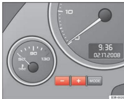
**Fig. 87 Iluminação dos instrumentos**
