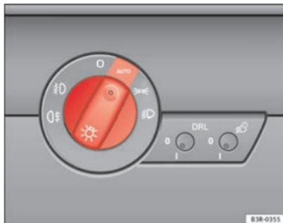
Fig. 85 Dettaglio della plancia portastrumenti: Interruttore luci
