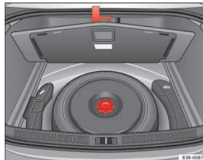
Fig. 178 Ruota di scorta con cerchio in acciaio
