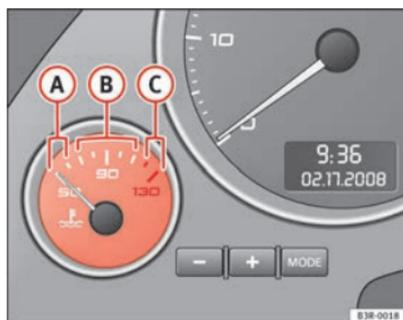
Fig. 38 Indicatore della temperatura del liquido di raffreddamento
