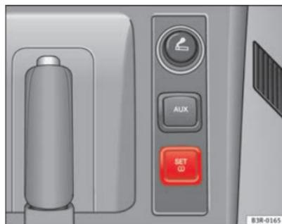
**Fig. 173** Dettaglio della console centrale: Tasto del sistema di controllo della pressione dei pneumatici
