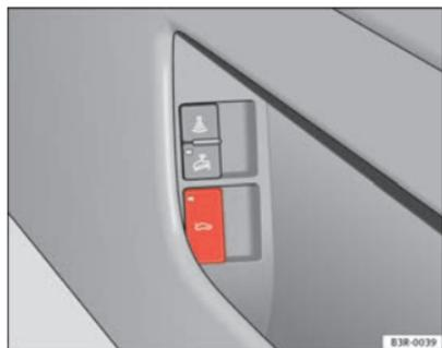
Fig. 74 Porta del conducente: sbloccaggio del cofano del bagagliaio
