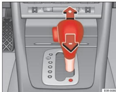
Fig. 146 Console centrale: Cambio marce manuale (modalità tiptronic)
