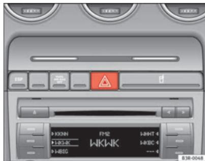
Fig. 91 Console centrale: Interruttore del lampeggio di emergenza
