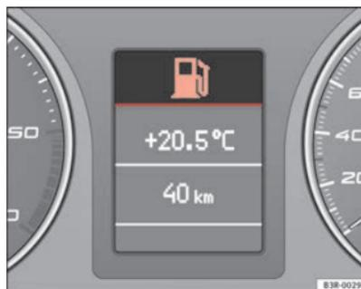
Fig. 55 Display: Livello carburante basso
