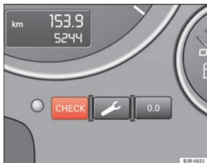
Fig. 57 Dettaglio del quadro strumenti: Tasto CHECK
