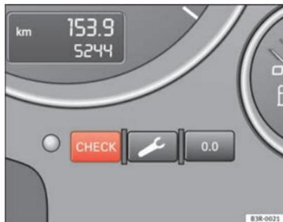
Fig. 43 Dettaglio del quadro strumenti: Tasto CHECK
