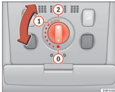
Fig. 81 Dettaglio del rivestimento del tetto: Interruttore a manopola del tettuccio
