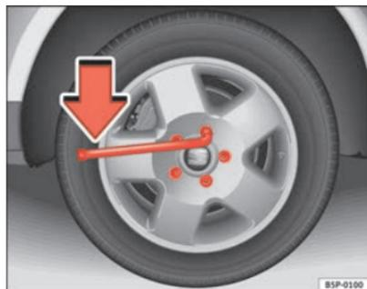
Fig. 179 Cambio di una ruota: Allentare i bulloni della ruota.
