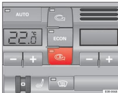
Fig. 131 Tasto del ricircolo aria automatico
