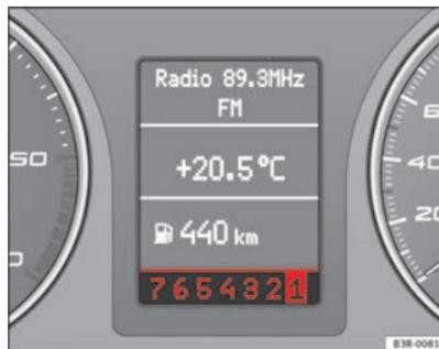
Fig. 147 Display: Cambio marce manuale (modalità tiptronic)
