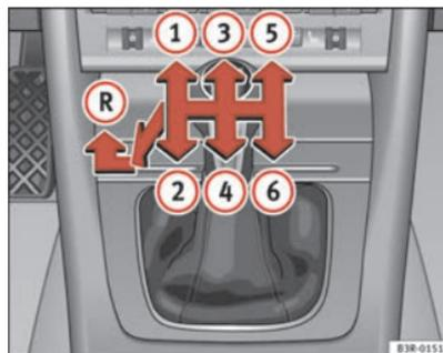
Fig. 142 Dettaglio della console centrale: schema delle marce nel cambio manuale a 6 rapporti
