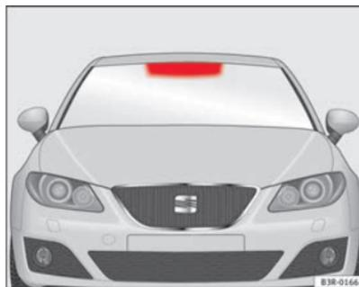
**Fig. 162** Posizione della ricetrasmittente telepass
