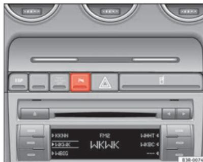
Fig. 139 Console centrale: interruttore del sistema di assistenza per il parcheggio ▶
