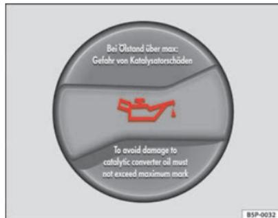
**Fig. 167 Vano motore: tappo del bocchettone di rifornimento dell'olio motore**
