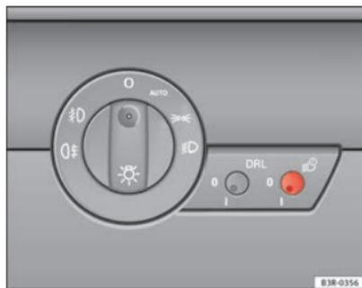
Fig. 86 Dettaglio della plancia portastrumenti: Interruttore coming / leaving home
