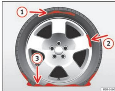
**Fig. 184** Danni per i quali non è possibile l'utilizzo del set Tire Mobility System.
