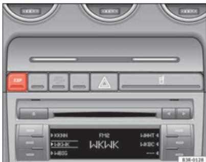
Fig. 135 Dettaglio della console centrale: tasto ESP
