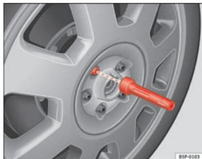
Fig. 182 Cambio di una ruota: utensile ad esagono cavo per svitare le viti
