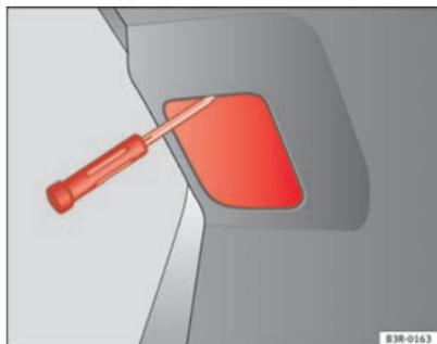
Fig. 219 Retrait du cache sur le capot de coffre
