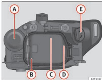
Fig. 190 Ampoules du projecteur halogène
