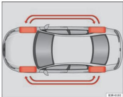
Fig. 175 Schéma de permutation des roues
