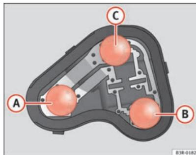
Fig. 213 Emplacement des ampoules sur le support d'ampoules. Exemple : Feu arrière gauche sur l'aile.
