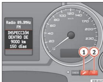
Fig. 52 Détail du tableau de bord : Indicateur de périodicité d'entretien
