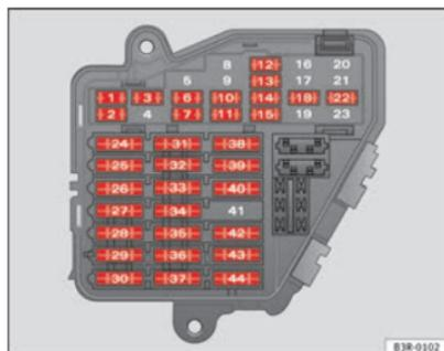
Fig. 187 Représentation schématique du porte-fusibles, sur la face gauche de la planche de bord : fusibles (sans couvercle)
