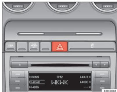
Fig. 91 Console centrale : commande des feux de détresse
