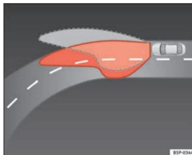
Fig. 90 Projecteurs autodirectionnels lors de la conduite
