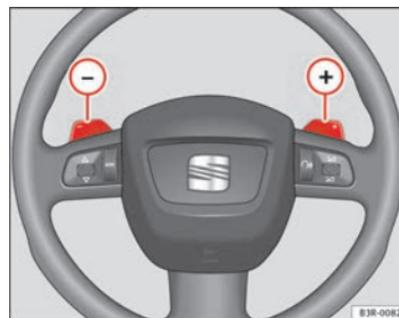
Fig. 148 Volant de direction : touches de commande tiptronic
