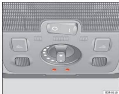
**Fig. 94** Détail du ciel de pavillon : Éclairage d'ambiance
