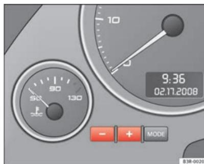
**Fig. 41 Éclairage des cadrans**
