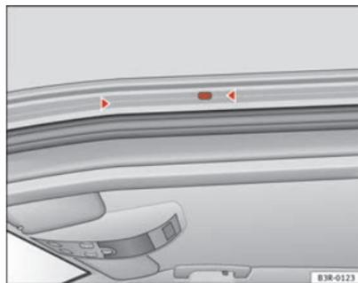
Fig. 119 Points de fixation des supports de base
