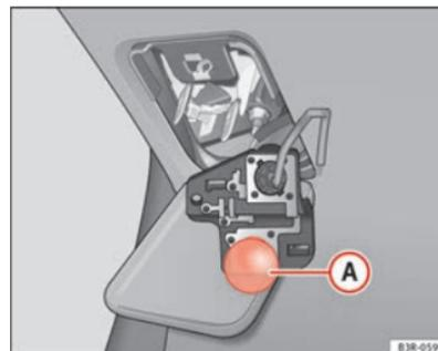
Fig. 222 Emplacement de l'ampoule sur le support d'ampoule. Exemple : Feux arrière sur le hayon
