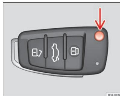
Fig. 67 Clé à radiocommande : Bouton de déverrouillage
