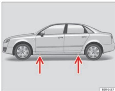
Fig. 180 Changement de roue : points d'appui du cric
