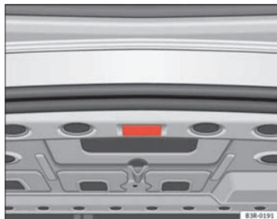
**Fig. 96** Vue partielle de la partie supérieure du coffre à bagages : Éclairage du coffre à bagages
