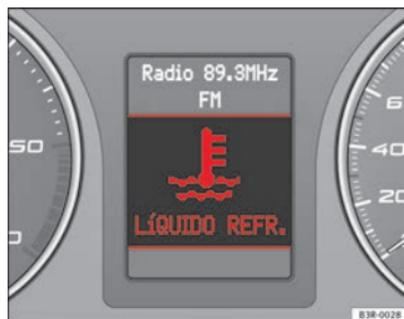
Fig. 54 Afficheur : alerte de niveau de liquide de refroidissement
