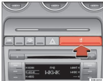
Fig. 120 Détail de la planche de bord : Porte-boissons
