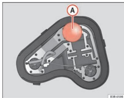
Fig. 214 Emplacement de l'ampoule sur le support d'ampoule. Exemple : Feu arrière gauche sur l'aile.
