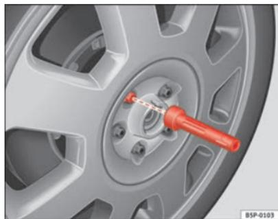
**Fig. 182** Changement de roue : outil à six pans intérieur pour serrer/desserrer les vis
