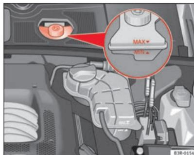
**Fig. 172** Compartiment-moteur : repères sur le réservoir de liquide de frein
