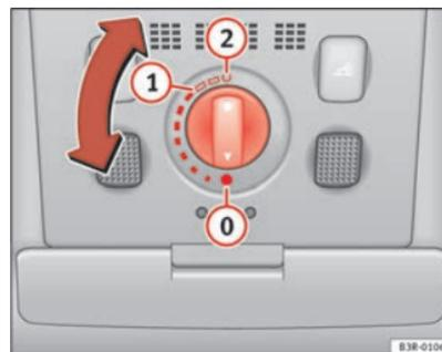
Fig. 81 Détail du ciel de pavillon : commande rotative du toit ouvrant coulissant/relevable
