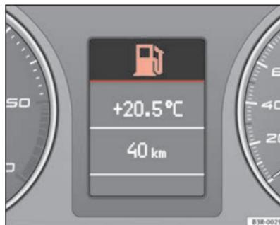
Fig. 55 Afficheur : niveau faible de carburant
