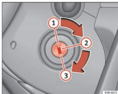
Fig. 136 Positions de la clé de contact
