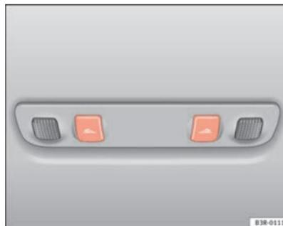
**Fig. 95** Détail du ciel de pavillon : les lampes de lecture arrière
