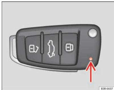
Fig. 68 Témoin de la clé à radiocommande
