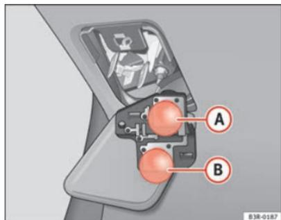
Fig. 221 Emplacement des ampoules sur le support d'ampoules. Exemple : Feux arrière sur le hayon
