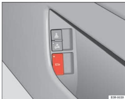
Fig. 74 Porte du conducteur : Déverrouillage du hayon
