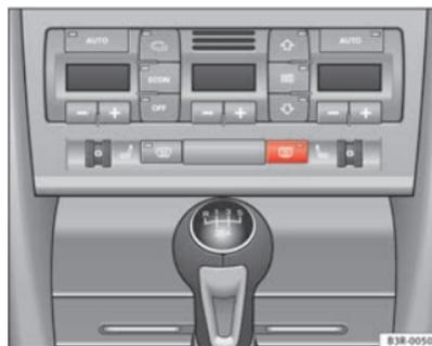
**Fig. 97** Commande de dégivrage de lunette arrière
