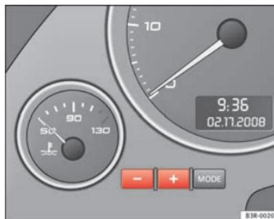
Fig. 87 Éclairage des cadrans
