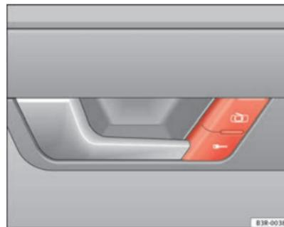
**Fig. 71** Détail de la porte du conducteur : commande de verrouillage centralisé
