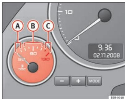
Fig. 38 Indicateur de température de liquide de refroidissement du moteur
