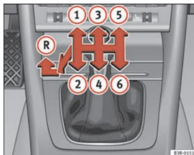
Fig. 142 Détail de la console centrale : schéma d'une boîte mécanique 6 vitesses
