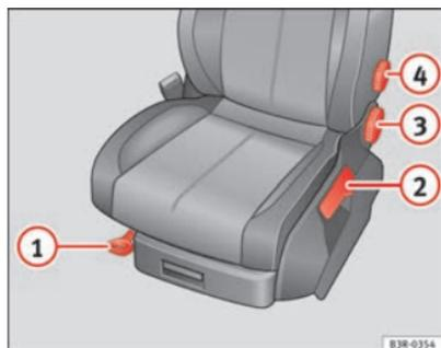
Fig. 105 Commandes du siège du conducteur
