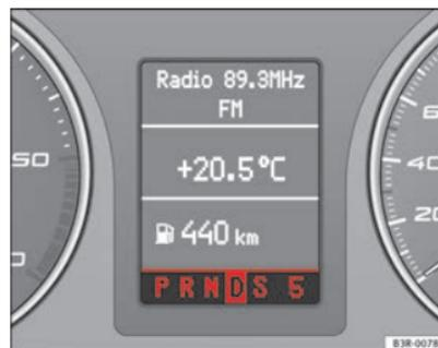
Fig. 144 Afficheur : Position du levier sélecteur
