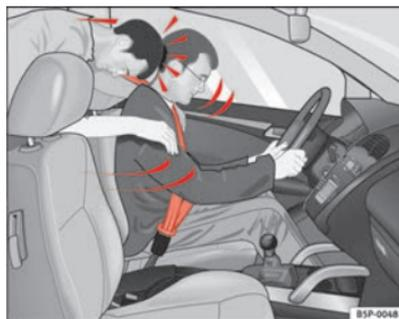
**Fig. 9 Le passager arrière non attaché est projeté en avant et vient heurter le conducteur attaché**
