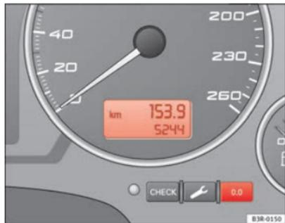
Fig. 42 Détail du tableau de bord : Compteur kilométrique
