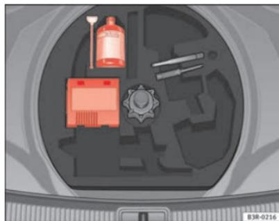
Fig. 177 Kit antirevaision (Tire Mobility System) logé sous le plancher de chargement dans le coffre à bagages
