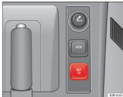
**Fig. 173** Détail de la console centrale : touche de l'indicateur de contrôle des pneus
