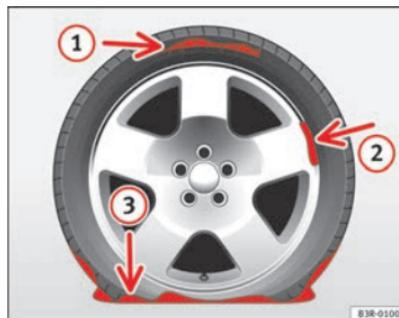
**Fig. 184** Dommages pour lesquels le Tire-Mobility-System ne convient pas.
