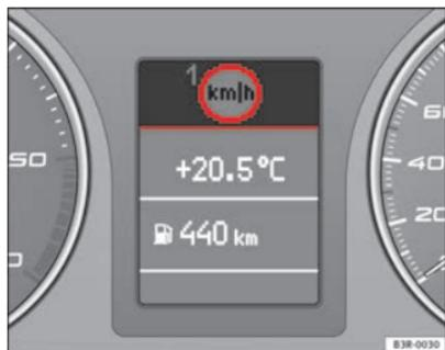
Fig. 56 Afficheur : Dispositif d'alerte de dépassement de vitesse
