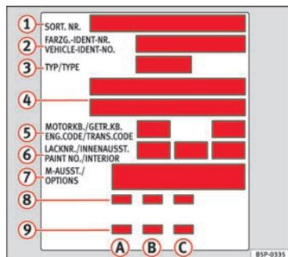
Fig. 232 Plaquette d'identification du véhicule - coffre à bagages
