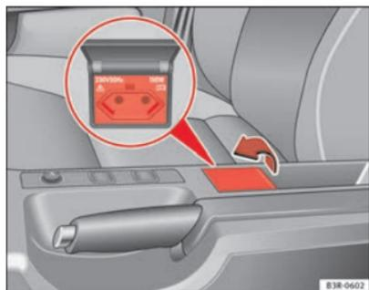
**Fig. 126** Centre de la console centrale : prise de courant de 230 volts
