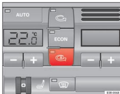
Fig. 131 Commande du mode de recyclage de l'air ambiant automatique
