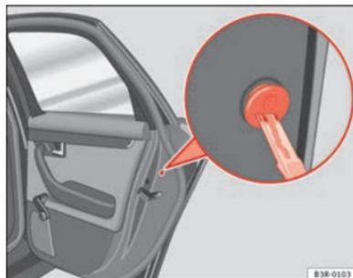
Fig. 72 Dispositif de verrouillage d'urgence
