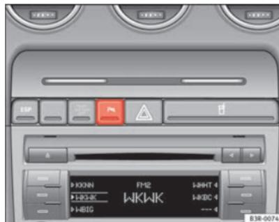
Fig. 139 Console centrale : commande de l'aide au stationnement ▶
