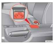
Fig. 126 Centre console: 230 volt socket
