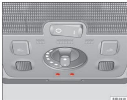
**Fig. 94** Pormenor do revestimento do tecto: Iluminação exterior
