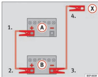
Fig. 226 Esquema de ligação dos cabos auxiliares do arranque
