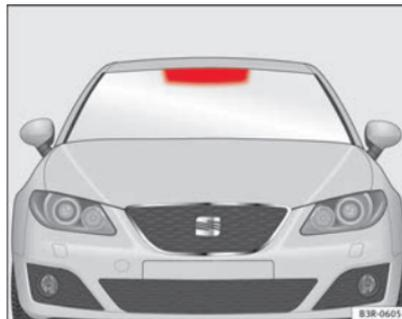
Fig. 162 Área de colocação do dispositivo identificador de portagem
