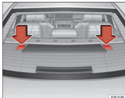
Fig. 34 Posição das anilhas Top Tether na bandeja traseira
