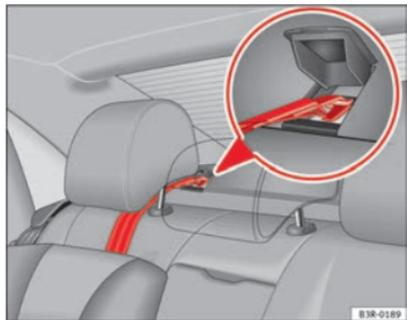
Fig. 35 Correia de fixação: ajuste correcto e montagem
