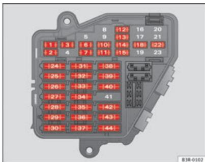
Fig. 186 Ilustração básica do porta-fusíveis na cobertura dianteira esquerda do painel de instrumentos: Fusíveis (sem a tampa dos fusíveis)
