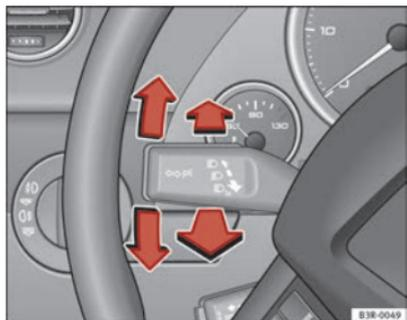
Fig. 92 Alavanca das luzes indicadoras de mudança de direcção e dos máximos
