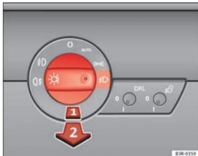
Fig. 84 Pormenor do painel de instrumentos: Comutador das luzes
