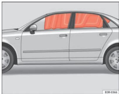
**Fig. 26** Airbags da cabeça activados
