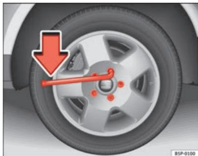
Fig. 179 Substituição de pneu: Aliviar os parafusos da roda
