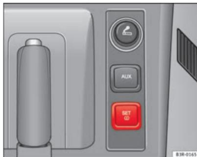
**Fig. 173** Pormenor da consola central: Botão do indicador da pressão dos pneus
