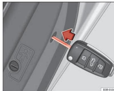
Fig. 73 Activar a trancagem de emergência ►
