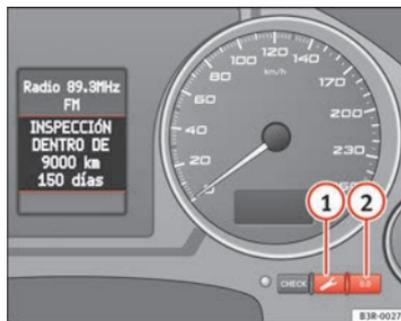
Fig. 52 Pormenor do painel de instrumentos: Indicação dos intervalos de serviço
