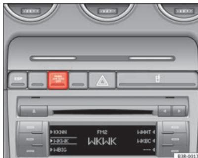
Fig. 28 Aviso de controlo da desactivação do airbag do passageiro
