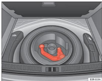
Fig. 151 Porta-bagagens: Pneu suplente com dispositivo de reboque
