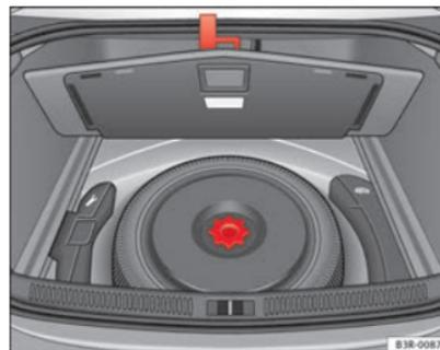
Fig. 178 Pneu suplente com jante de aço
