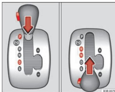
Fig. 145 Bloqueio da alavanca selectora
