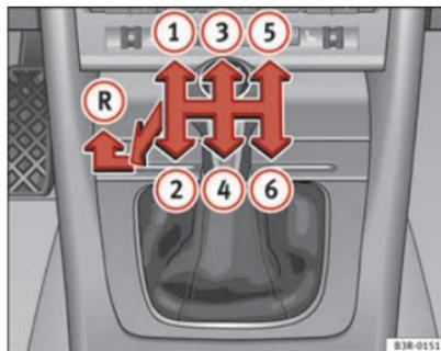
Fig. 142 Pormenor da consola central: esquema de uma caixa de velocidades manual de 6 velocidades
