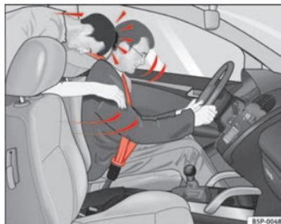
**Fig. 9** O passageiro do banco traseiro que não tiver colocado o cinto de segurança é projectado em frente, para cima do condutor que tem o cinto colocado.
