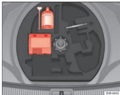
Fig. 177 Kit de reparação de pneus (tire mobility system) debaixo da superfície de carga do porta-bagagens
