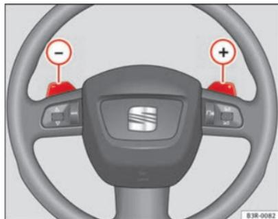
Fig. 148 Volante: Comandos do tiptronic
