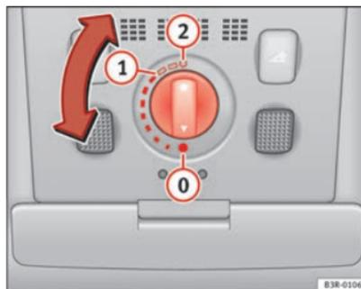
Fig. 81 Pormenor do revestimento do tecto: Comando giratório do tecto de abrir/deflector
