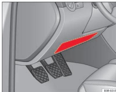
Fig. 21 Airbag de joelhos do condutor
