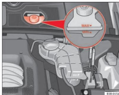
Fig. 172 Compartimento do motor: marcas no depósito do líquido dos travões
