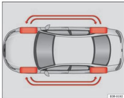
Fig. 175 Esquema de troca dos pneus
