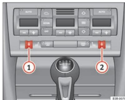
Fig. 133 Pormenor do painel de instrumentos: Rodas recartilhadas do aquecimento dos bancos
