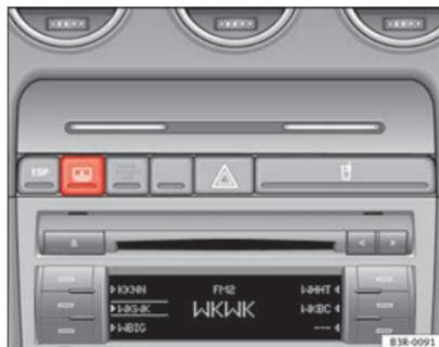
Fig. 100 Tecla para a cortina eléctrica do vidro traseiro
