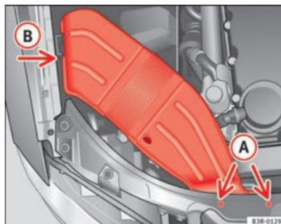
Fig. 200 Condutas de ventilação no lado direito do veículo
