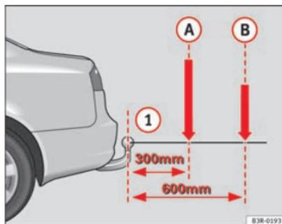
Fig. 150 Representação básica da distribuição da carga de peças acessórias e acessórios
