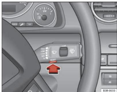
Fig. 61 Manípulo do limpa pára-brisas: Teclas de comando para seleccionar menus
