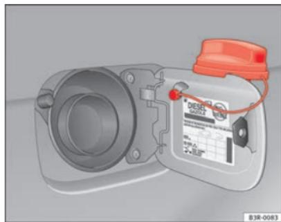
**Fig. 163** Tampa do depósito com o tampão encaixado
