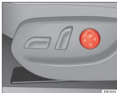
Fig. 109 Banco dianteiro: Placa reguladora do apoio lombar
