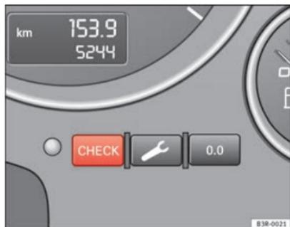
Fig. 57 Pormenor do painel de instrumentos: Tecla CHECK
