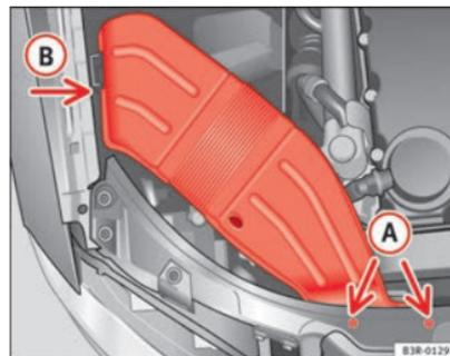
Fig. 188 Condutas de ventilação no lado direito do veículo
