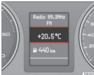
Fig. 49 Visor: Indicador da temperatura exterior
