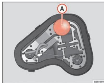
Fig. 210 Localização da lâmpada de incandescência no porta-lâmpadas. Exemplo: Farolim traseiro esquerdo na lateral.
