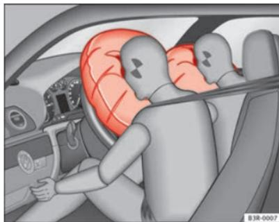
**Fig. 19** Airbags frontais inflados
