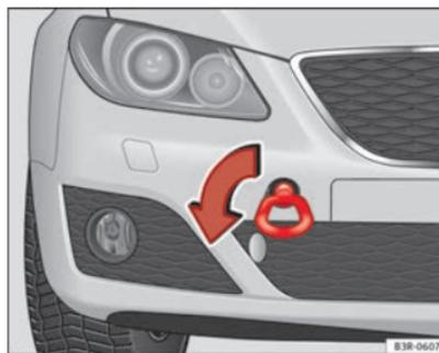
Fig. 227 Enroscamento da argola de reboque na parte dianteira do veículo
