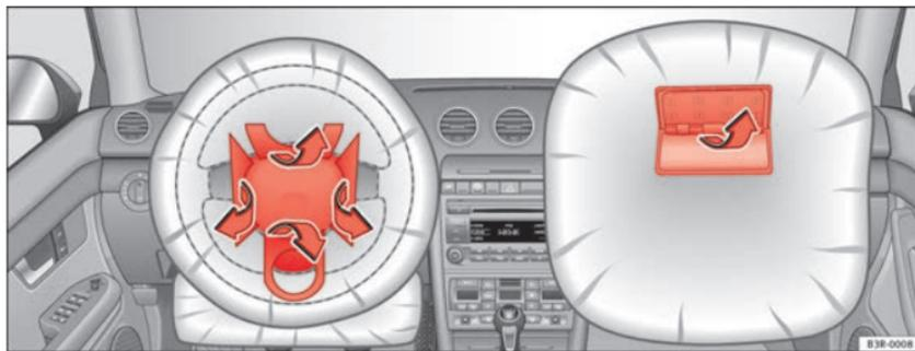
Fig. 20 Tampas dos airbags ao dispararem os airbags frontais
