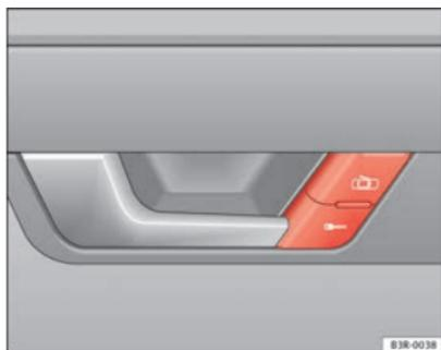
**Fig. 71** Pormenor da porta do condutor: Comutador do fecho centralizado
