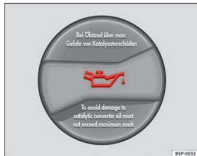
**Fig. 167 Tampa do bocal de enchimento do óleo do motor no compartimento do motor**
