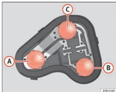
Fig. 209 Localização das lâmpadas de incandescência no porta-lâmpadas. Exemplo: Farolim traseiro esquerdo na lateral.
