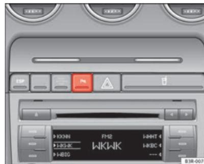
Fig. 139 Consola central: Interruptor de auxílio de estacionamento
