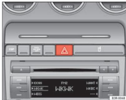
Fig. 91 Consola central: Interruptor para as luzes simultâneas de emergência
