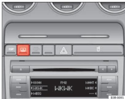
Abb. 100 Taste für elektrisches Heckrollo
