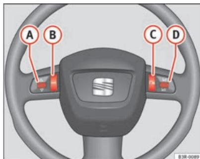
Abb. 64 Bedienelemente am Multifunktionslenkrad
