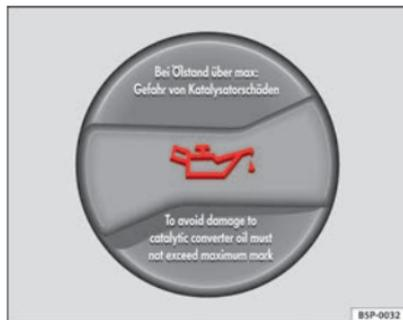
Abb. 167 Deckel der Motoröl-Einfüllöffnung im Motorraum
