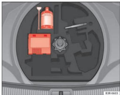
Abb. 177 Reifenreparaturset (Tire-Mobility-System) unter Ladeboden im Gepäckraum
