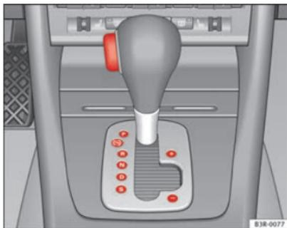
Abb. 143 Ansicht der Mittelkonsole: Wählhebel mit Sperrtaste
