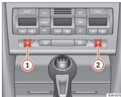
Abb. 133 Ausschnitt aus der Instrumententafel: Rändelräder der Sitzheizung
