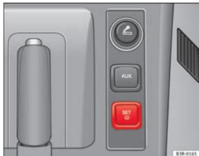
Abb. 173 Ansicht der Mittelkonsole: Taste für die Reifenkontrollanzeige
