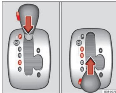
Abb. 145 Wählhebelsperre
