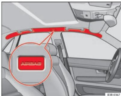
Abb. 25 Einbaulage der Kopfairbags auf der linken Fahrzeugseite
