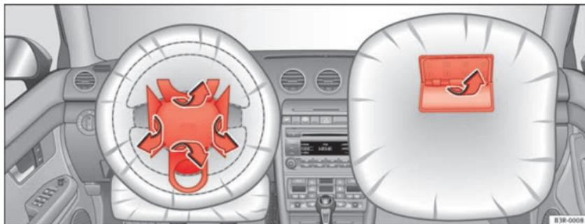
Abb. 20 Airbagabdeckungen bei ausgelösten Frontairbags
