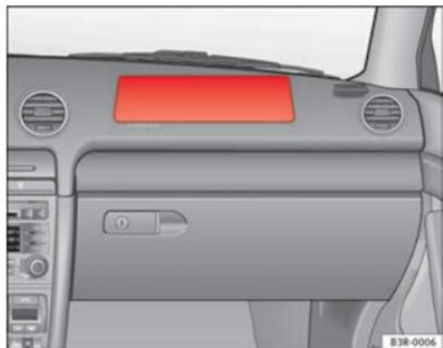
Abb. 18 Einbauort Beifahrerairbag: in der Instrumententafel
