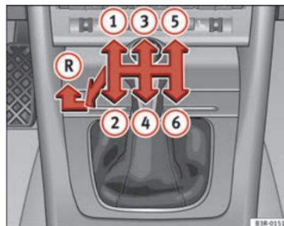
Abb. 142 Ansicht der Mittelkonsole: Schalt-schema eines 6-Gang-Schaltgetriebes
