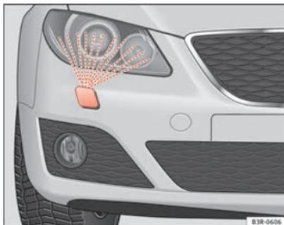
Abb. 102 Scheinwerfer mit ausgefahrener Waschdüse
