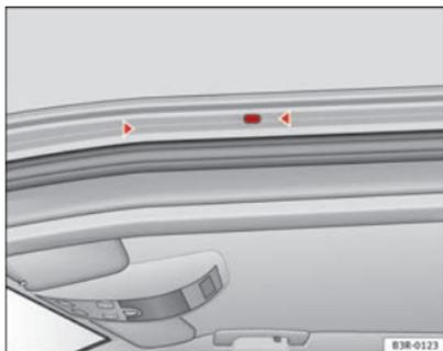
Abb. 119 Befestigungspunkte für Grundträger
