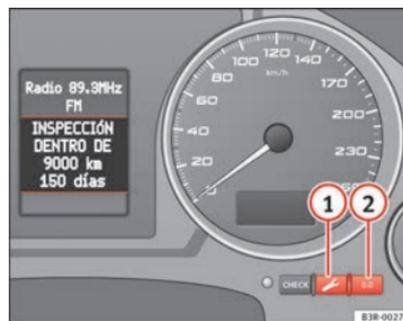
Abb. 52 Ausschnitt aus Kombiinstrument: Service-Intervall-Anzeige
