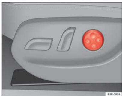
Abb. 109 Vordersitz: Schalterplatte für Lendenwirbelstütze
