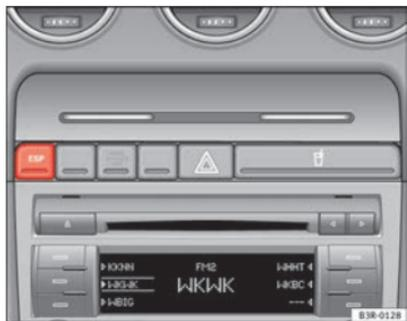
Abb. 149 Mittelkonsole mit ESP-Schalter
