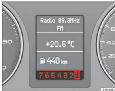
Abb. 147 Display: Manuelles Schalten (tiptronic-Betrieb)
