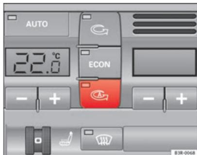
Abb. 131 Bedientaste für den automatischen Umluftbetrieb
