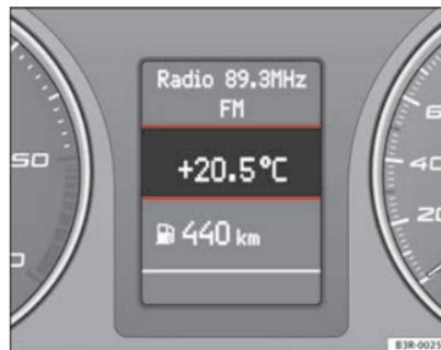
Abb. 49 Display: Außentemperaturanzeige
