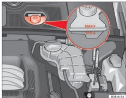
Abb. 172 Motorraum: Markierungen am Bremsflüssigkeitsbehälter
