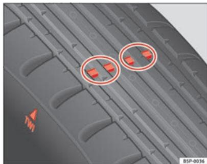
Abb. 174 Prinzipdarstellung Reifenprofil: Verschleißanzeiger
