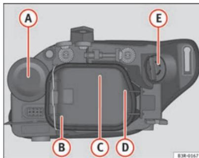
Abb. 189 Glühlampen des Halogenscheinwerfers
