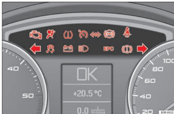
Abb. 44 Kombiinstrument mit Kontrollleuchten
