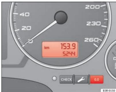
Abb. 42 Ausschnitt aus Kombiinstrument: Kilometerzähler
