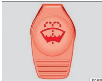
Abb. 169 Im Motorraum: Deckel des Scheibenwaschwasserbehälters ▶
