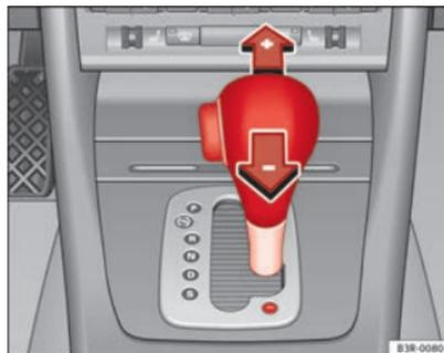
Abb. 146 Mittelkonsole: Manuelles Schalten (tiptronic-Betrieb)
