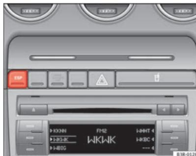
Abb. 135 Ansicht der Mittelkonsole: ESP-Taste ▶
