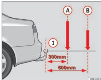
Abb. 150 Prinzipdarstellung der Lastverteilung von Anbauteilen und Zubehör
