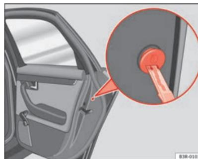
Abb. 72 Notverriegelungsvorrichtung
