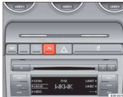
Abb. 139 Mittelkonsole: Schalter für Einparkhilfe
