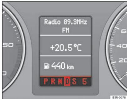
Abb. 144 Display: Wählhebelstellung
