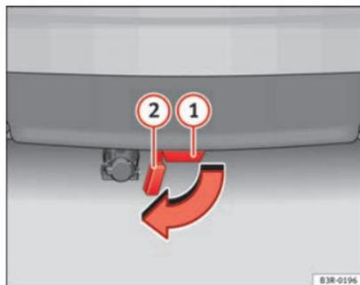
**Abb. 152 Stoßfänger hinten: Verschlussdeckel aufklappen**
