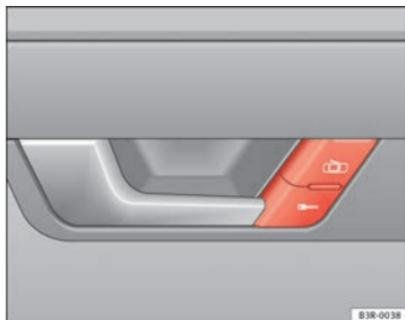
Abb. 71 Ausschnitt aus der Fahrertür: Zentralverriegelungsschalter
