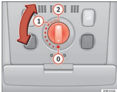
Abb. 81 Ausschnitt aus Dachhimmel: Drehschalter für Schiebe-/Ausstelldach
