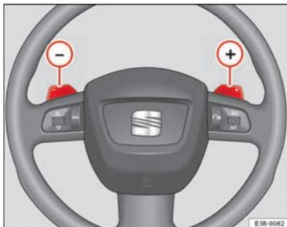
Abb. 148 Lenkrad: tiptronic-Schalter
