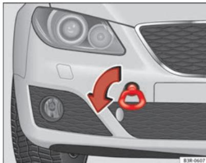
Abb. 227 Einschrauben der Abschleppöse vorne am Fahrzeug
