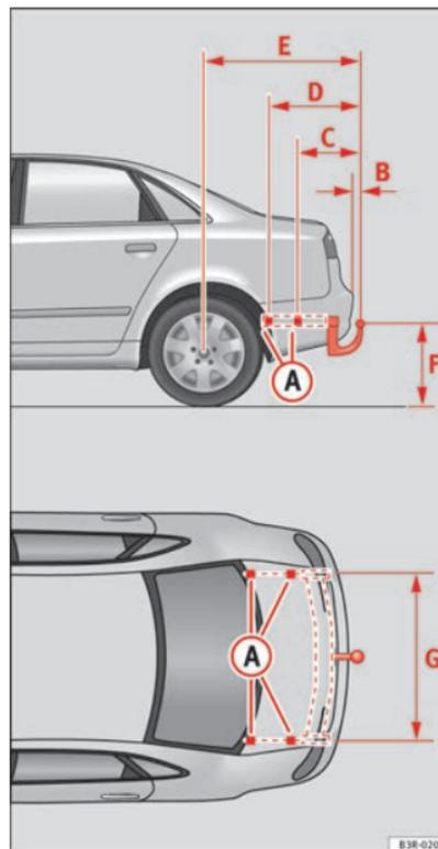
Abb. 161 Befestigungspunkte für die Anhangervorrichtung
