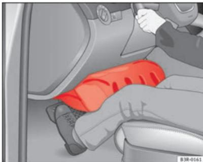
**Abb. 22** Die aufgeblasenen Airbags schützen bei einem Frontaufprall
