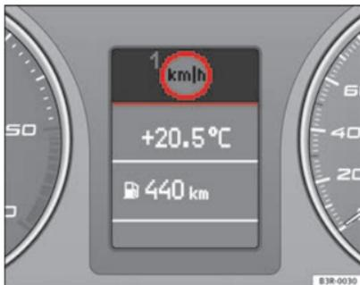
Abb. 56 Display: Geschwindigkeitswarnanlage
