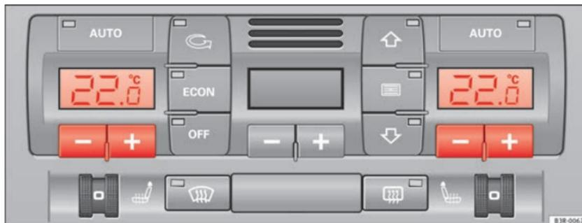
Abb. 130 Bedienelemente der Klimaanlage
