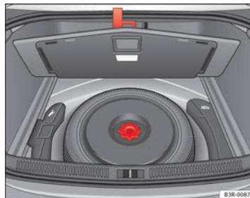
Fig. 178 Spare steel rim wheel
