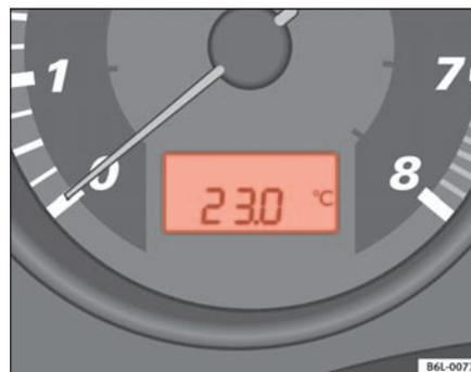
Fig. 36 Pantalla digital del cuadro de instrumentos: indicador de la temperatura exterior
