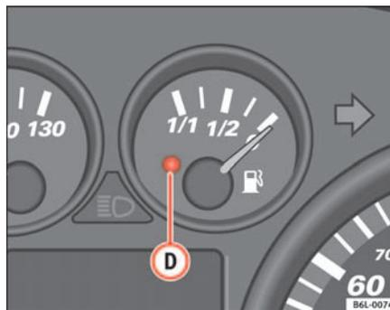
Fig. 34 Indicador de nivel del depósito de combustible
