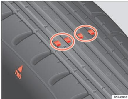
**Fig. 127** Indicadores de desgaste del perfil del neumático
