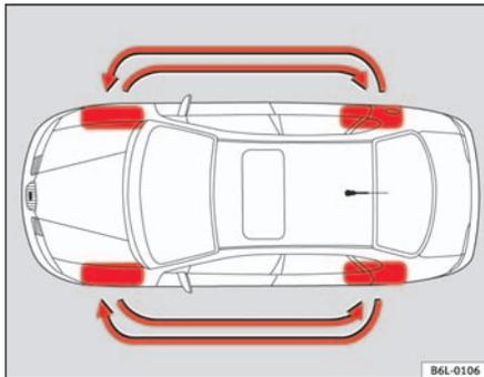
**Fig. 128** Esquema para el cambio de ruedas
