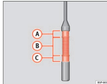
**Fig. 120** Varilla de medición del nivel de aceite.
