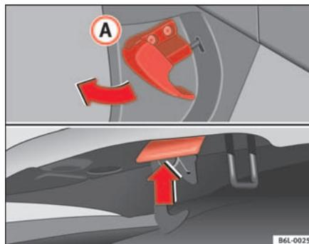
**Fig. 118** Detalle de la zona reposapiés del lado del conductor: palanca para el desbloqueo del capó del motor.
