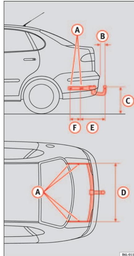
Fig. 116 Puntos de fijación del dispositivo de remolque
