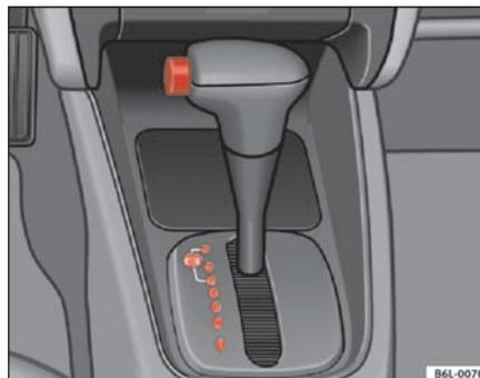
**Fig. 94** Consola central: palanca selectora del cambio automático
