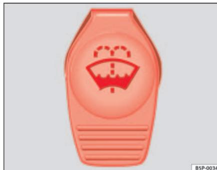
**Fig. 123** Tapón del depósito del lavacristales en el vano motor.
