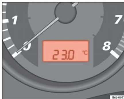
Fig. 38 Pantalla digital del cuadro de instrumentos: indicador temperatura exterior.
