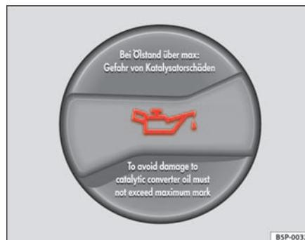
**Fig. 121 Tapón de la boca de llenado de aceite del motor en el vano motor**
