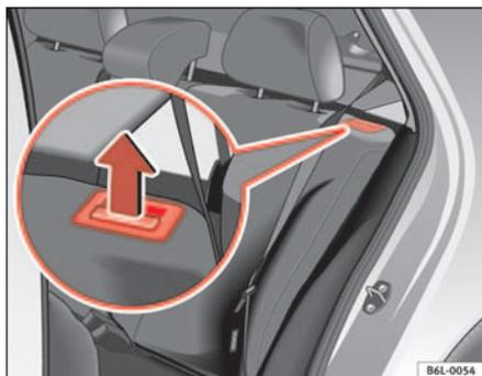
Fig. 74 Tecla de desbloqueo del respaldo trasero
