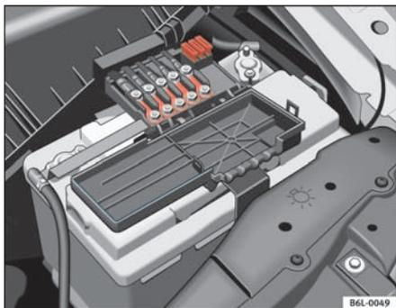
Fig. 137 Caja de fusibles sobre la batería
