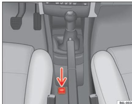
**Fig. 91** Detalle de la consola central: tecla ESP
