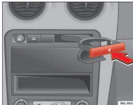
Fig. 78 Portabebidas delantero en la consola central
