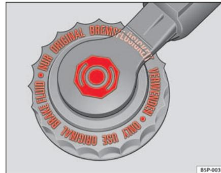
**Abb. 126** Im Motorraum: Abdeckung des Bremsflüssigkeitsbehälters
