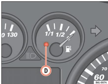
Abb. 34 Kraftstoffvorrats-Anzeige
