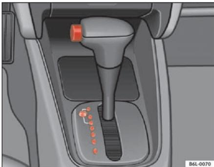
Abb. 95 Ausschnitt aus der Mittelkonsole: Wählhebel vom Automatikgetriebe
