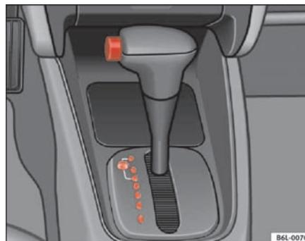
Abb. 94 Ausschnitt aus der Mittelkonsole: Wählhebel vom Automatikgetriebe
