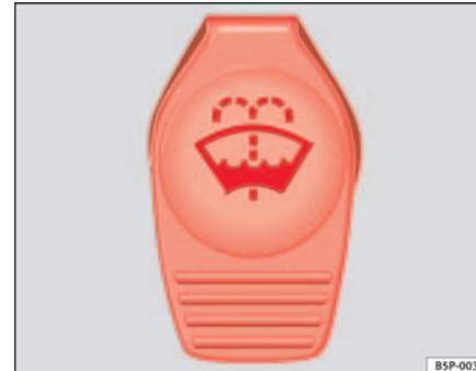
Abb. 123 Im Motorraum: Deckel des Scheibenwaschwasserbehälters
