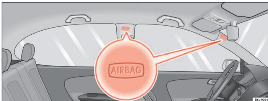
**Abb. 23** Einbauort der Kopfairbags auf der linken Fahrzeugseite
