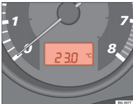
Abb. 36 Display im Kombiinstrument: Außentemperaturanzeige
