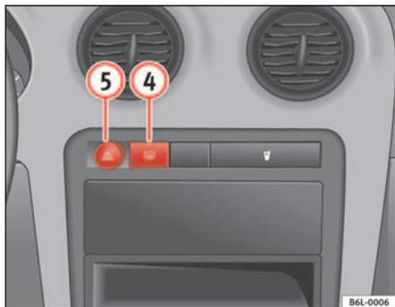
Abb. 58 Instrumententafel: Schalter Heckscheibenheizung
