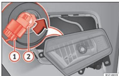
**Fig. 107** Faro antiniebla: desmontar el portalámparas
