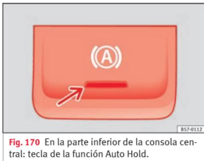
**Fig. 170** En la parte inferior de la consola central: tecla de la función Auto Hold.
