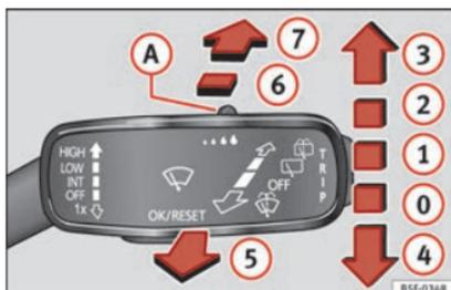
Fig. 39 Manejo del limpiaparabrisas y limpialuneta.
