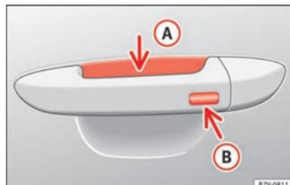
**Fig. 124** Sistema de cierre y arranque sin llave Keyless Access: superficie sensora **A** de desbloqueo en la parte interior de la manilla de la puerta y superficie sensora **B** de bloqueo en la parte exterior de la manilla.
