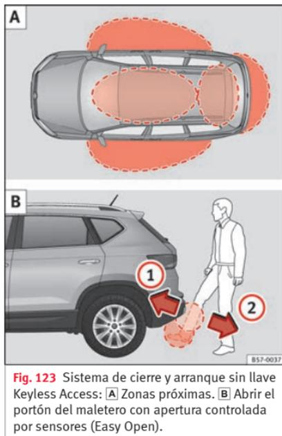
**Fig. 123** Sistema de cierre y arranque sin llave Keyless Access: **A** Zonas próximas. **B** Abrir el portón del maletero con apertura controlada por sensores (Easy Open).
