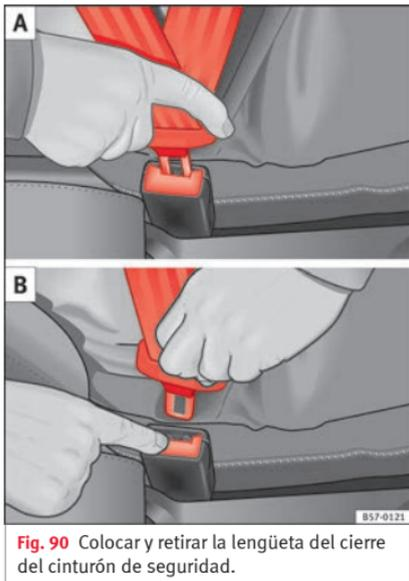
**Fig. 90** Colocar y retirar la lengüeta del cierre del cinturón de seguridad.
