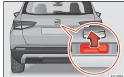
**Abb. 5** Heckklappe: Haltegriff
