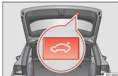
**Abb. 129** Gepäckraumklappe geöffnet: Taste zum sofortigen Schließen der Gepäckraumklappe
