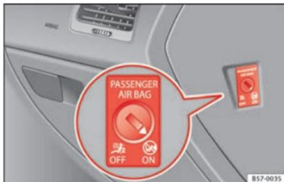
**Abb. 22** Schalter für Beifahrer-Frontairbag.
