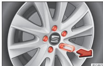
**Abb. 69** Rad: Radschrauben mit Deckel.
