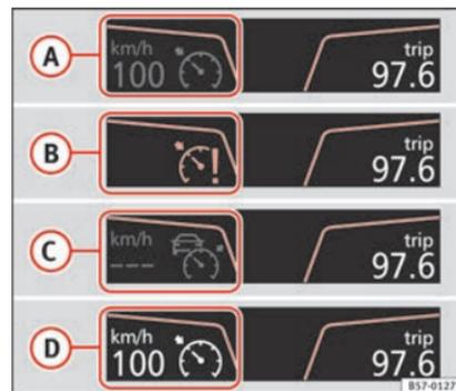
Abb. 171 Display des Kombiinstruments: Zustandsanzeigen der GRA.
