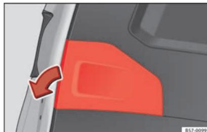
**Abb. 110** Gepäckraumklappe geöffnet: Abdeckung entfernen.
