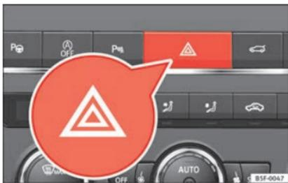
Abb. 135 Instrumententafel: Schalter für die Warnblinkanlage
