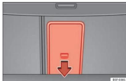
**Abb. 153** Im Gepäckraum: Öffnung der Durchladeeinrichtung.
