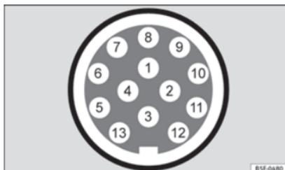
Abb. 218 Schematische Darstellung: Zuweisung der Steckverbinderstifte für Anhängerstrom.
