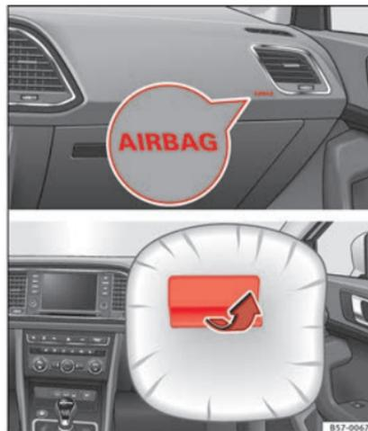
**Abb. 21** Beifahrerairbag in der Instrumententafel
