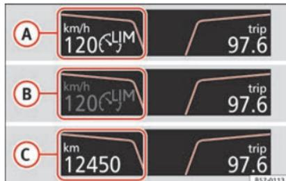
**Abb. 172** Im Display des Kombiinstrumentes: Statusanzeigen des Geschwindigkeitsbegrenzers.
