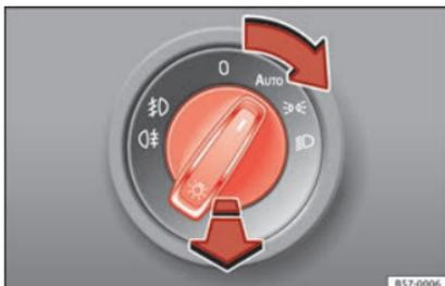
**Abb. 35** Instrumententafel: Bedienelement Licht
