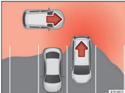
**Abb. 196** Schematische Abbildung des Ausparkassistenten: Überwachter Bereich des ausparkenden Fahrzeugs.
