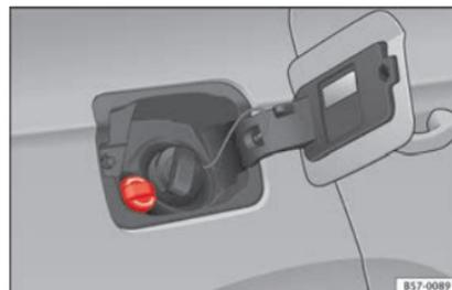
**Abb. 220** Verschlussdeckel des AdBlue-Tanks
