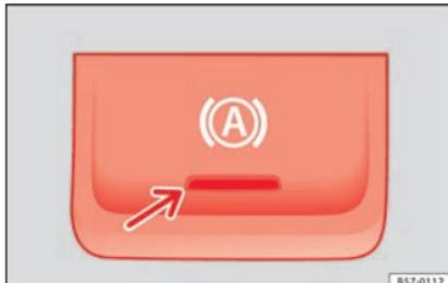
**Abb. 170** Im unteren Bereich der Mittelkonsole: Funktionstaste Auto-Hold.
