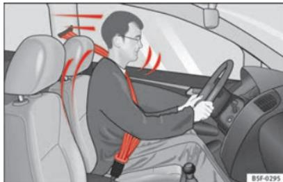
**Abb. 87** Richtig angegurtete Fahrer werden bei einem plötzlichen Bremsmanöver nicht nach vorne geschleudert.
