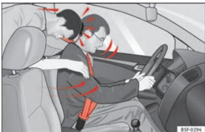
**Abb. 89** Der nicht angegurte Mitfahrer auf dem Rücksitz schleudert nach vorn auf den angegurten Fahrer.
