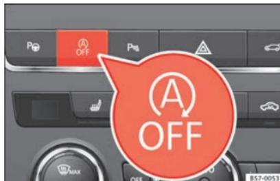
Abb. 169 Mittelkonsole: Systemtaste Start-Stopp.
