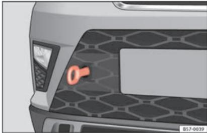
**Abb. 74** Vorderer Stoßfänger rechts: Eingeschraubte Abschleppöse
