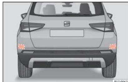
**Abb. 193** Bereich hinter dem Fahrzeug: Bereiche der Radarsensoren.
