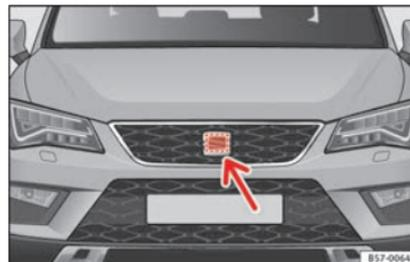
**Abb. 177** Im Frontbereich hinter dem SEAT-Emblem: Radarsensor.
