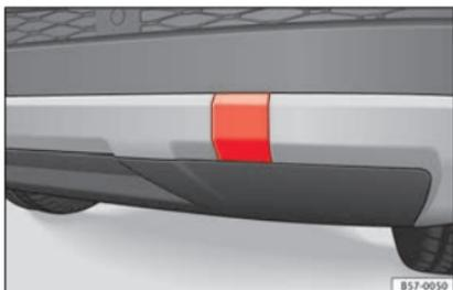
**Abb. 98** Auf der rechten Seite des hinteren Stoßfängers: Abdeckung entfernen.
