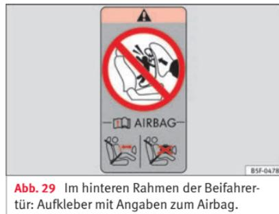
Abb. 29 Im hinteren Rahmen der Beifahrertür: Aufkleber mit Angaben zum Airbag.
