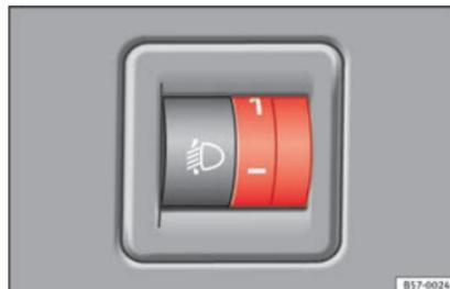
**Abb. 136** Neben dem Lenkrad: Regler für die Leuchtweitenregulierung.
