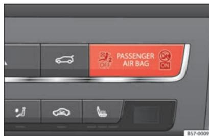
Abb. 94 Kontrolllampchen für Abschaltung des und Beifahrerairbags.
