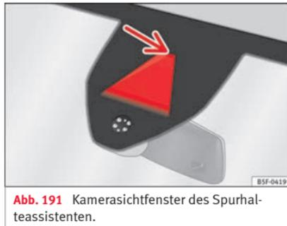
**Abb. 191** Kamerasichtfenster des Spuralteassistenzsystems.
