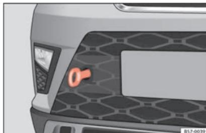
Abb. 97 Auf der rechten Seite des vorderen Stoßfängers: Eingeschraubte Abschleppöse.
