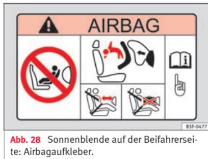
Abb. 28 Sonnenblende auf der Beifahrerseite: Airbagaufkleber.
