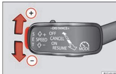
**Abb. 179** Auf der linken Seite der Lenksäule: dritter Hebel für die Betätigung der automatischen Distanzregelung.
