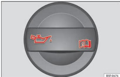
Abb. 223 Deckel der Motoröl-Einfüllöffnung im Motorraum
