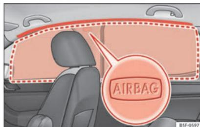
**Abb. 27** Einbauort der Kopfairbags
