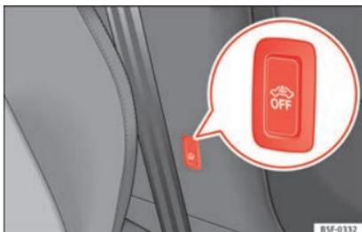
**Abb. 128** Taste für Innenraum-/Abschleppschutzüberwachung
