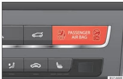
**Abb. 92** Kontrollleuchte in der Instrumententafel für abgeschalteten Beifahrer-Frontairbag.
