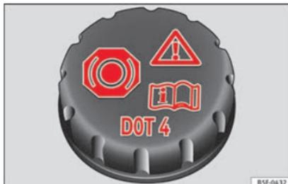
**Abb. 62** Motorraum: Deckel des Bremsflüssigkeitsbehälters
