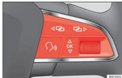
**Abb. 43** Rechte Seite Multifunktions-Lenkrad: Steuertasten.
