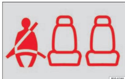
**Abb. 86** Kombi-Instrument: Anzeige, dass der Platz hinten rechts besetzt und der entsprechende Sicherheitsgurt angelegt ist.
