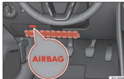
**Abb. 23** Auf der Fahrerseite: Einbauort des Knieairbags.
