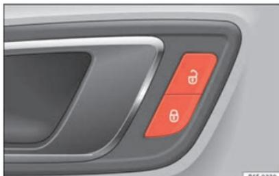
Abb. 2 Fahrertür: Taste Zentralverriegelung.
