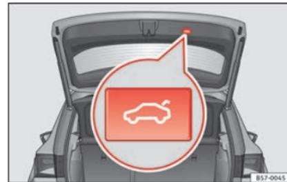
**Abb. 6** Heckklappe: Taste zum Schließen der Heckklappe.
