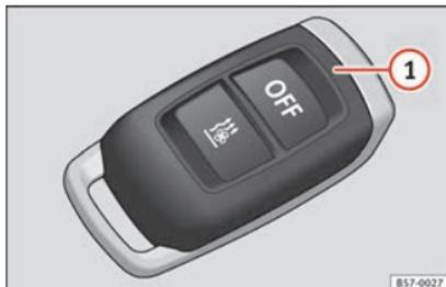
**Abb. 162** Standheizung: Funkfernbedienung.
