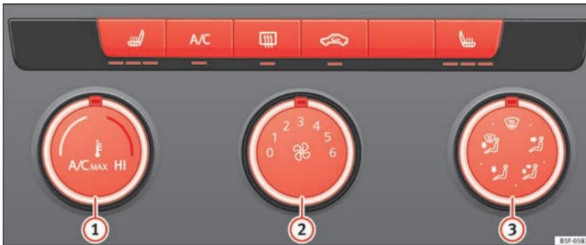
Abb. 56 In der Mittelkonsole: Bedienelemente der manuellen Klimaanlage.
