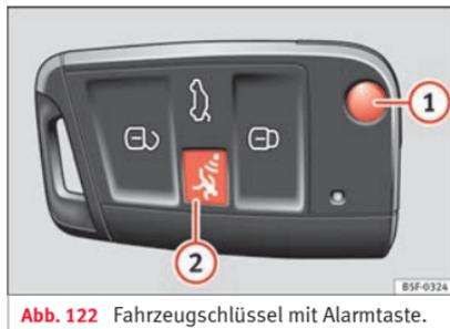
**Abb. 122** Fahrzeugschlüssel mit Alarmtaste.
