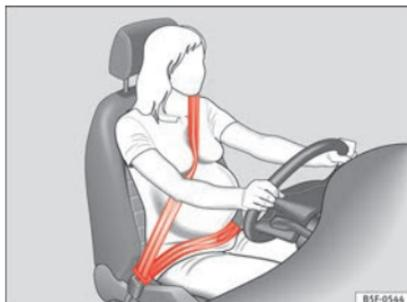
**Abb. 91** Gurtbandverlauf bei schwangeren Frauen.
