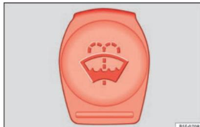
**Abb. 63** Im Motorraum: Deckel des Scheibenwaschbehälters.
