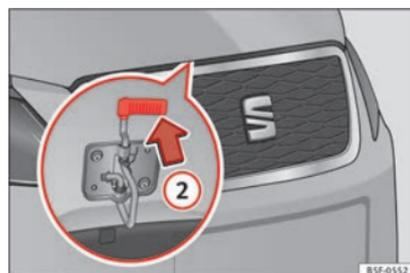
**Abb. 10** Hebel unter der Motorraumklappe. »
