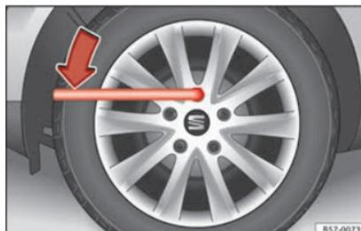
**Abb. 71** Rad: Radschrauben lockern.
