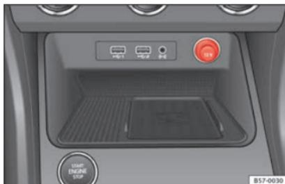
Abb. 148 In der Mittelkonsole hinten: 12-Volt-Steckdose.
