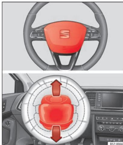
**Abb. 20** Einbauort Fahrerairbag: im Lenkrad.
