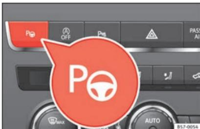
**Abb. 200** In der Mittelkonsole oben: Taste zum Einschalten des Parklenkassistenten.
