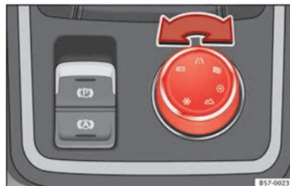
Abb. 197 Mittelkonsole: Drehknopf (Driving Experience button).
