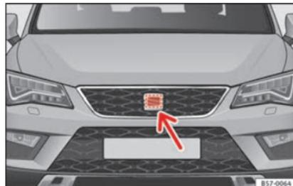
**Abb. 185** Im Frontbereich hinter dem SEAT-Emblem: Radarsensor.
