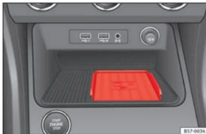
**Abb. 120** Mittelkonsole: Connectivity Box
