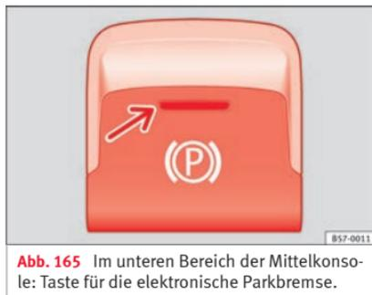
**Abb. 165** Im unteren Bereich der Mittelkonsole: Taste für die elektronische Parkbremse.
