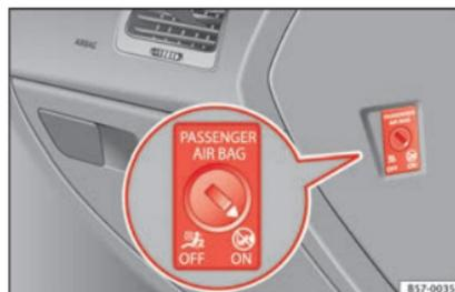
Abb. 93 Schalter für Beifahrer-Frontairbag.
