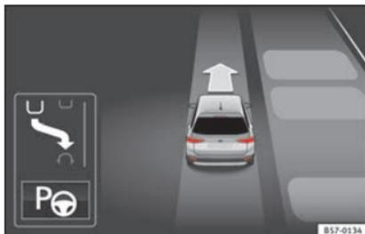
**Abb. 202** Im Display des Kombiinstruments: Anzeige des Parklenkassistenten mit Miniaturansicht.
