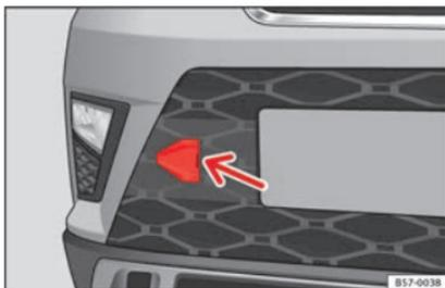
Abb. 96 Auf der rechten Seite des vorderen Stoßfängers: Abdeckung entfernen.
