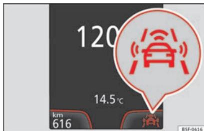
Fig. 189 Sur l'écran du combiné d'instruments : indication de Front Assist désactivé.
