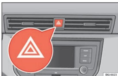
Fig. 39 Planche de bord : commande des feux de détresse.
