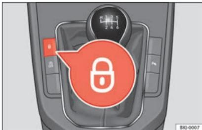
Fig. 137 Touche de verrouillage centralisé.
