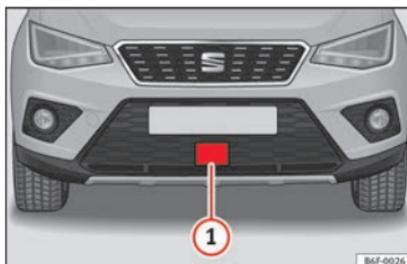
Fig. 188 Au niveau du pare-chocs avant : capteur radar.
