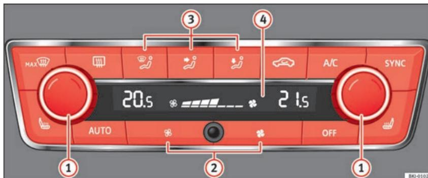
Fig. 60 Dans la console centrale : commandes du Climatronic.
