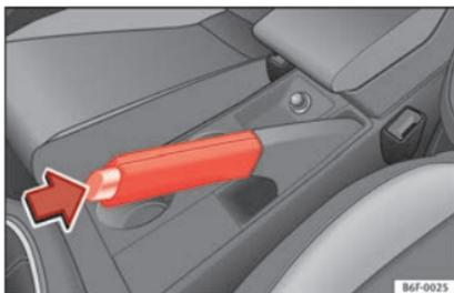
Fig. 176 Frein à main entre les sièges avant.
