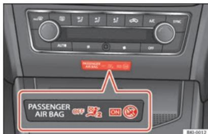
**Fig. 103** Sur le tableau de bord, au centre : témoin de désactivation de l'airbag du passager avant.
