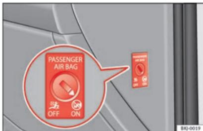
**Fig. 102** Commande à clé permettant d'activer et de désactiver les airbags du passager avant.
