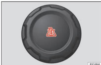
**Fig. 66** Compartiment-moteur : bouchon du vase d'expansion du liquide de refroidissement.
