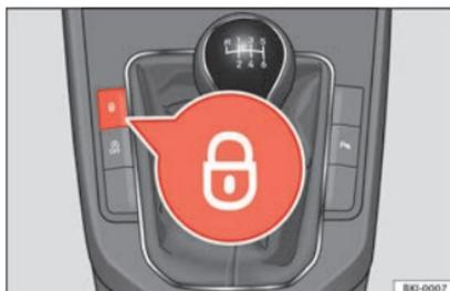
**Fig. 3** Console centrale : touches de verrouillage centralisé.
