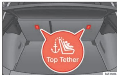
Fig. 31 Position des anneaux Top Tether sur la partie arrière de la banquette arrière.
