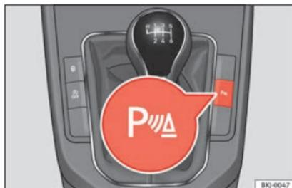
Fig. 216 Console centrale : touche de l'aide au stationnement.
