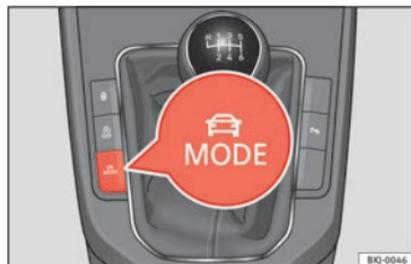
Fig. 206 À côté du levier de vitesses : touche MODE.
