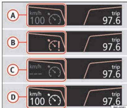
**Fig. 183** Afficheur du combiné d'instruments indications d'état du GRA.
