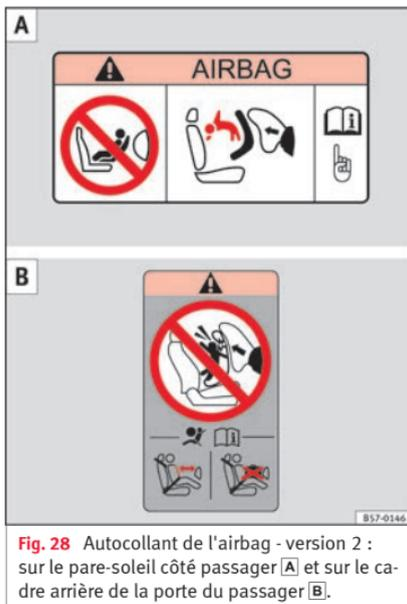
**Fig. 28** Autocollant de l'airbag - version 2 : sur le pare-soleil côté passager **A** et sur le cadre arrière de la porte du passager **B**.
