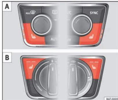
Fig. 152 Dans la console centrale : commandes du chauffage des sièges avant. A : version avec Climatronic. B : version avec climatiseur manuel.
