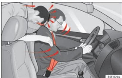
**Fig. 99** L'occupant de la banquette arrière non attaché est projeté en avant et vient heurter le conducteur attaché.
