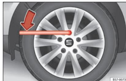
Fig. 80 Changement de roue : desserrer les vis de roue.
