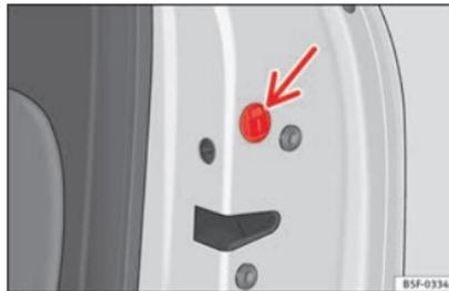
**Fig. 5** Verrouillage d'urgence de la porte.
