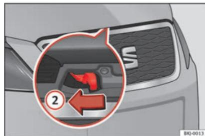
Fig. 10 Levier sous le capot.
