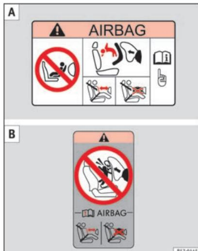
Fig. 27 Autocollant de l'airbag - version 1 : sur le pare-soleil côté passager [A] et sur le cadre arrière de la porte du passager [B]. » »
