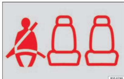
Fig. 96 Combiné d'instruments : indication de place arrière droite occupée et de ceinture correspondante bouclée.
