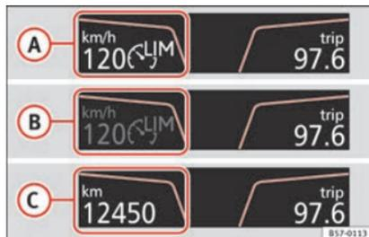
Fig. 184 Sur l'écran du combiné d'instruments : indications de l'état du limiteur de vitesse.
