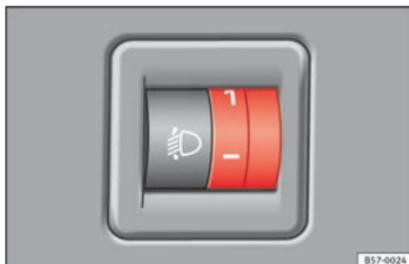
Fig. 146 Planche de bord : dispositif de réglage de la portée des phares.
