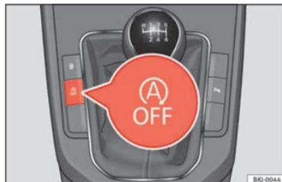
Fig. 182 Console centrale : touche du système Start-Stop.
