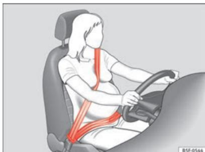
**Fig. 101** Ajustement recommandé de la sangle de ceinture de sécurité pour les femmes enceintes.
