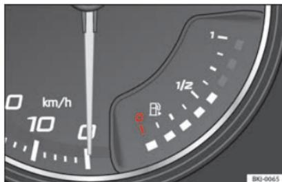
Fig. 126 Indicateur de carburant.
