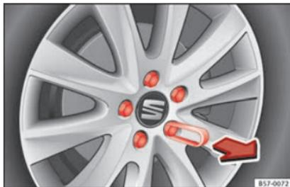
Fig. 79 Roue : boulons de roue avec capuchons.
