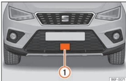
Fig. 236 Sul paraurti anteriore: sensore radar.
