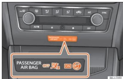
**Fig. 25** Sulla parte centrale del quadro strumenti: spia della disattivazione degli airbag del passeggero anteriore.
