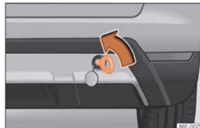
**Fig. 100** Paraurti posteriore destro: occhiello di traino avvitato.
