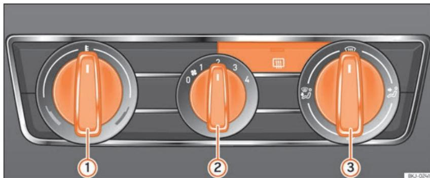
**Fig. 169** Comandi del riscaldamento sulla plancia portastrumenti.
