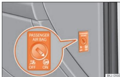
**Fig. 94** Interruttore a chiave per l'attivazione e la disattivazione dell'airbag del passeggero.
