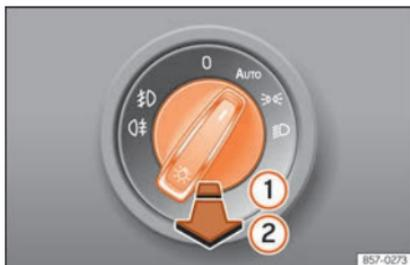
**Fig. 142** Plancia portastrumenti: interruttore delle luci.
