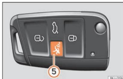
Fig. 132 Chiave del veicolo con pulsante di allarme.
