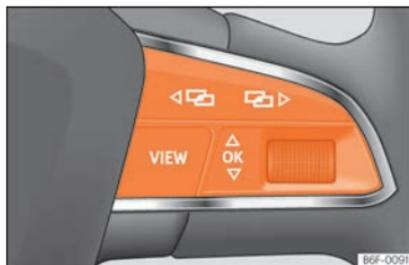
**Fig. 127** Lato destro del volante multifunzionale: tasti per l'utilizzo dei menu e delle indicazioni informative del quadro strumenti.
