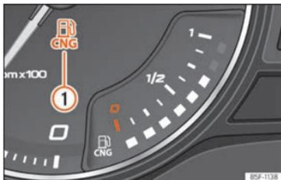
**Fig. 123** Quadro strumenti analogico: Indicatore del livello del gas naturale
