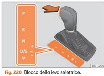
**Fig. 220** Blocco della leva selettoria.
