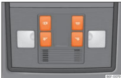
**Fig. 44** Dettaglio del rivestimento del tetto: illuminazione anteriore dell'abitacolo.
