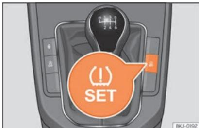
**Fig. 286** Console centrale: tasto del sistema di controllo degli pneumatici.
