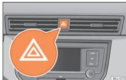
**Fig. 43** Plancia portastrumenti: interruttore lampeggio di emergenza.
