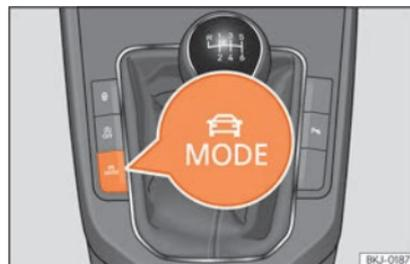
**Fig. 247** Nei pressi della leva del cambio: tasto **MODE**.
