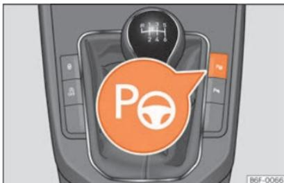
**Fig. 248** Sulla console centrale: tasto per inserire l'assistente di parcheggio
