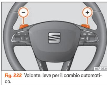
**Fig. 222** Volante: leve per il cambio automatico.
