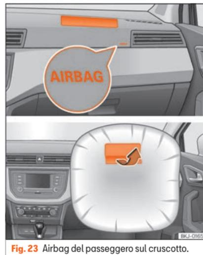
Fig. 23 Airbag del passeggero sul cruscotto.
