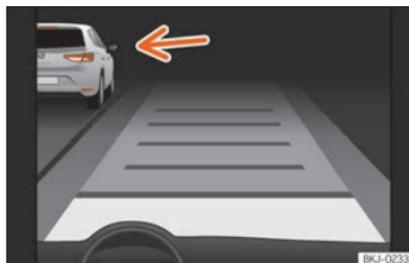
**Fig. 239** Sul display del quadro strumenti: ACC attivo, veicolo rilevato sulla sinistra
