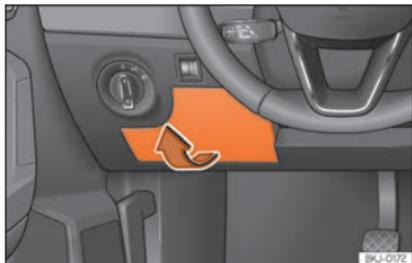
**Fig. 63** Sul cruscotto, lato del conducente: coperchio della scatola dei fusibili.
