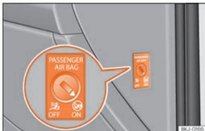
**Fig. 24** Commutatore dell'airbag frontale del passeggero.
