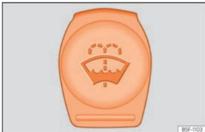
**Fig. 62** Nel vano motore: tappo del serbatoio del tergicristalli.
