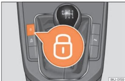
**Fig. 135** Interruttore della chiusura centralizzata.
