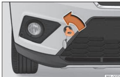
**Fig. 98** Paraurti anteriore destro: occhiello di traino avvitato.
