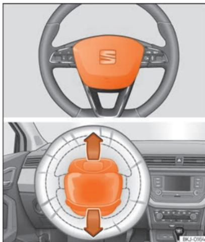
Fig. 22 Airbag del conducente all'interno del volante.
