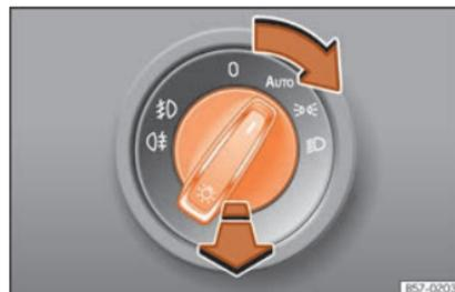
Fig. 41 Plancia portastrumenti: interruttore delle luci.
