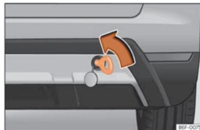
**Fig. 77** Paraurti posteriore destro: occhiello di traino.
