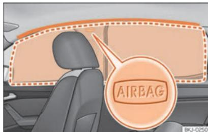
**Fig. 28** Posizione e campo d'azione dell'airbag per la testa.
