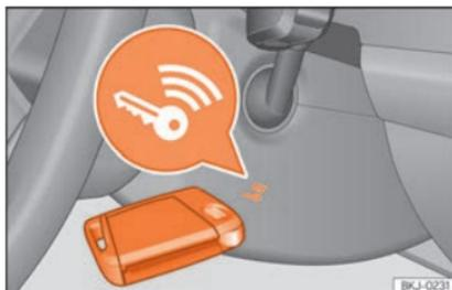
Fig. 217 A destra del piantone dello sterzo: avviamento di emergenza.
