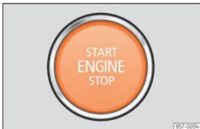
Fig. 216 Nella parte inferiore della console centrale: pulsante di avviamento.
