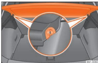
**Fig. 163** Nel bagagliaio: smontare e montare il ripiano.
