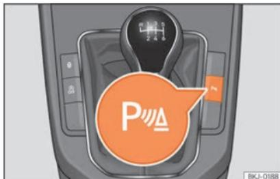
**Fig. 255** Consola centrale: tasto dell'assistenza per il parcheggio (in base alla versione).
