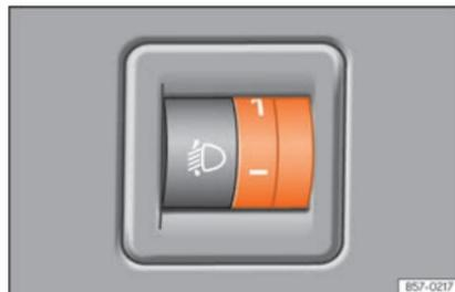
**Fig. 144** Plancia portastrumenti: Correttore assetto fari
