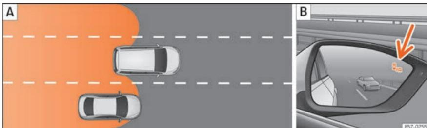
**Fig. 245** Rappresentazione schematica: **A** Situazione in un sorpasso e incorporamento successivo alla corsia destra. **B** Indicazione dell'assistente angolo cieco sullo specchietto retrovisore esterno destro.
