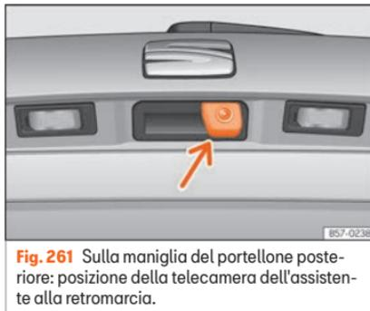
**Fig. 261** Sulla maniglia del portellone posteriore: posizione della telecamera dell'assistente alla retromarcia.
