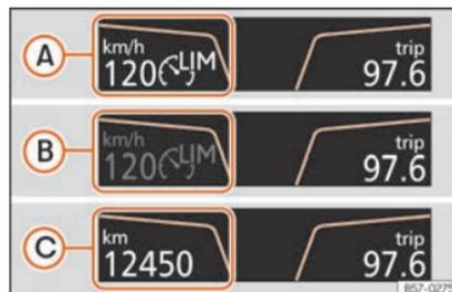
**Fig. 227** Sul display del quadro strumenti: indicazioni dello stato del limitatore di velocità.
