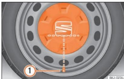
**Fig. 70** Posizionamento corretto del copricerchio centrale per cerchi in acciaio.
