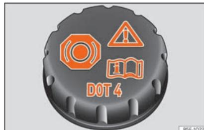
**Fig. 61** Vano motore: tappo del serbatoio del liquido dei freni.
