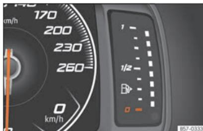
**Fig. 122** Quadro strumenti digitale: indicatore del livello del carburante.
