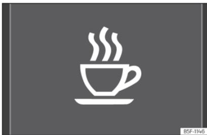
**Fig. 120** Sul display del quadro strumenti: simbolo del riconoscimento della stanchezza del conducente.
