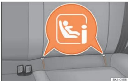
**Fig. 33** Occhielli di fissaggio del sistema ISOFIX/iSize.
