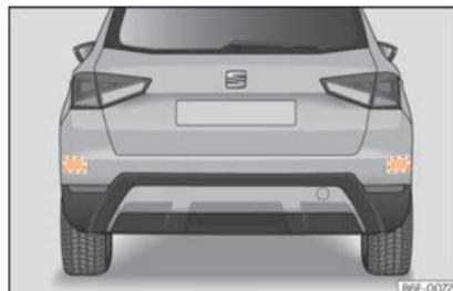
**Fig. 243** Vista complesso posteriore del veicolo: zone dei sensori radar.
