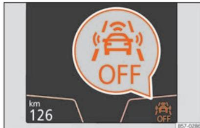
Fig. 232 Sul display del quadro strumenti: indicazione di Front Assist disattivato.
