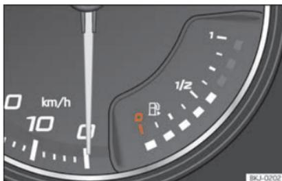
**Fig. 121** Quadro strumenti analogico: indicatore del livello del carburante
