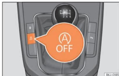
**Fig. 225** Console centrale: tasto del sistema Start/Stop.
