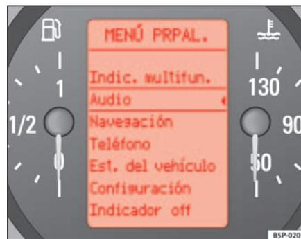
Fig. 44 Afficheur numérique du combiné d'instruments : Menu principal
