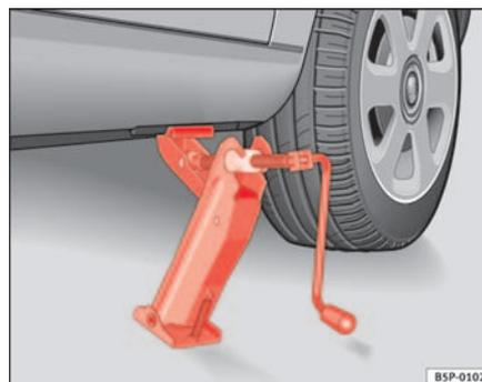
Fig. 174 Mise en place du cric
