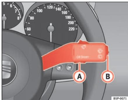
Fig. 41 Levier d'essuie-glace et de lave-glace : touche A et commande à bascule B
