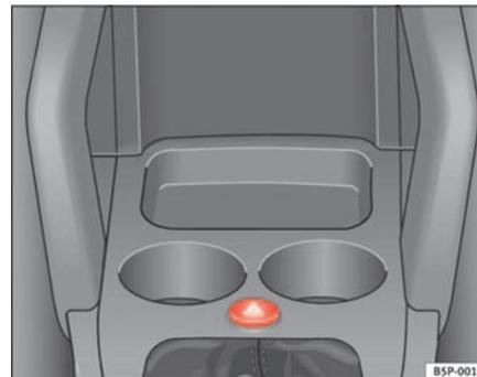
Fig. 76 Tableau de bord : touche d'activation du signal de détresse.
