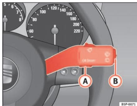
Fig. 45 Levier d'essuie-glace/ de lave-glace : la touche A sert à confirmer les options du menu et la commande à bascule B permet de changer de menu
