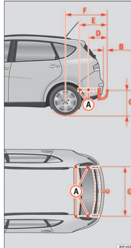
Fig. 155 Points de fixation du dispositif d'attelage
