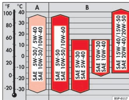
Fig. 159 Types d'huile en fonction de la température
