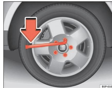
**Fig. 172** Changement d'une roue : desserrer les boulons de roue
