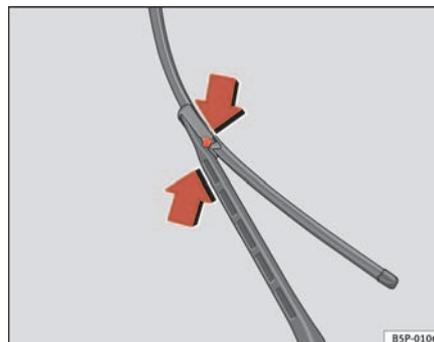
Fig. 165 Remplacement des balais d'essuie-glace avant
