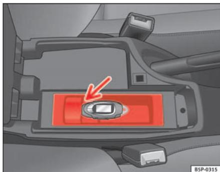
Fig. 119 Connexion USB\* dans l'accoudoir central
