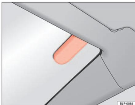
Fig. 85 Capteur de pluie\*
