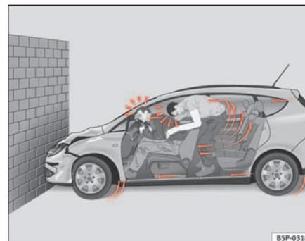
**Fig. 8 Le véhicule heurte le mur : les occupants n'ont pas attaché leur ceinture**
