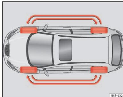
Fig. 169 Schéma de permutation des roues
