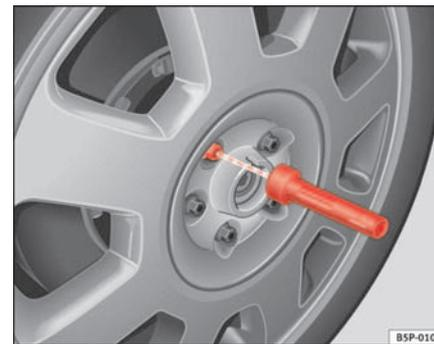
**Fig. 175** Changement d'une roue : Outil à six pans creux pour tourner les boulons
