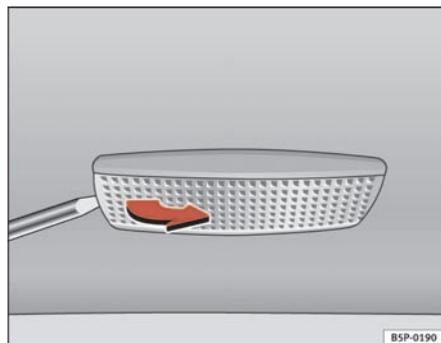
Fig. 196 Démontage de l'éclairage du pare-soleil
