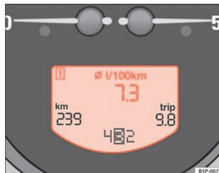
Fig. 40 Afficheur numérique du combiné d'instruments : indicateur de consommation moyenne de carburant
