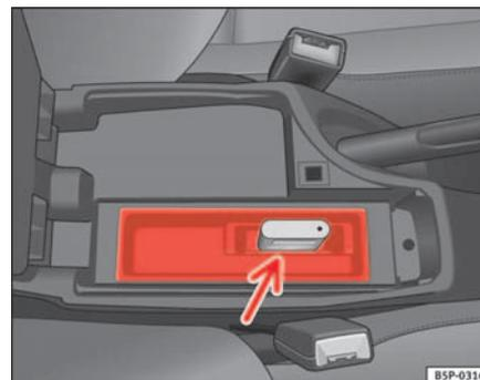
Fig. 118 Connexion de l'iPod dans l'accoudoir central
