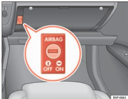
Fig. 26 Dans la boîte à gants se trouve la commande à clé pour activer et désactiver l'airbag du passager
