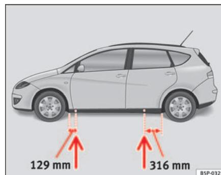
Fig. 173 Points d'appui du cric
