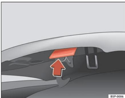
Fig. 158 Gâchette d'ouverture du capot-moteur.
