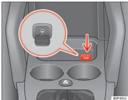
Fig. 117 Connecteur pour l'entrée auxiliaire audio
