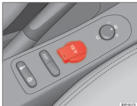
Fig. 115 Prise de courant sur la console centrale avant
