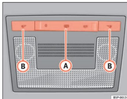
Fig. 81 Revêtement intérieur du toit : Lampes de lecture avant type 2
