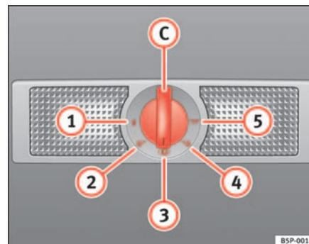
Fig. 82 Revêtement intérieur du toit : plafonnier et lampes de lecture arrière.
