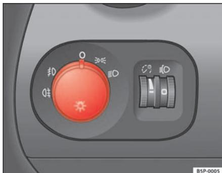
Fig. 73 Vue partielle du tableau de bord : commande des feux, feux antibrouillards avant et arrière
