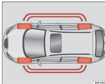
**Abb. 174** Schema für das Tauschen der Räder
