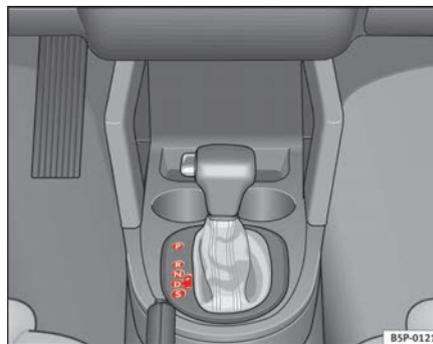
Abb. 140 Ausschnitt aus der Mittelkonsole: Wählhebel vom Automatikgetriebe / Direktschaltgetriebe DSG
