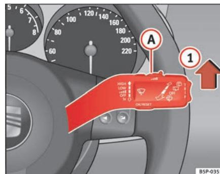
Abb. 88 Scheibenwischerhebel
