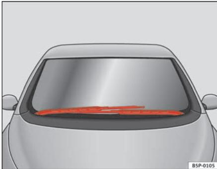
Abb. 169 Scheibenwischer in Service-Stellung
