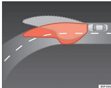
Abb. 76 Beleuchtung der Kurve mit automatisch gerichteten Scheinwerfern
