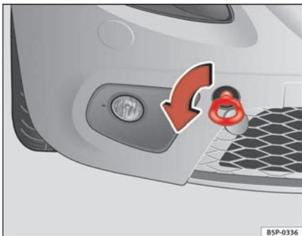
Abb. 207 Vordere Abschleppöse bei Fahrzeugen mit Allradantrieb
