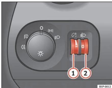
Abb. 75 Ausschnitt aus der Instrumententafel: Regler für die Instrumenten-/Schalterbeleuchtung und Leuchtweitenregulierung
