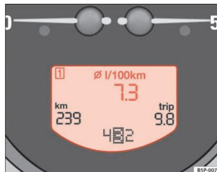
Abb. 40 Display im Kombiinstrument: Anzeige des durchschnittlichen Kraftstoffverbrauchs
