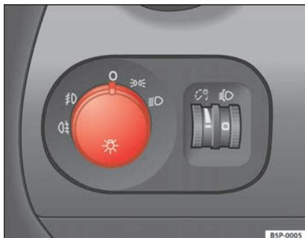
Abb. 73 Ausschnitt aus der Instrumententafel: Schalter für Licht, Nebelscheinwerfer und Nebelschlussleuchte
