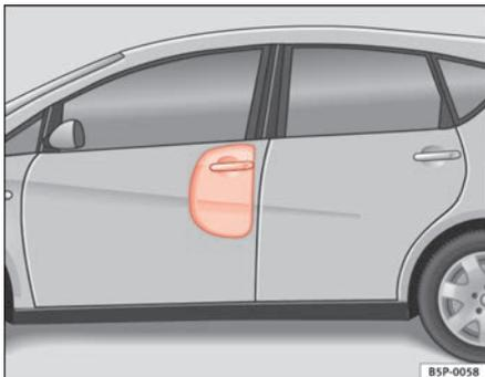
**Abb. 23** Aufgeblasener Seitenairbag auf der linken Fahrzeugseite
