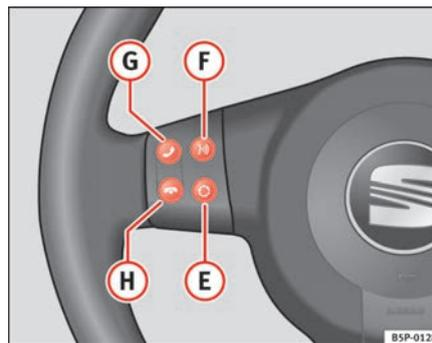
Abb. 52 Lenkradschalter
