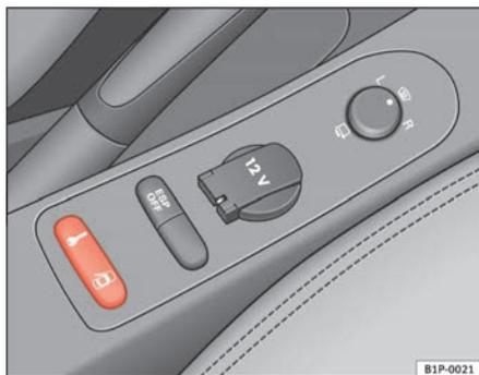
Abb. 60 Ausschnitt der Mittelkonsole: Zentralverriegelungstaster
