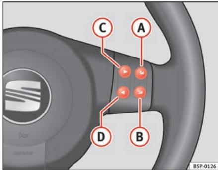
Abb. 49 Lenkradschalter
