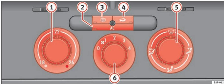
Abb. 131 In der Instrumententafel: Bedienelemente der Climatic
