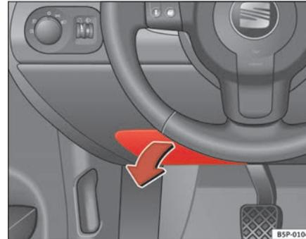
Abb. 183 Links in der Instrumententafel: Abdeckung des Sicherungskastens
