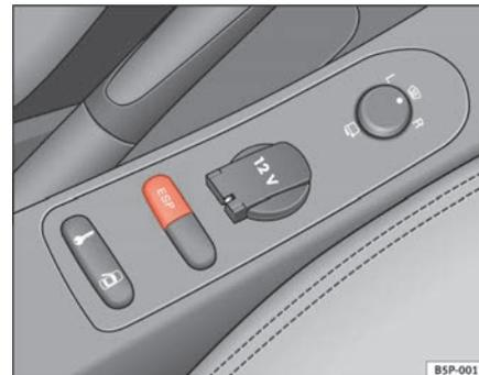
Abb. 136 Ausschnitt aus der Mittelkonsole: ESP-Taste
