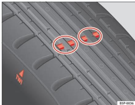
**Abb. 173** Prinzipdarstellung Reifenprofil: Verschleißanzeiger
