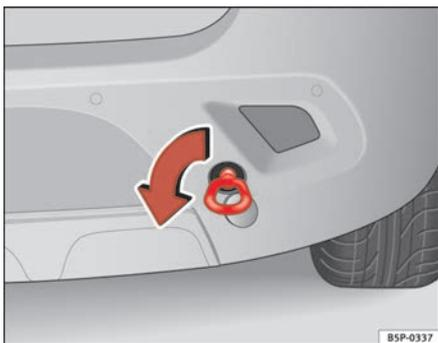
Abb. 208 Hintere Abschleppöse bei Fahrzeugen mit Allradantrieb
