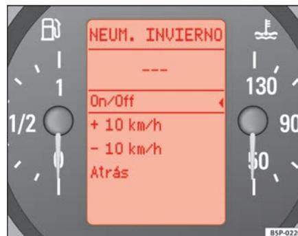
Abb. 46 Display im Kombiinstrument: Anzeige Winterreifen
