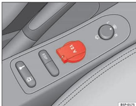
Abb. 118 Steckdose an der Mittelkonsole vorne
