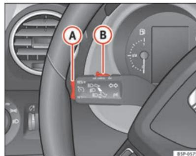
Fig. 156 Alavanca das luzes indicadoras de mudança de direcção e dos máximos: comando botão basculante para o regulador de velocidade ▶
