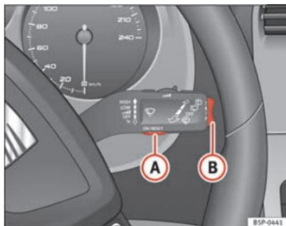
Fig. 47 Alavanca do limpa-vidros (MFA): botão A para confirmar opções do menu e botão basculante B para mudar de menu
