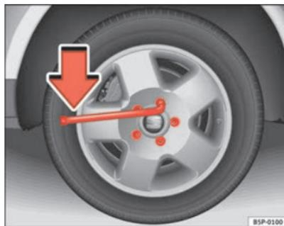
**Fig. 178** Substituição de pneu: desapertar os parafusos da roda
