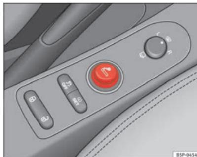
Fig. 118 Isqueiro alojado na tomada de corrente da consola central dianteira
