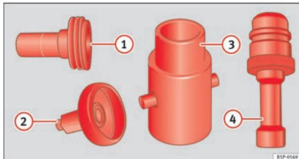
Fig. 163 Quadro geral dos adaptadores para o bocal de enchimento de GPL.
