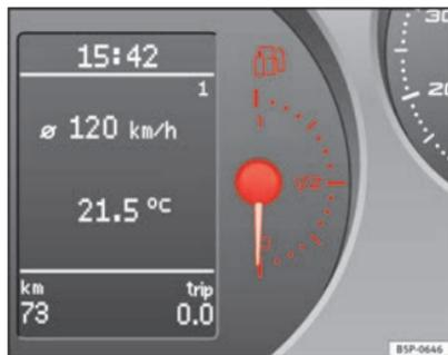
Fig. 37 Painel de instrumentos: indicador do nível de gás.
