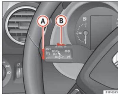
Fig. 157 Alavanca das luzes indicadoras de mudança de direcção e dos máximos: comando e botão basculante para o regulador de velocidade
