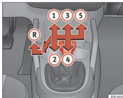
Fig. 143 Pormenor da consola central: esquema de uma caixa de velocidades manual de 5 velocidades
