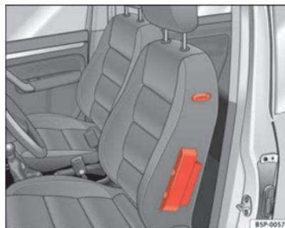
**Fig. 22** Airbag lateral no banco do condutor
