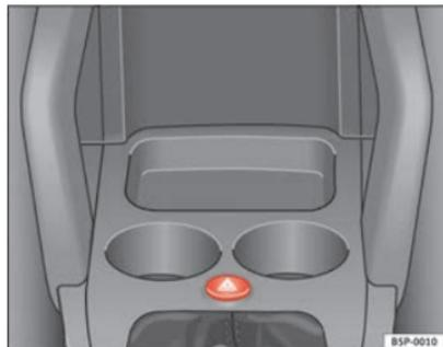
Fig. 77 Painel de instrumentos: comutador das luzes de emergência
