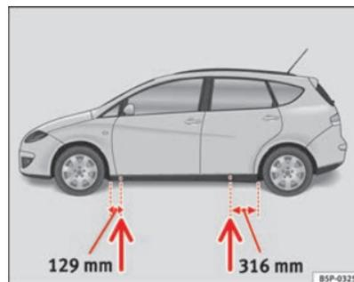
Fig. 179 Pontos de recepção do macaco
