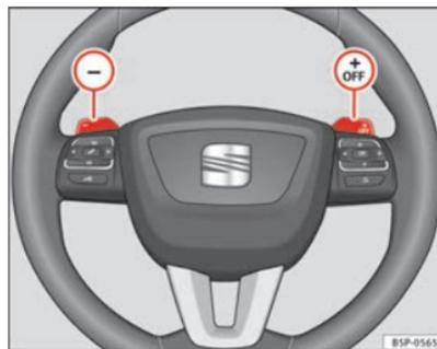
**Fig. 150** Volante com patilhas para a caixa de velocidades automática ▶
