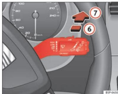
Fig. 89 Manípulo do limpa/lava-vidros: limpa-vidros traseiro
