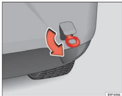
Fig. 208 Aparafusar a argola de reboque na parte traseira do veículo
