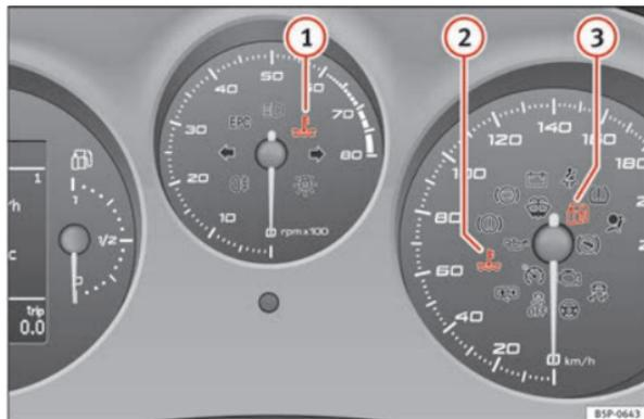
Fig. 51 Avisos de controlo e de advertência do painel de instrumentos em veículos com GPL.
