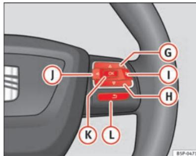
Fig. 56 Comandos no volante (em função da versão do modelo)
