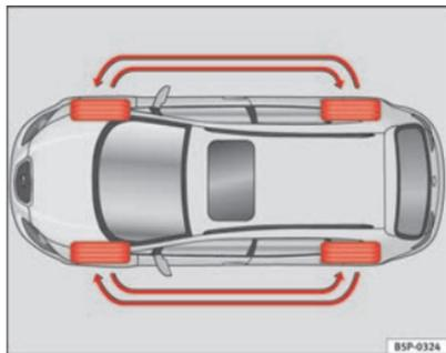
**Fig. 175** Esquema de troca dos pneus
