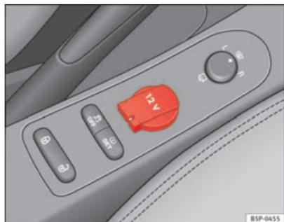
Fig. 119 Tomada de corrente na consola central dianteira
