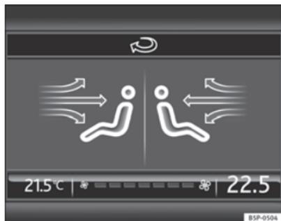
Fig. 133 Visor do navegador com informação do Climatronic
