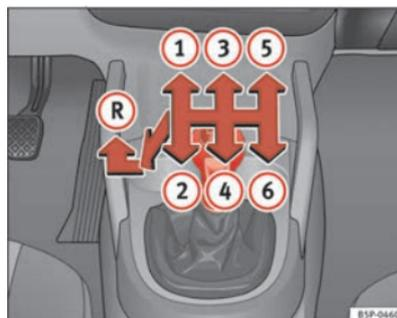
Fig. 144 Pormenor da consola central: esquema de uma caixa de velocidades manual de 6 velocidades
