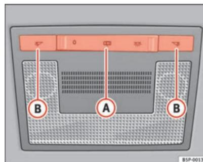
Fig. 80 Revestimento interior do tejadilho: iluminação dianteira do habitáculo
