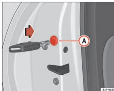
Fig. 60 Fecho de emergência das portas
