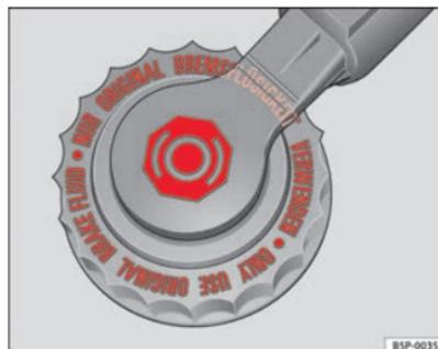
**Fig. 173 Tampão do reservatório do líquido dos travões no compartimento do motor**
