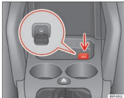
Fig. 121 Conector para a entrada auxiliar de áudio
