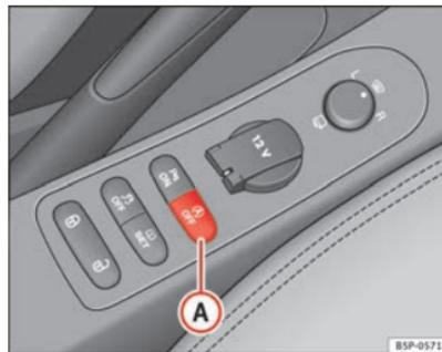
**Fig. 141** Pormenor do botão do funcionamento Start-Stop.
