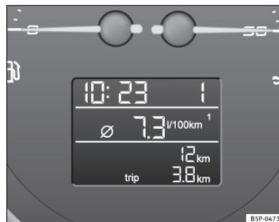
Fig. 42 Visor digital do painel de instrumentos ▶
