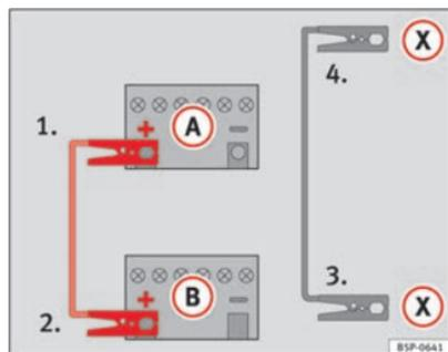
Fig. 206 Esquema para ligar os cabos de emergência no caso do veículo que fornece a corrente dispor do sistema Start-Stop: bateria descarregada (A) e bateria que fornece a corrente (B).
