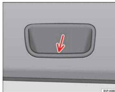
Fig. 67 Pormenor do revestimento interior da porta da bagageira: reentrância para puxar
