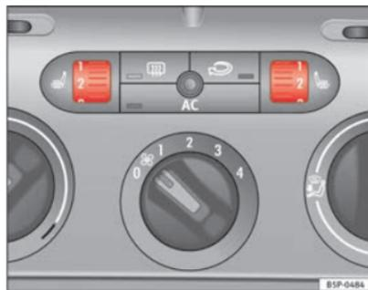
**Fig. 96** Rodas recartilhadas do aquecimento dos bancos dianteiros
