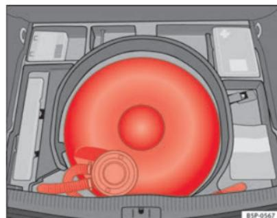
Fig. 162 Depósito de GPL na cavidade do pneu suplente.
