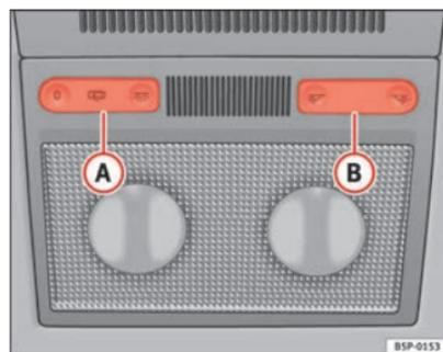
Fig. 79 Revestimento interior do tejadilho: iluminação dianteira do habitáculo
