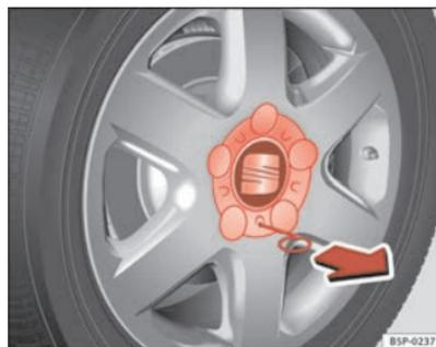
Fig. 177 Substituição de pneu: Retirar o embelezador da roda
