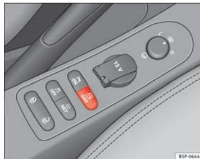
Fig. 140 Consola central: comutador de controlo do sistema de gás.
