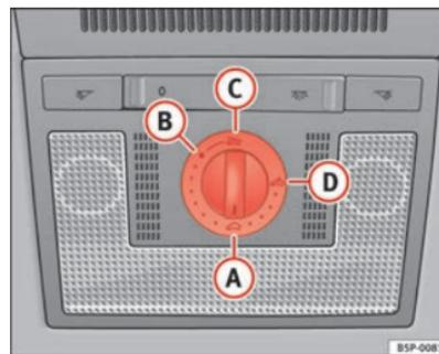
Fig. 71 Pormenor do revestimento interior do tejadilho: comando giratório do tecto de abrir / deflector
