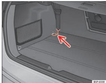
Fig. 127 Argolas de fixação para tensar a rede de separação
