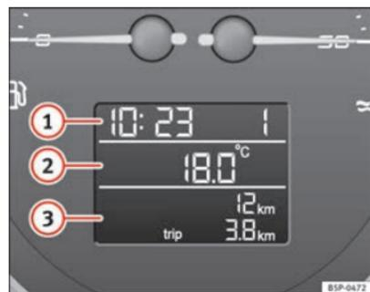
Fig. 38 Pormenor do painel de instrumentos: visor com diferentes indicadores
