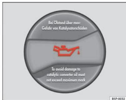
**Fig. 167** Tampão do bocal de enchimento do óleo do motor no compartimento do motor
