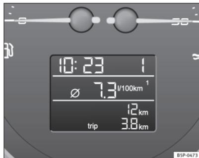
Fig. 44 Visor digital do painel de instrumentos: indicador consumo médio de combustível.
