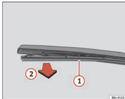
Fig. 172 Substituição da escova do limpa-vidros traseiro
