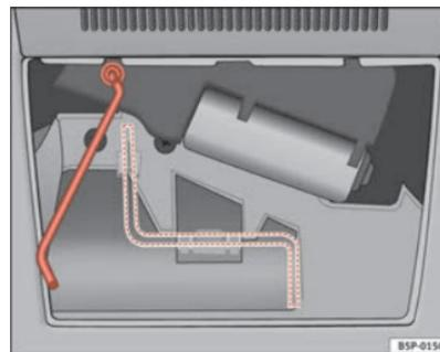
Fig. 72 Manivela de fecho de emergência
