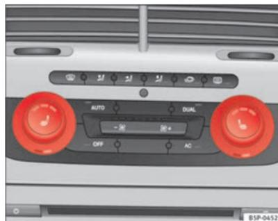
**Fig. 97** Calefacción asientos delanteros con Climatronic
