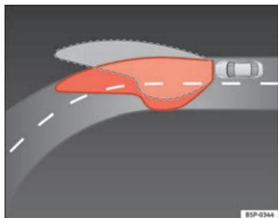
Fig. 76 Iluminación de la curva con faros autodireccionables
