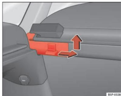
Fig. 125 Desmontaje de la bandeja portaobjetos
