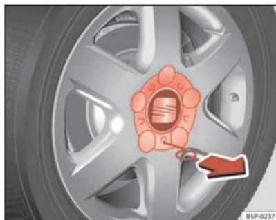
**Fig. 177** Cambio de rueda: Retirar el embellecedor de la rueda
