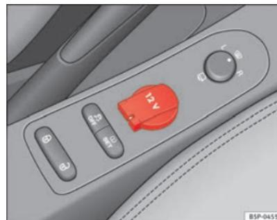
Fig. 119 Toma de corriente en consola central delantera
