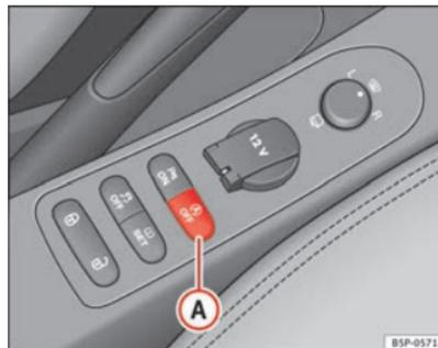
Fig. 141 Detalle del pulsador del funcionamiento Start-Stop.
