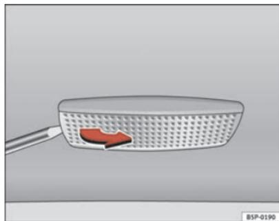
Fig. 203 Desmontaje luz del parasol
