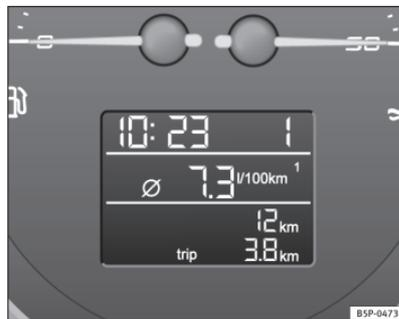
Fig. 44 Pantalla digital del cuadro de instrumentos: indicador consumo medio de combustible.
