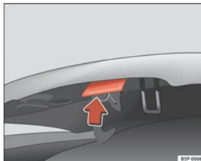
**Fig. 165** Gancho apertura capó motor.
