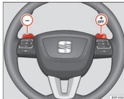
Fig. 150 Volante con palancas para cambio automático
