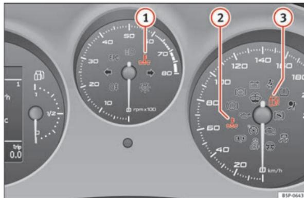
Fig. 51 Testigos de control y de advertencia del cuadro de instrumentos en vehículos con GLP.
