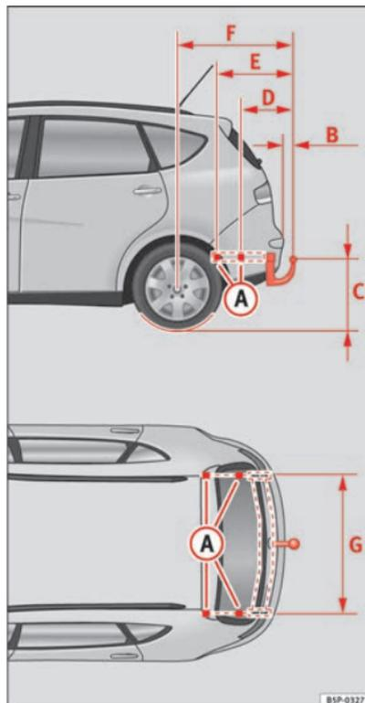
Fig. 159 Puntos de fijación del dispositivo de remolque
