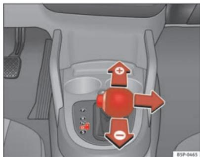
Fig. 149 Cambiar con tiptronic
