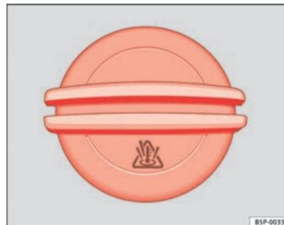
Fig. 168 Tapón del depósito de expansión del líquido refrigerante en el vano motor
