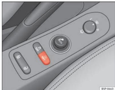
Fig. 52 Consola central: tecla del sistema de control de los neumáticos
