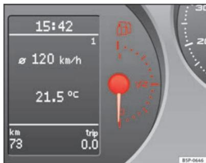
Fig. 37 Cuadro de instrumentos: indicador del nivel de gas.
