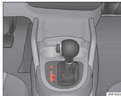
Fig. 145 Consola central: palanca selectora del cambio automático / cambio automático DSG
