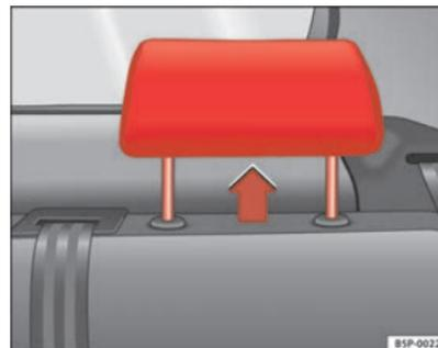
Fig. 5 Apoyacabezas en posición de uso
