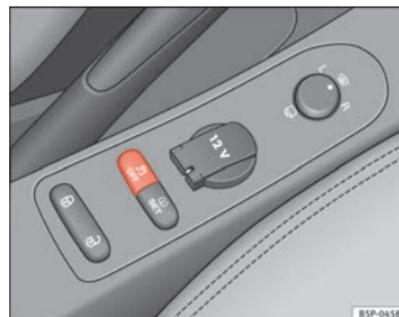
**Fig. 138** Detalle de la consola central: tecla ESP
