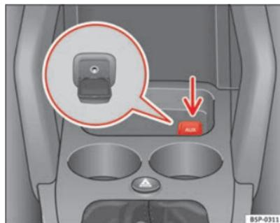
Fig. 121 Conector para la entrada auxiliar de audio
