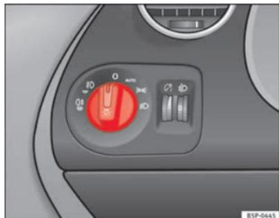
Fig. 74 Encendido automático de luces
