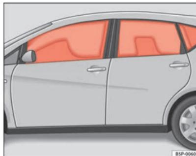
**Fig. 25 Airbags para la cabeza inflados**
