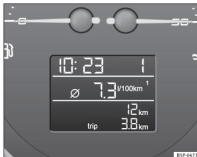
Fig. 42 Pantalla digital del cuadro de instrumentos
