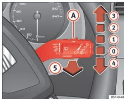
Fig. 86 Palanca del limpia-lavacristales
