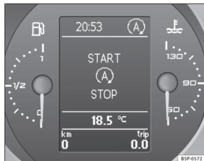
Fig. 142 Indicación en la pantalla del cuadro de instrumentos durante el funcionamiento Start-Stop.
