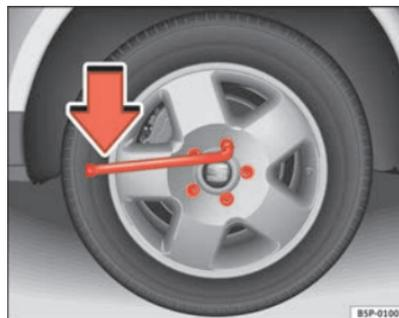
Fig. 178 Cambio de rueda: aflojar los tornillos de rueda
