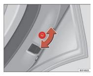
Fig. 62 Childproof lock on the right hand side door
