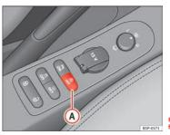
Fig. 141 The Start-Stop function button.
