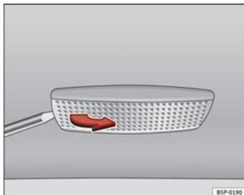
Fig. 202 Desmontagem da luz da pala de sol
