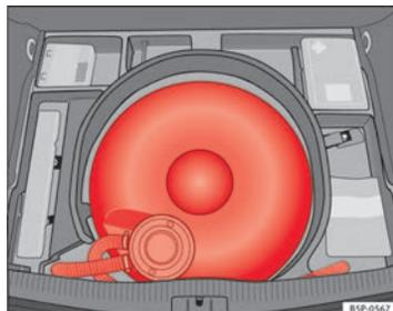
Fig. 161 Depósito de GPL na cavidade do pneu suplente.
