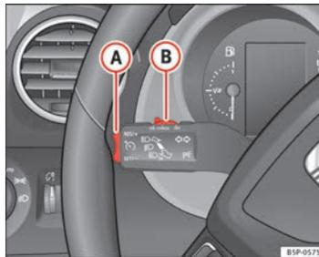
Fig. 156 Alavanca das luzes indicadoras de mudança de direcção e dos máximos: comando e botão basculante para o regulador de velocidade ▶
