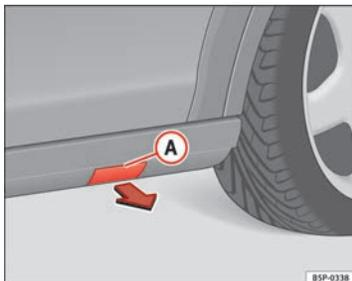
Fig. 181 Embaladeira de plástico com tampa para fixação do macaco
