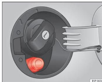
Fig. 163 Tampa do depósito aberta com porca de tipo EURO.
