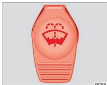
**Fig. 169** Tampa do reservatório do limpa-vidros no compartimento do motor.
