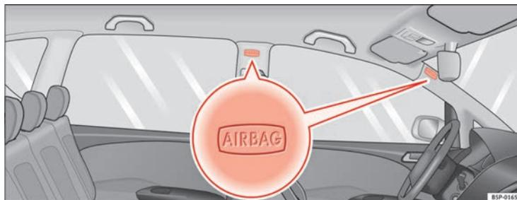
Fig. 24 Localização de montagem dos airbags da cabeça do lado esquerdo do veículo
