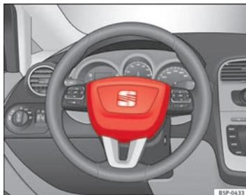
**Fig. 18 Airbag do condutor no volante**
