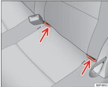
Fig. 31 Anéis de fixação ISOFIX
