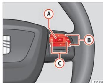
Fig. 46 Comandos no volante: botão A para confirmar opções do menu e botão B para mudar de menu
