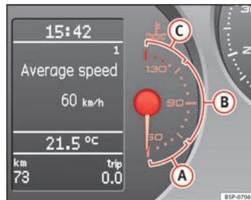
Fig. 36 Painel de instrumentos: indicador da temperatura do líquido de refrigeração do motor
