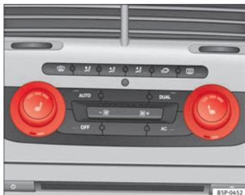
**Fig. 96 Aquecimento dos bancos dianteiros com Climatronic**
