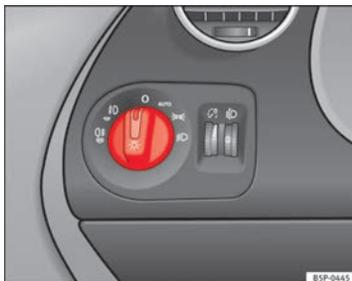
Fig. 72 Pormenor do painel de instrumentos: comando das luzes, faróis de nevoeiro e luz de nevoeiro traseira
