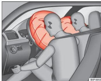
**Fig. 20 Airbags frontais insuflados**
