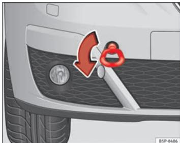
Fig. 206 Enroscamento da argola de reboque na parte dianteira direita do veículo
