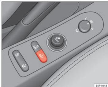
**Fig. 52 Consola central: botão do sistema de controlo dos pneus**
