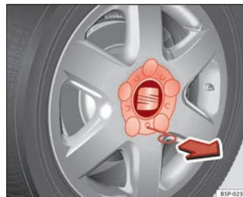
Fig. 177 Substituição de pneu: Retirar o embelezador da roda
