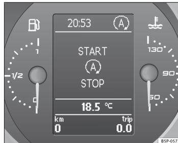
Fig. 141 Indicação no visor do painel de instrumentos durante o funcionamento Start-Stop.
