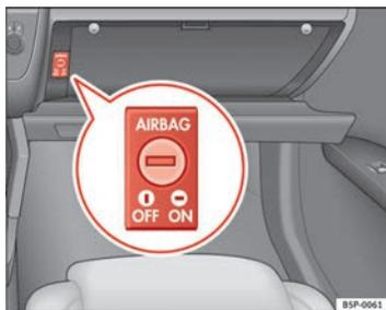
Fig. 26 No porta-luvas: comutador com chave para activar e desactivar o airbag do passageiro
