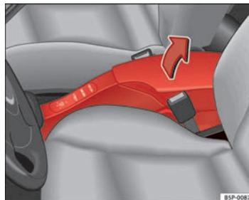
Fig. 102 Apoio de braços dianteiro com porta-objectos
