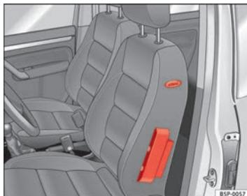
**Fig. 22 Airbag lateral no banco do condutor**
