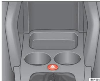
Fig. 76 Painel de instrumentos: interruptor das luzes de emergência
