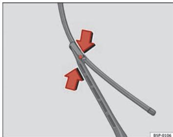
Fig. 171 Substituição das escovas do limpa pára-brisas
