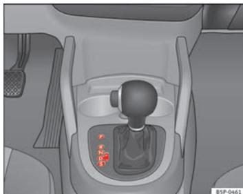
Fig. 144 Consola central: alavanca selectora da caixa de velocidades automática / caixa de velocidades automática DSG
