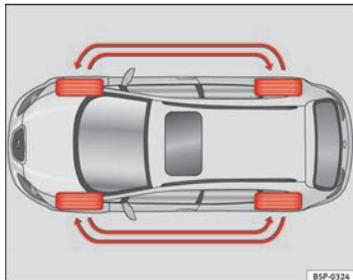
**Fig. 175** Esquema de troca dos pneus
