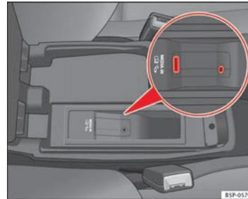
Fig. 122 Ligação no apoio de braços central
