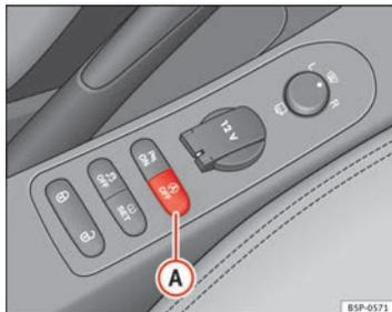
Fig. 140 Pormenor do botão do funcionamento Start-Stop.
