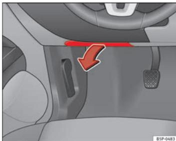
**Fig. 183** Tampa da caixa dos fusíveis no lado esquerdo do painel de instrumentos
