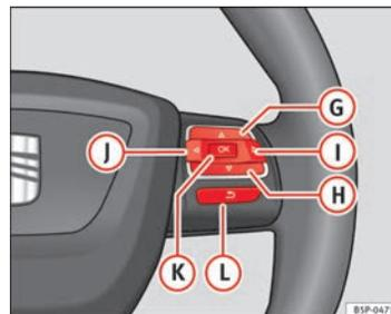
Fig. 58 Comandos no volante (em função da versão do modelo)
