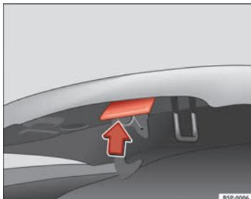
**Fig. 165** Gancho de abertura do capot do motor.
