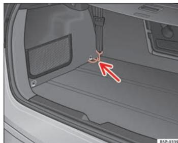
**Fig. 126** Argolas de fixação para tensar a rede de separação ▶
