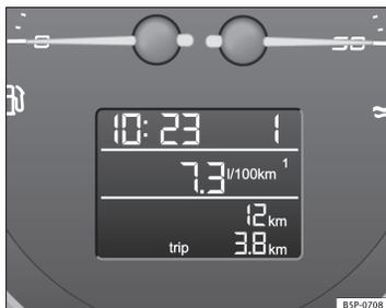
Fig. 44 Visor digital do painel de instrumentos: indicador consumo médio de combustível.
