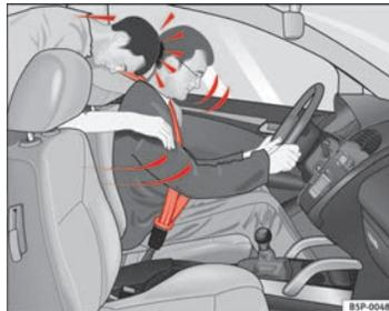
**Fig. 10 O passageiro do banco traseiro que não tiver colocado o cinto de segurança é projectado para a frente, para cima do condutor que tem o cinto colocado.**
