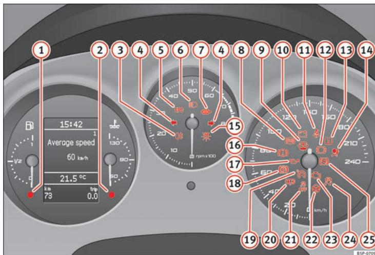
Fig. 50 Painel de instrumentos com luzes avisadoras e de advertência. Algumas das luzes aqui apresentadas só são montadas em determinados modelos ou fazem parte de equipamentos opcionais. ▶
