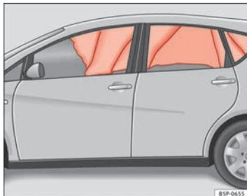
Fig. 25 Airbags da cabeça activados
