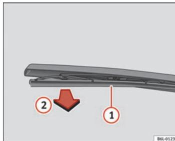
Fig. 172 Substituição da escova do limpa-vidros traseiro
