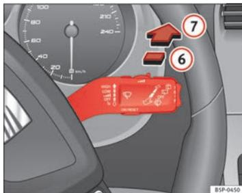
**Fig. 88** Manípulo do limpa/lava-vidros: limpa-vidros traseiro
