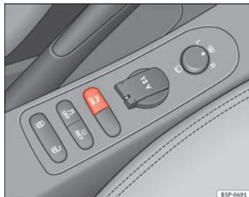
Fig. 151 Consola central: Interruptor de auxílio de estacionamento
