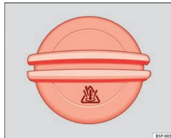
Fig. 168 Tampão do reservatório de expansão do líquido de refrigeração no compartimento do motor
