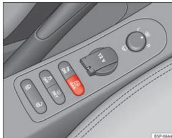
Fig. 139 Consola central: comutador de controlo do sistema de gás.
