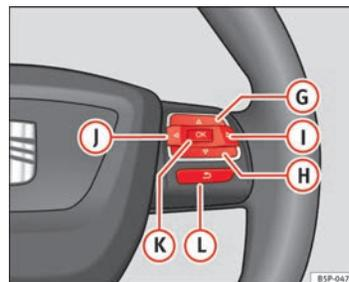
Fig. 56 Comandos no volante (em função da versão do modelo)
