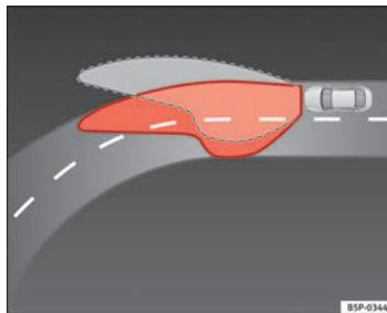
Fig. 75 Iluminação da curva com faróis auto-direccionáveis
