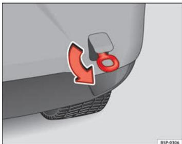
Fig. 207 Aparafusar a argola de reboque na parte traseira do veículo
