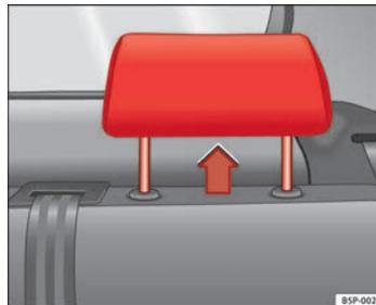
Fig. 5 Encostos de cabeça em posição de utilização
