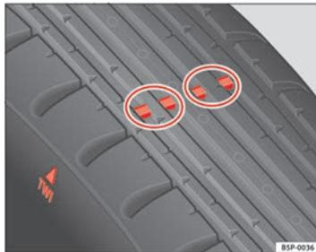
**Fig. 174** Indicadores de desgaste no perfil do pneu
