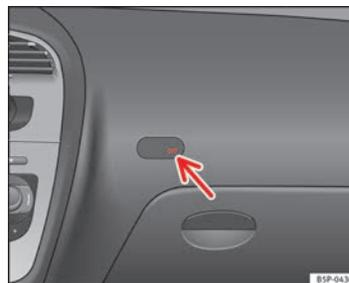
Fig. 27 Aviso de controlo da desactivação do airbag do passageiro
