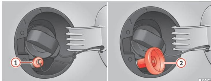
Fig. 160 Tampa do depósito aberta com bocal de enchimento de GPL e adaptador.
