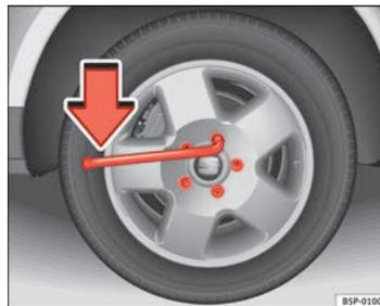
**Fig. 178** Substituição de pneu: desapertar os parafusos da roda
