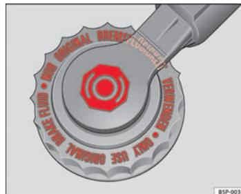
Fig. 173 Tampão do reservatório do líquido dos travões no compartimento do motor
