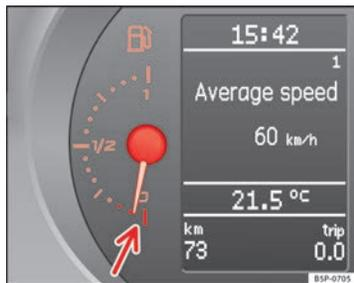
Fig. 35 Painel de instrumentos: indicador do nível do depósito de combustível
