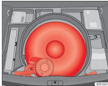
Fig. 161 Depósito de GLP en la cavidad de la rueda de repuesto.
