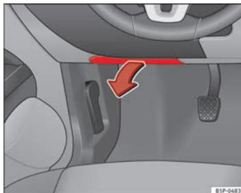
Fig. 183 Tapa de la caja de fusibles en el lado izquierdo del tablero de instrumentos
