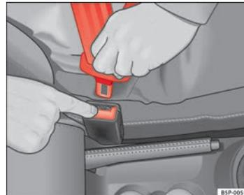
Fig. 16 Retirar la lengüeta del cierre del cinturón ▶
