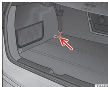
Fig. 126 Argollas de amarre para tensar la red separadora
