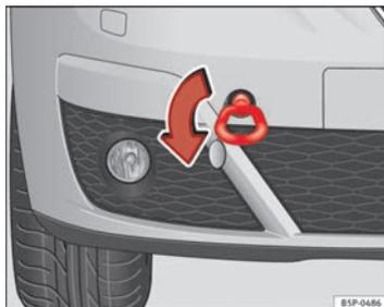
Fig. 206 Atornillado de la argolla de remolque en la parte delantera derecha del vehículo
