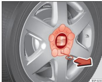
**Fig. 177** Cambio de rueda: Retirar el embellecedor de la rueda
