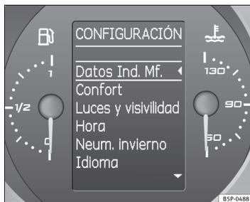
Fig. 49 Pantalla del cuadro de instrumentos indicador multifunción (MFA).
