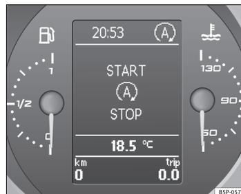
Fig. 141 Indicación en la pantalla del cuadro de instrumentos durante el funcionamiento Start-Stop.
