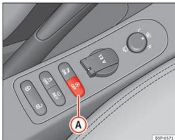
Fig. 140 Detalle del pulsador del funcionamiento Start-Stop.
