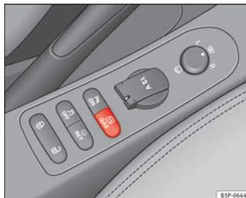
Fig. 139 Consola central: conmutador de control del sistema de gas.
