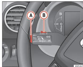
Fig. 154 Palanca de intermitentes y de luz de carretera: mando y tecla basculante para el regulador de velocidad
