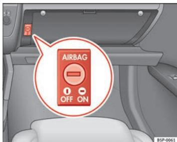
Fig. 26 En la guantera: conmutador con llave para activar y desactivar el airbag del acompañante
