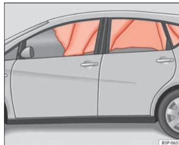
**Fig. 25** Airbags para la cabeza inflados
