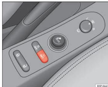
**Fig. 52** Consola central: tecla del sistema de control de los neumáticos
