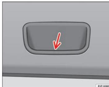
Fig. 67 Detalle del guardanido interior del portón trasero: cavidad para tirar
