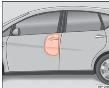
**Fig. 23** Airbag lateral inflado en el lado izquierdo del vehículo
