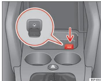
Fig. 120 Conector para la entrada auxiliar de audio
