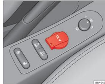
Fig. 118 Toma de corriente en consola central delantera
