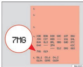
Fig. 157 Portadatos del vehículo en reverso de la tapa del Programa de Mantenimiento
