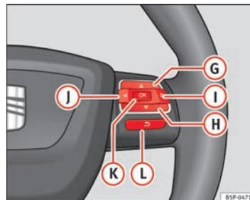
Fig. 58 Mandos en el volante (en función de la versión del modelo)
