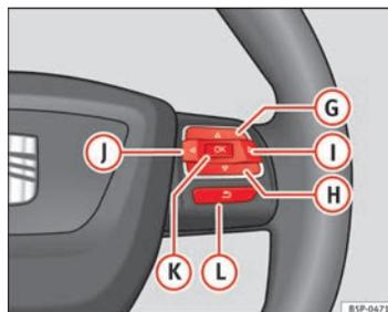
Fig. 56 Mandos en el volante (en función de la versión del modelo)
