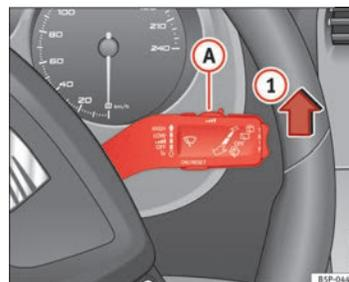
Fig. 87 Palanca del limpiaparabrisas ▶
