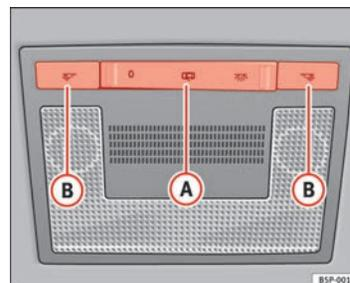
Fig. 81 Revestimiento interior del techo: luces delanteras de lectura tipo 2
