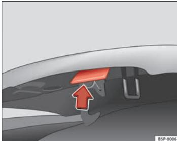
Fig. 165 Gancho apertura capó motor.
