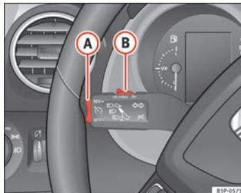
Fig. 156 Palanca de intermitentes y de luz de carretera: mando y tecla basculante para el regulador de velocidad
