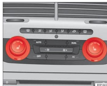
Fig. 96 Calefacción asientos delanteros con Climatronic
