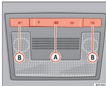
Fig. 79 Revestimiento interior del techo: iluminación delantera del habitáculo
