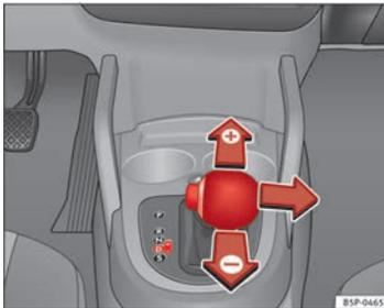
Fig. 148 Cambiar con tiptronic
