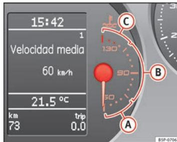
Fig. 36 Cuadro de instrumentos: indicador de la temperatura del líquido refrigerante del motor
