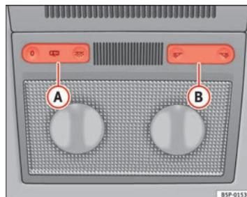
Fig. 80 Revestimiento interior del techo: luces delanteras de lectura tipo 1
