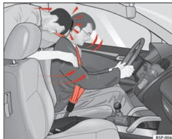
**Fig. 10 El ocupante del asiento trasero que no lleve puesto el cinturón de seguridad se verá lanzado hacia adelante sobre el conductor que sí lleva el cinturón.**
