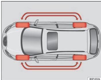
**Fig. 175** Esquema para el cambio de ruedas
