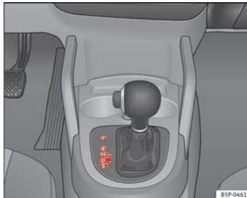
Fig. 144 Consola central: palanca selectora del cambio automático / cambio automático DSG
