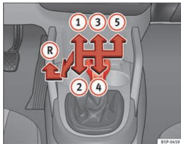
Fig. 142 Detalle de la consola central: esquema de un cambio manual de 5 marchas
