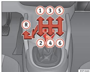
Fig. 143 Detalle de la consola central: esquema de un cambio manual de 6 marchas
