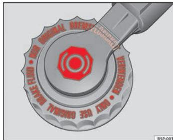
Fig. 173 Tapón del depósito del líquido de frenos en el vano motor
