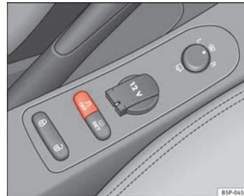
Fig. 137 Detalle de la consola central: tecla ESC.
