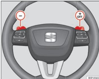
Fig. 149 Volante con palancas para cambio automático
