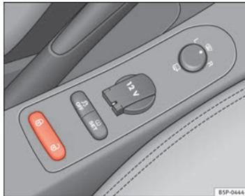
Fig. 59 Detalle de la consola central: pulsador del cierre centralizado
