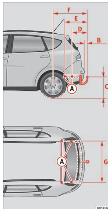
Fig. 158 Puntos de fijación del dispositivo de remolque
