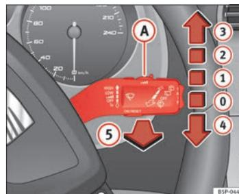
Fig. 85 Palanca del limpia-lavacristales
