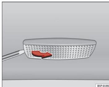
Fig. 202 Desmontaje luz del parasol
