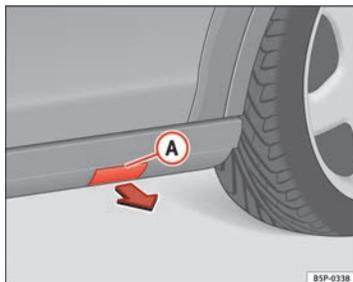
Fig. 181 Talonera de plástico con tapa para anclaje de gato
