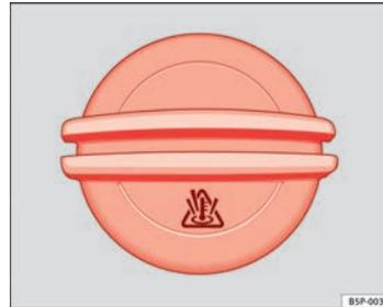
Fig. 168 Tapón del depósito de expansión del líquido refrigerante en el vano motor
