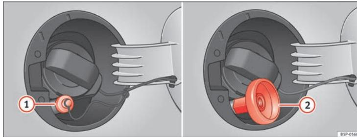
Fig. 160 Tapa del depósito abierta con boca de carga de GLP y adaptador.
