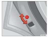
Fig. 61 Childproof lock on the left hand side door
