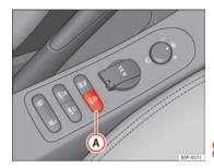
Fig. 140 The Start-Stop function button.
