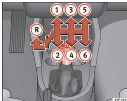
Fig. 139 Détail de la console centrale : grille des vitesses de la boîte mécanique à 6 vitesses
