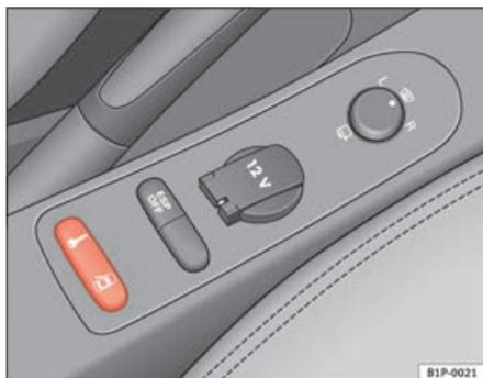
Fig. 60 Détail de la console centrale : Touche de verrouillage central
