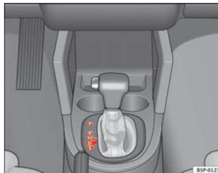
Fig. 140 Console centrale : levier sélecteur de la boîte automatique ou de la boîte DSG
