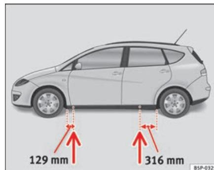
**Fig. 179** Points d'appui du cric.
