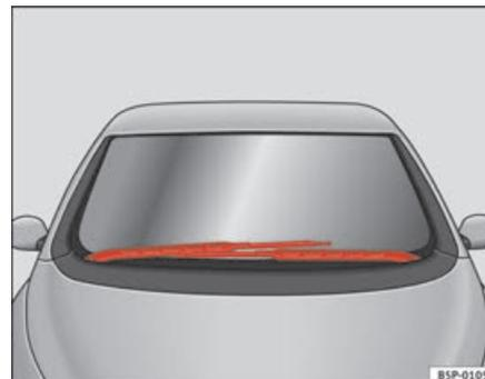
**Fig. 170** Essuie-glace en position de maintenance
