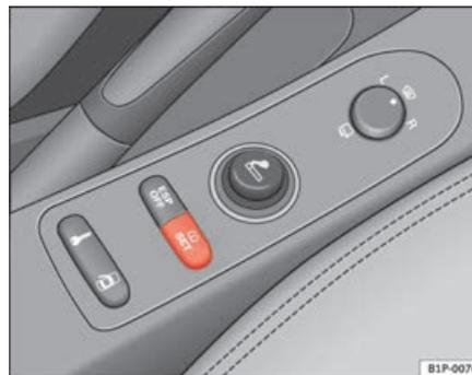
**Fig. 48** Console centrale : touche du système de contrôle des pneus
