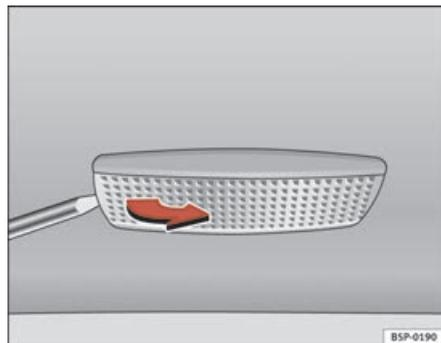
Fig. 203 Démontage de l'éclairage du pare-soleil
