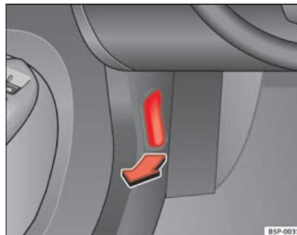
**Fig. 163** Détail du plancher côté conducteur : levier de déverrouillage du capot-moteur
