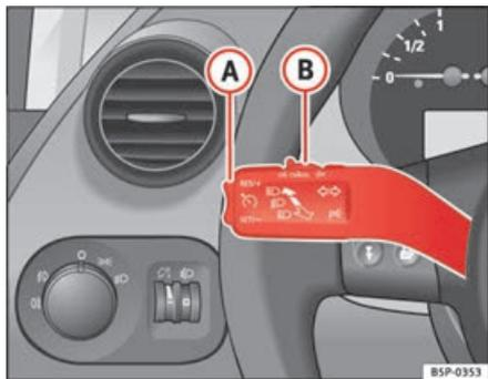
Fig. 150 Levier des clignotants et de l'inverseur-codes : contacteur et touche à bascule pour le régulateur de vitesse
