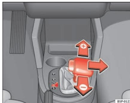
Fig. 144 Changement de vitesses avec la commande tiptronic
