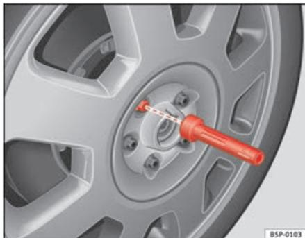
Fig. 182 Changement d'une roue : Outil à six pans creux pour tourner les boulons
