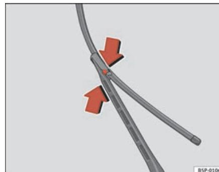
**Fig. 171** Remplacement des balais d'essuie-glace avant
