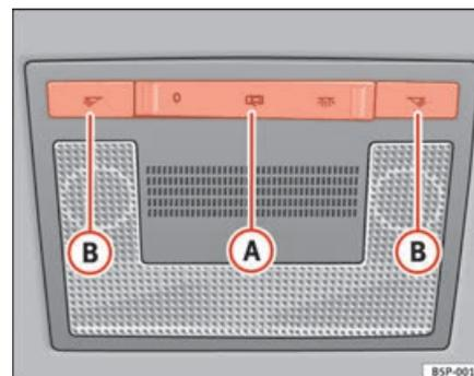
**Fig. 82** Revêtement intérieur du toit : Lampes de lecture avant type 2
