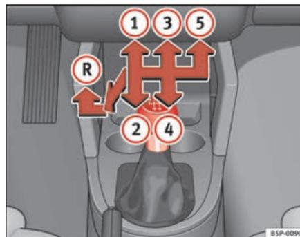
Fig. 138 Détail de la console centrale : grille des vitesses de la boîte mécanique à 5 vitesses
