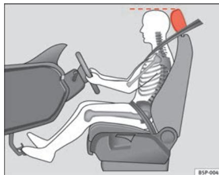
**Fig. 2** Réglage correct de l'appuie-tête du conducteur
