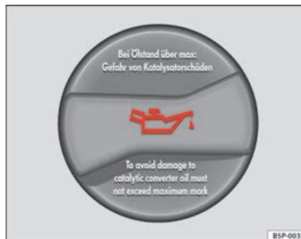
**Fig. 167 Dans le compartiment-moteur : bouchon de l'orifice de remplissage d'huile-moteur**
