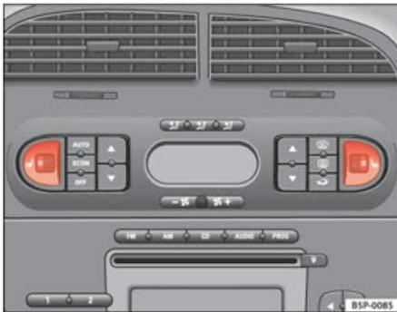
**Fig. 96** Molettes des chauffages de sièges avant
