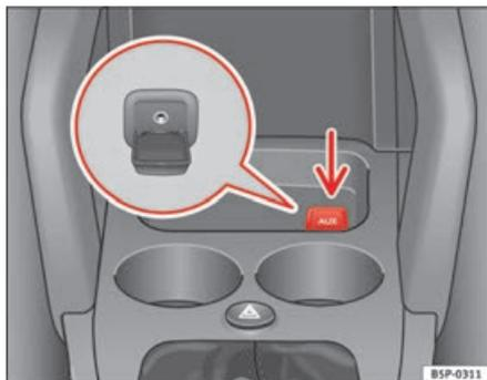
Fig. 120 Connecteur pour l'entrée auxiliaire audio
