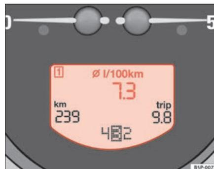
Fig. 42 Afficheur numérique du combiné d'instruments : indicateur de consommation moyenne de carburant.
