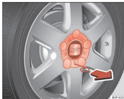
**Fig. 177** Changement d'une roue : Retirer l'enjoliveur de roue
