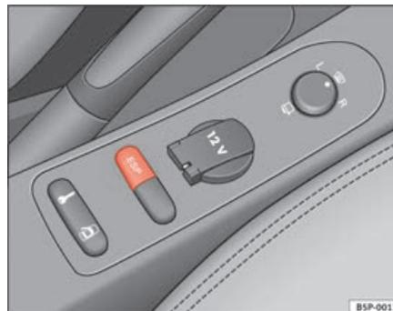
Fig. 136 Détail de la console centrale : touche ESP
