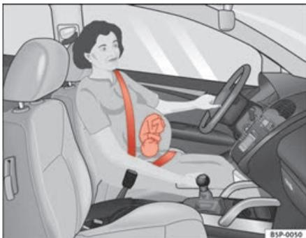
Fig. 15 Ajustement de la sangle recommandé pour les femmes enceintes
