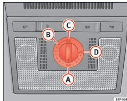
Fig. 71 Détail du revêtement intérieur du toit : commande rotative du toit ouvrant coulissant/relevable
