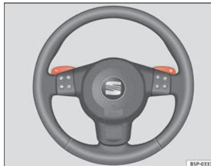
Fig. 145 Volant avec leviers pour BV automatique
