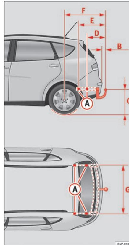
Fig. 161 Points de fixation du dispositif d'attelage
