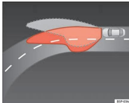
Fig. 76 Éclairage du virage à l'aide des phares autodirectionnels ▶
