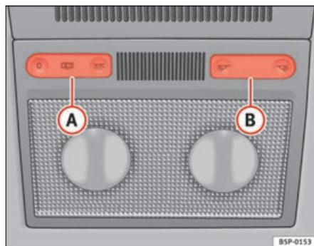
**Fig. 81** Revêtement intérieur du toit : Lampes de lecture avant type 1
