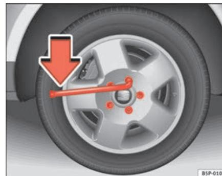
**Fig. 178** Changement d'une roue : desserrer les boulons de roue
