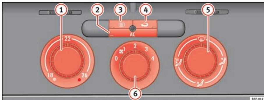
Fig. 131 Sur le tableau de bord : éléments de commande du Climatic
