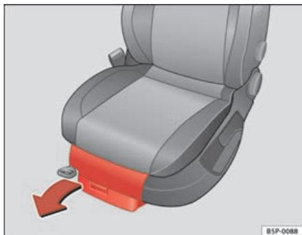
**Fig. 103** Rangements sous les sièges avant
