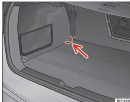
Fig. 127 Oeillets d'accrochage permettant de tendre le filet de séparation
