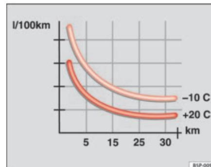
Fig. 160 Consommation de carburant (l/100 km) à deux températures ambiantes différentes. ▶
