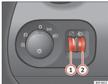
Fig. 75 Tableau de bord : Régulateurs d'éclairage des instruments et des commandes et du site des projecteurs
