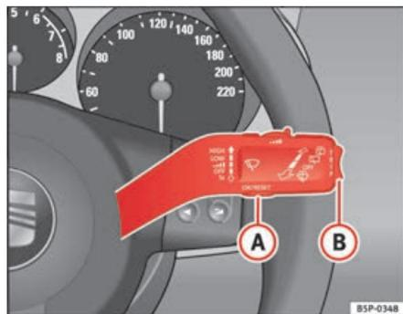
Fig. 39 Levier d'essuie-glace et de lave-glace : touche A et commande à bascule B
