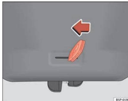
**Fig. 68** Capot arrière : ouverture d'urgence
