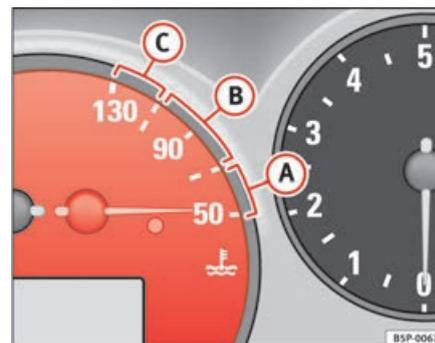
Fig. 35 Combiné d'instruments : indicateur de température de liquide de refroidissement du moteur
