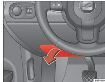
Fig. 184 A gauche dans le tableau de bord : cache de la boîte à fusibles
