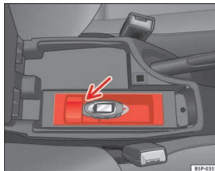
Fig. 123 Connexion USB\* dans l'accoudoir central
