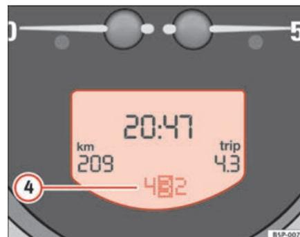
Fig. 37 Détail du combiné d'instruments : afficheur avec indicateur des rapports de la commande Tiptronic
