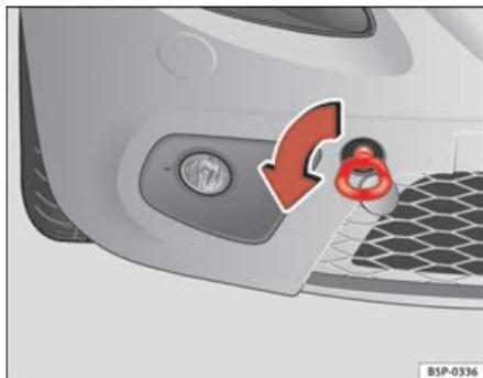
Fig. 208 Œillet de remorquage avant pour véhicules à transmission intégrale
