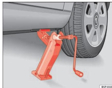
**Fig. 180** Mise en place du cric
