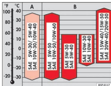
Fig. 165 Types d'huile en fonction de la température
