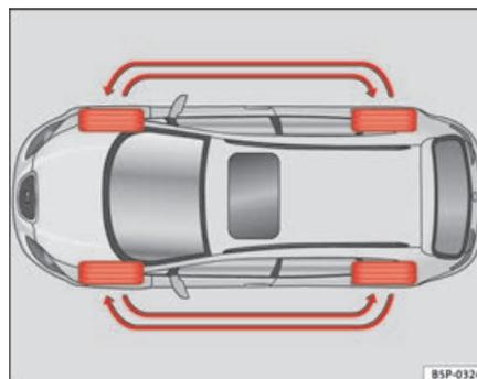
Fig. 175 Schéma de permutation des roues
