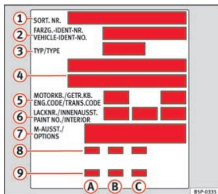
Fig. 210 Autocollant d'identification du véhicule - coffre à bagages
