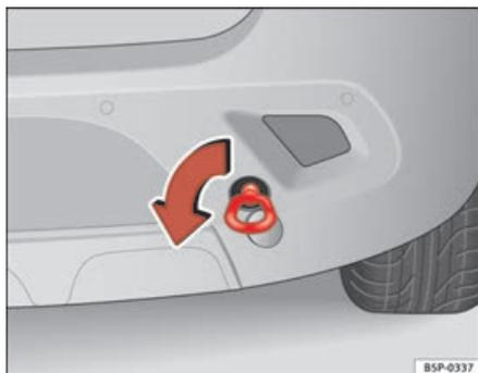
Fig. 209 Œillet de remorquage arrière pour véhicules à transmission intégrale
