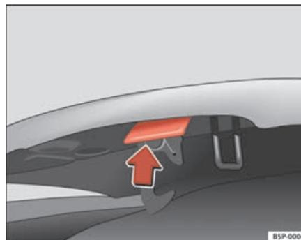
**Fig. 164** Gâchette d'ouverture du capot-moteur.
