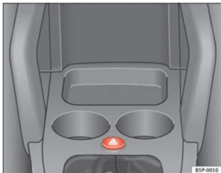
**Fig. 77** Tableau de bord : touche d'activation du signal de détresse.
