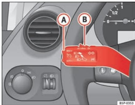
Fig. 151 Levier des clignotants et de l'inverseur-codes : contacteur et touche à bascule pour le régulateur de vitesse
