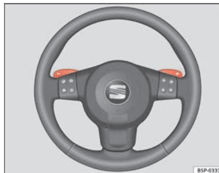
Abb. 145 Lenkrad mit Wippen für Automatikgetriebe
