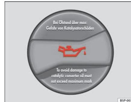
Abb. 167 Deckel der Motoröl-Einfüllöffnung im Motorraum
