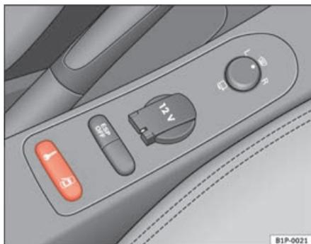
Abb. 60 Ausschnitt der Mittelkonsole: Zentralverriegelungstaster
