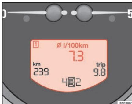
Abb. 42 Display im Kombiinstrument: Anzeige des durchschnittlichen Kraftstoffverbrauchs.
