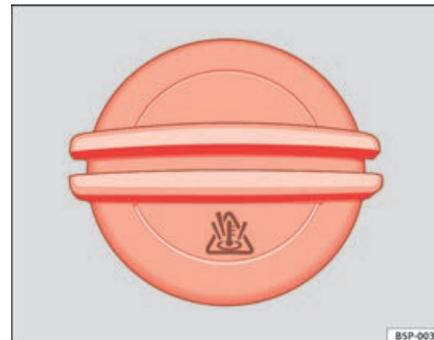
Abb. 168 Im Motorraum: Deckel des Kühlmittel-Ausgleichsbehälters
