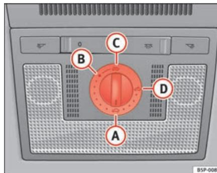
Abb. 71 Ausschnitt aus dem Dachhimmel: Drehschalter Schiebe-/Ausstelldach
