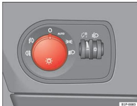
Abb. 74 Automatisches Fahrlicht
