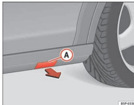
Abb. 181 Kunststoff-Trittleiste mit Deckel zur Aufnahme des Wagenhebers
