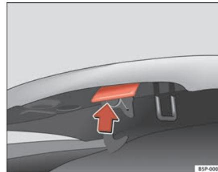
Abb. 164 Riegel der Motorraumklappe. ▶
