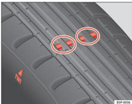
Abb. 174 Prinzipdarstellung Reifenprofil: Verschleißanzeiger
