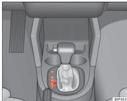
Abb. 140 Ausschnitt aus der Mittelkonsole: Wählhebel vom Automatikgetriebe / Direkt-Schalt-Getriebe
