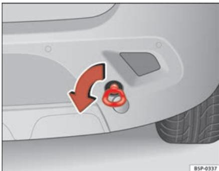
**Abb. 209** Hintere Abschleppöse bei Fahrzeugen mit Allradantrieb
