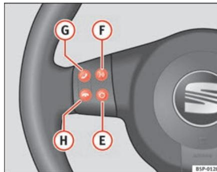
Abb. 52 Lenkradschalter
