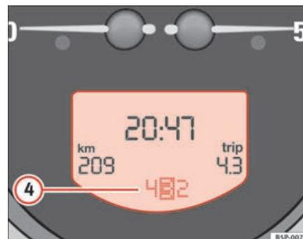
Abb. 37 Ausschnitt aus dem Kombiinstrument: Display mit Ganganzeige für Tiptronic
