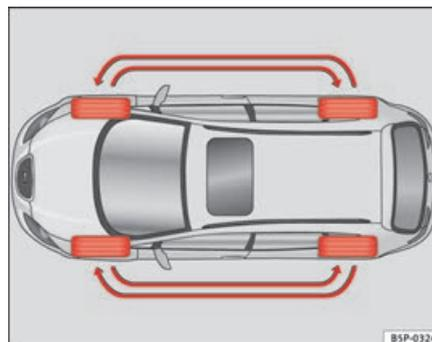
Abb. 175 Schema für das Tauschen der Räder
