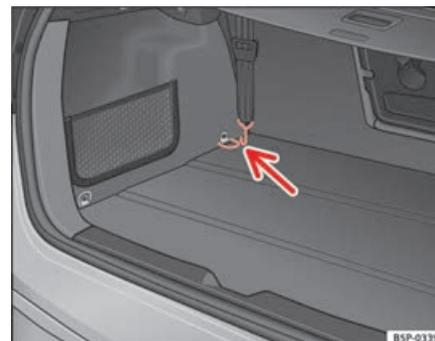
Abb. 127 Befestigungsösen zum Spannen des Gepäckraumnetzes
