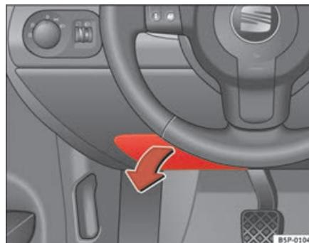
Abb. 184 Links in der Instrumententafel: Abdeckung des Sicherungskastens
