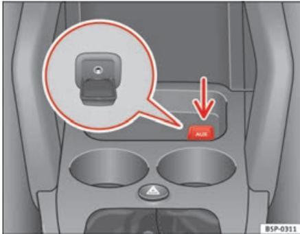
Abb. 120 Anschluss für einen zusätzlichen Audio-Eingang
