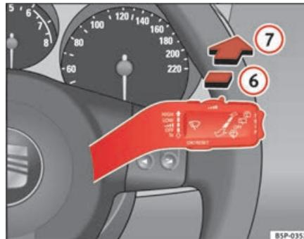
Abb. 89 Scheibenwischer- und Scheibenwischerhebel: Scheibenwischer für die Heckscheibe
