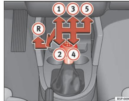
Abb. 138 Ausschnitt aus der Mittelkonsole: Schalt-schema vom 5-Gang-Schaltgetriebe
