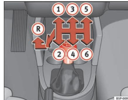
Abb. 139 Ausschnitt aus der Mittelkonsole: Schalt-schema vom 6-Gang-Schaltgetriebe
