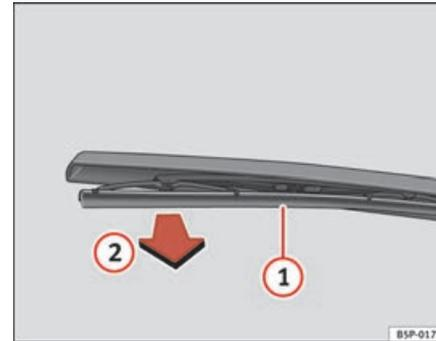
**Abb. 172** Scheibenwischerblatt hinten auswechseln
