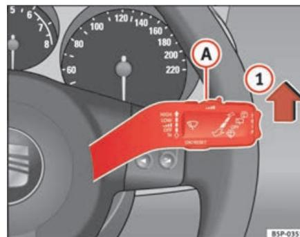
Abb. 88 Scheibenwischerhebel
