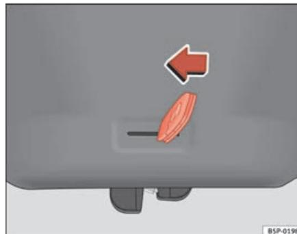
**Abb. 68 Heckklappe: Notöffnung**
