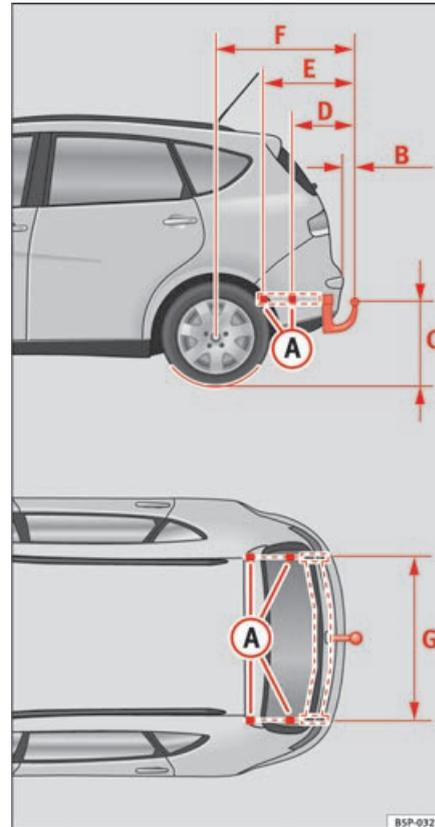
Abb. 161 Befestigungspunkte für die Anhangvorrichtung
