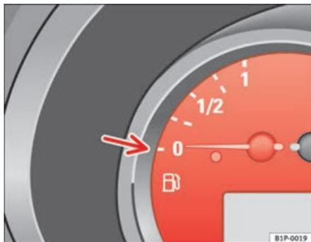
Abb. 34 Ausschnitt aus Kombiinstrument: Kraftstoffvorrats-Anzeige
