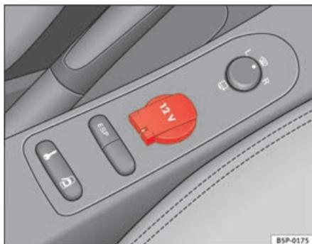
Abb. 118 Steckdose an der Mittelkonsole vorne
