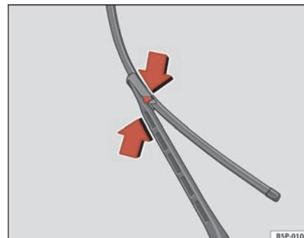
**Fig. 163** Remplacement des balais d'essuie-glace avant
