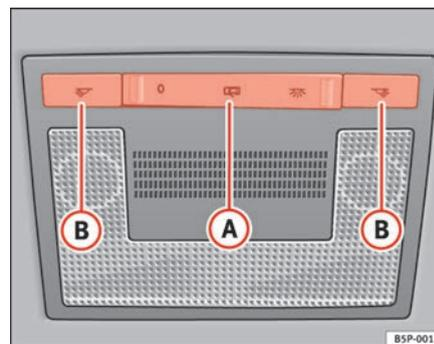
**Fig. 81** Détail du ciel de pavillon : lampes de lecture avant type 2
