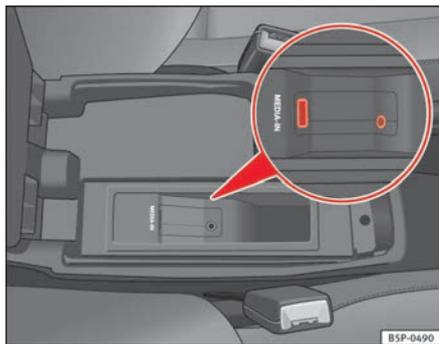
Fig. 122 Connexion dans l'accoudoir central
