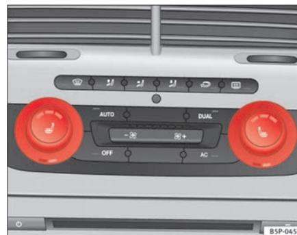
**Fig. 96** Sièges avant chauffants avec Climatronic
