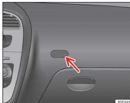
Fig. 27 Témoin de désactivation de l'airbag du passager
