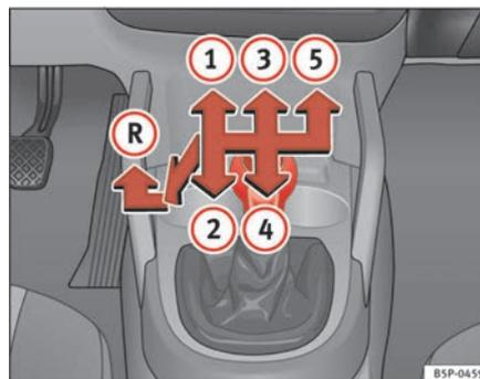
Fig. 139 Détail de la console centrale : grille des vitesses de la boîte mécanique à 5 vitesses
