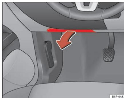
Fig. 177 A gauche dans le tableau de bord : cache de la boîte à fusibles
