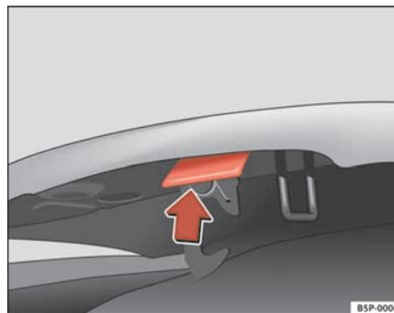
**Fig. 156** Gâchette d'ouverture du capot-moteur.
