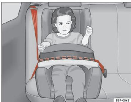
**Fig. 29** Siège pour enfant du groupe 1 monté dans le sens de la marche sur la banquette arrière.
