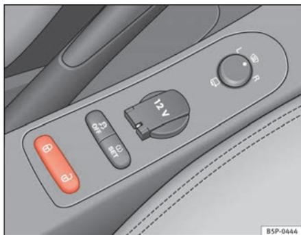
Fig. 58 Détail de la console centrale : touche de verrouillage centralisé
