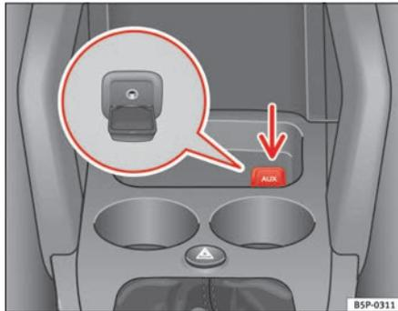
Fig. 120 Connecteur pour l'entrée auxiliaire audio
