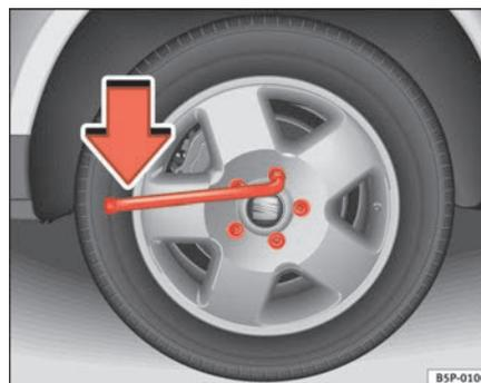
**Fig. 171** Changement d'une roue : desserrage des boulons de roue
