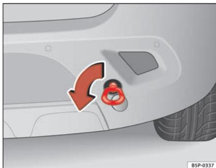
Fig. 200 Vissage de l'œillet de remorquage arrière
