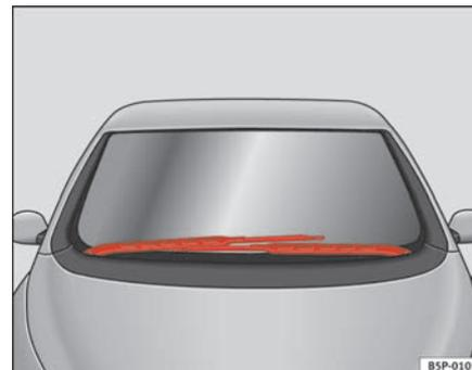
**Fig. 162** Essuie-glace en position de maintenance
