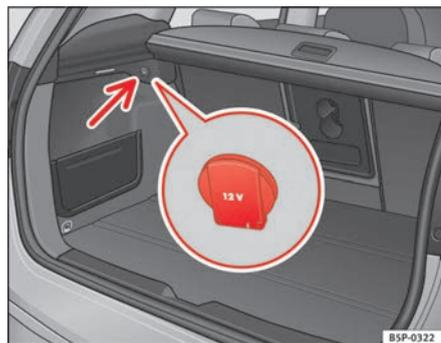
Fig. 119 Prise de courant dans le coffre à bagages
