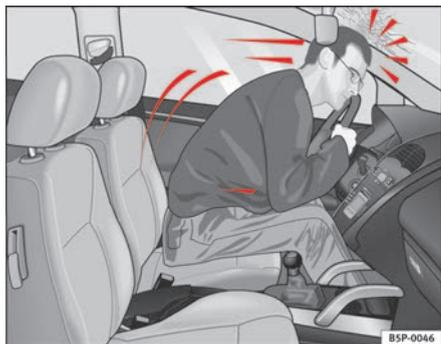
**Fig. 9** Le conducteur non sanglé est projeté en avant
