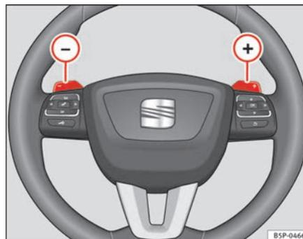
**Fig. 146** Volant avec leviers pour boîte de vitesses automatique
