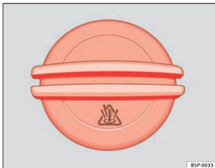
Fig. 160 Dans le compartiment-moteur : bouchon du vase d'expansion du liquide de refroidissement
