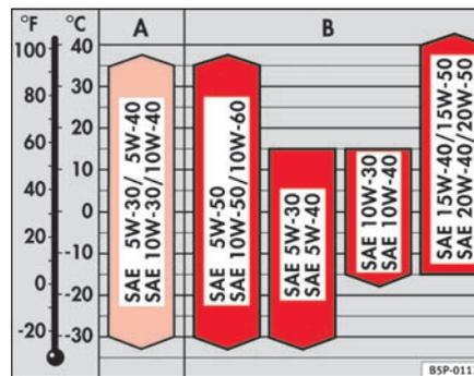
Fig. 157 Types d'huile en fonction de la température
