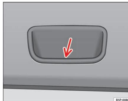
Fig. 66 Détail du revêtement intérieur du hayon arrière : poignée concave pour la fermeture
