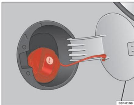
Fig. 154 Trappe du réservoir de carburant ouverte
