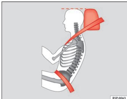
Fig. 4 Appuie-tête correctement réglé, vu de côté
