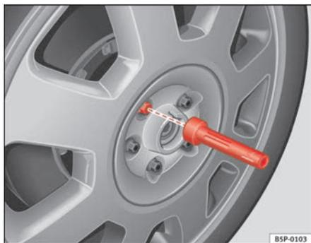
Fig. 175 Changement de roue : outil à six pans creux pour tourner les boulons
