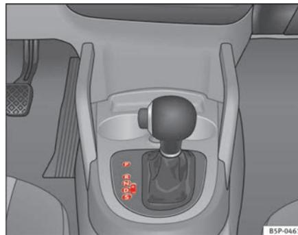
Fig. 141 Détail de la console centrale : levier sélecteur de la boîte automatique ou de la boîte automatique DSG
