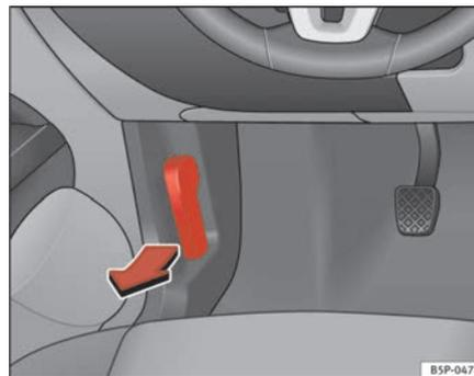
**Fig. 155** Détail du plancher côté conducteur : levier de déverrouillage du capot-moteur.
