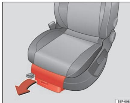
Fig. 103 Rangements sous les sièges avant
