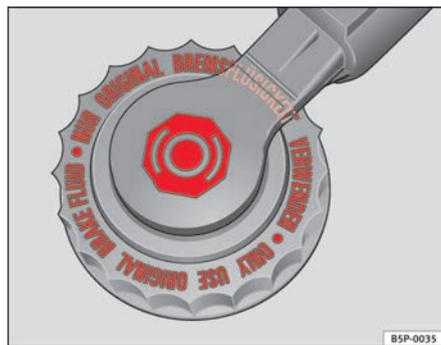
**Fig. 166** Dans le compartiment-moteur : bouchon du réservoir de liquide de frein
