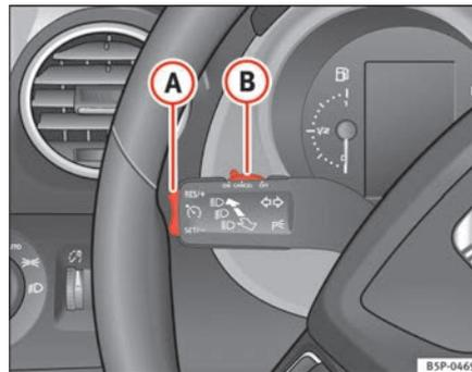
**Fig. 152** Manette des clignotants et de l'inverseur codes/phares : commande et touche à bascule du régulateur de vitesse
