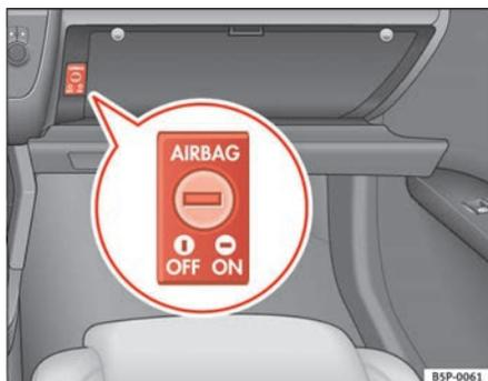
Fig. 26 Dans la boîte à gants : commande à clé pour commuter et désactiver les airbags côté passager avant
