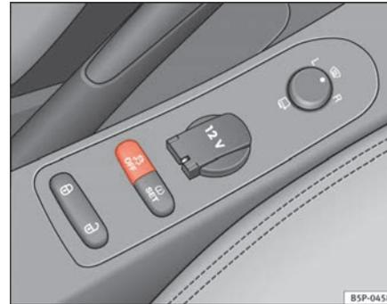
**Fig. 137** Détail de la console centrale : touche ESP
