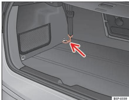
Fig. 126 Oeillets d'accrochage permettant de tendre le filet de séparation
