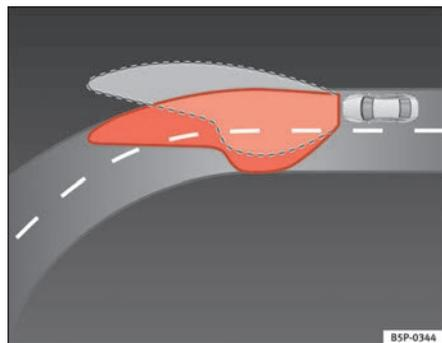
Fig. 75 Éclairage du virage à l'aide des phares auto-directionnels
