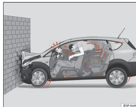
**Fig. 8** Le véhicule heurte le mur : les occupants ne portent pas de ceinture de sécurité.
