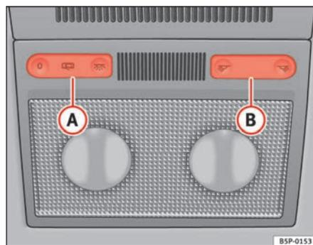
**Fig. 80** Détail du ciel de pavillon : lampes de lecture avant type 1
