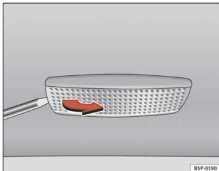
Fig. 196 Démontage de l'éclairage du pare-soleil
