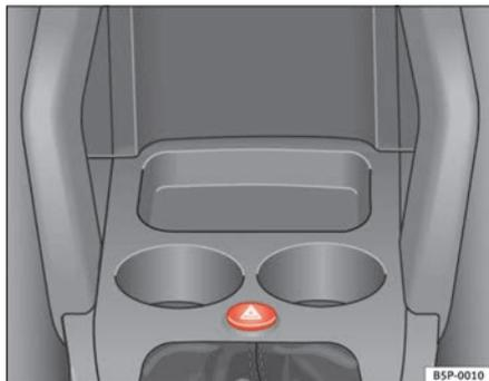
Fig. 76 Détail du tableau de bord : commande du signal de détresse
