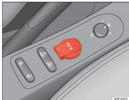
Fig. 118 Prise de courant sur la console centrale avant
