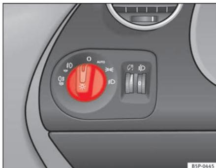
Fig. 72 Détail du tableau de bord : commande des phares, des projecteurs antibrouillard et du phare antibrouillard arrière
