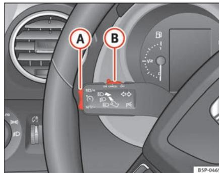
Fig. 151 Manette des clignotants et de l'inverseur codes/phares : commande et touche à bascule du régulateur de vitesse
