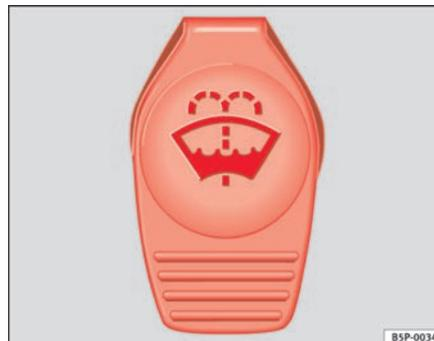
**Fig. 161** Dans le compartiment-moteur : bouchon du réservoir de lave-glace
