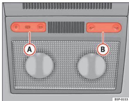
Fig. 78 Garniture du toit : plafonnier avant
