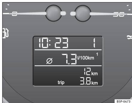
Fig. 40 Afficheur numérique du combiné d'instruments
