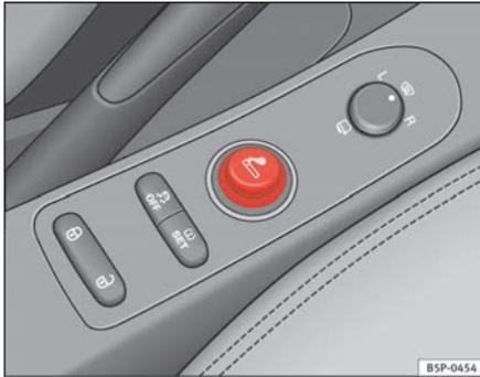
Fig. 117 Allume-cigare branché dans la prise de courant de la console centrale avant
