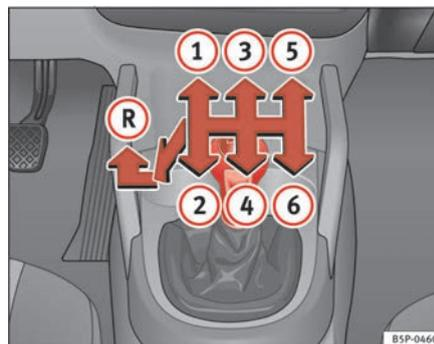
Fig. 140 Détail de la console centrale : grille des vitesses de la boîte mécanique à 6 vitesses
