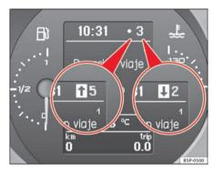
Fig. 38 Gear display
