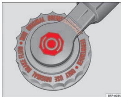
**Fig. 166** Tampão do reservatório do líquido dos travões no compartimento do motor
