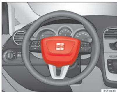
**Fig. 18** Airbag do condutor no volante
