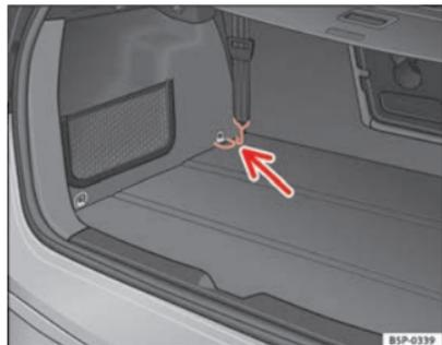
Fig. 126 Argolas de fixação para tensar a rede de separação
