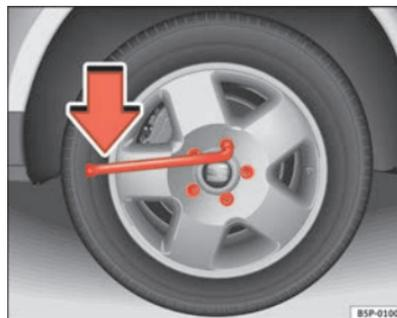
Fig. 171 Substituição de pneu: desapertar os parafusos da roda
