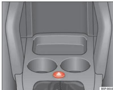
Fig. 76 Painel de instrumentos: comutador das luzes de emergência
