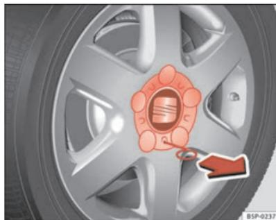
**Fig. 170** Substituição de pneu: Retirar o embelezador da roda
