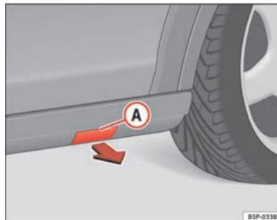
Fig. 174 Embaladeira de plástico com tampa para fixação do macaco
