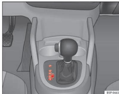
Fig. 141 Consola central: alavanca selectora da caixa de velocidades automática / caixa de velocidades automática DSG
