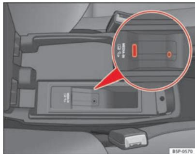
Fig. 122 Ligação no apoio de braços central
