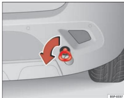
**Fig. 200** Aparafusar a argola de reboque na parte traseira do veículo
