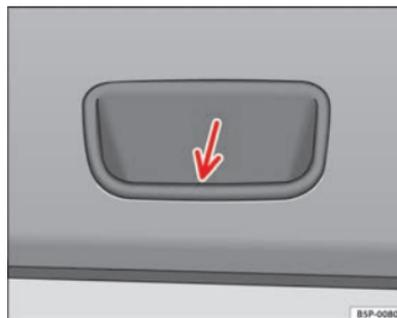
Fig. 66 Pormenor do revestimento interior da porta do porta-bagagens: reentrância para puxar
