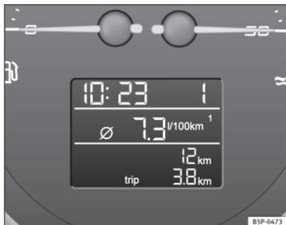
Fig. 40 Visor digital do painel de instrumentos
