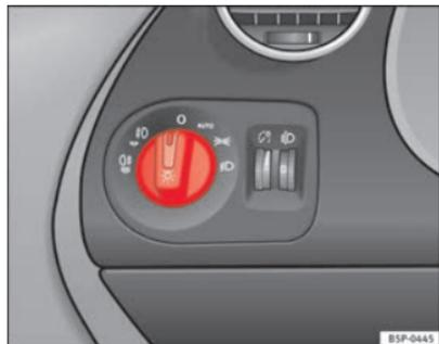
Fig. 72 Pormenor do painel de instrumentos: comando das luzes, faróis de nevoeiro e luz traseira de nevoeiro
