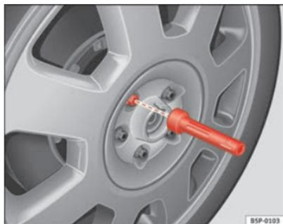
Fig. 175 Substituição de pneu: Ferramenta com sextavado interior para rodar os parafusos
