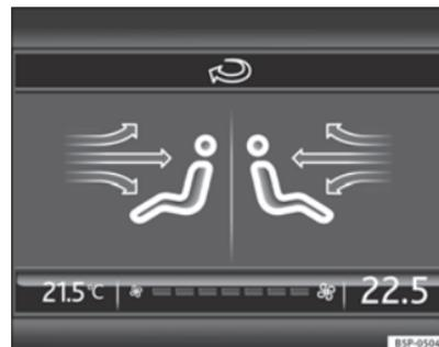
Fig. 132 Visor do navegador com informação do Climatronic
