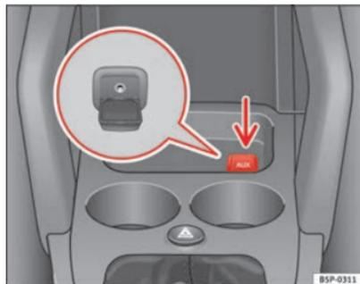
Fig. 120 Conector para a entrada auxiliar de áudio
