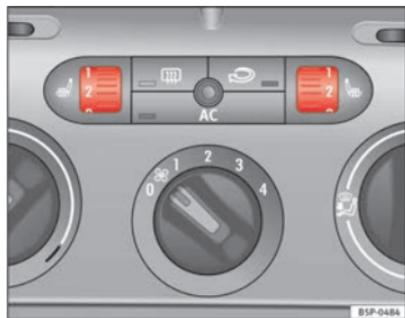
**Fig. 95** Rodas recartilhadas do aquecimento dos bancos dianteiros
