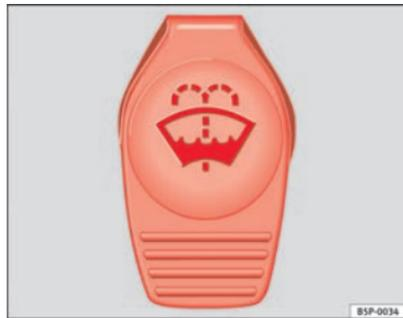
**Fig. 161** Tampão do reservatório do limpa-vidros no compartimento do motor.
