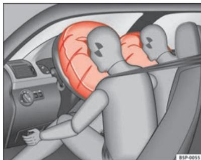
**Fig. 20 Airbags frontais insuflados**
