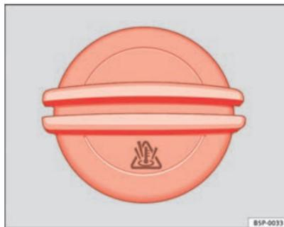
**Fig. 160** Tampão do reservatório de expansão do líquido de refrigeração no compartimento do motor
