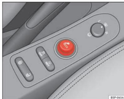
Fig. 117 Isqueiro alojado na tomada de corrente da consola central dianteira
