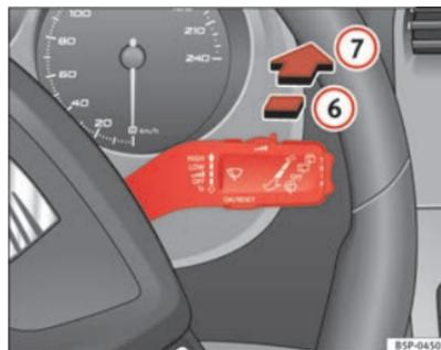
**Fig. 88** Manípulo do limpa/lava-vidros: limpa-vidros traseiro
