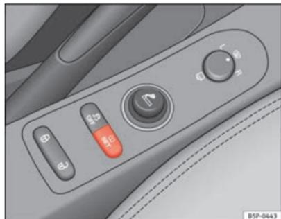
Fig. 49 Consola central: botão do sistema de controlo dos pneus
