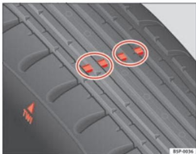
Fig. 167 Indicadores de desgaste no perfil do pneu
