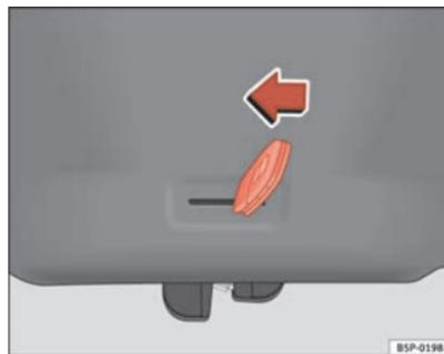
Fig. 66 Porta da bagageira: abertura de emergência
