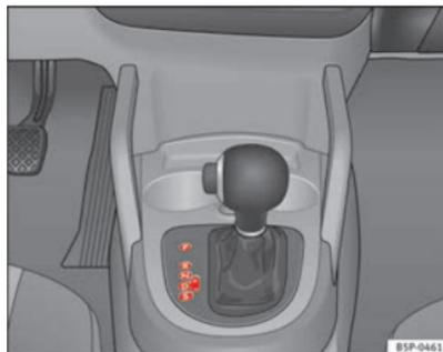
Fig. 140 Consola central: alavanca selectora da caixa de velocidades automática / caixa de velocidades automática DSG
