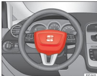
**Fig. 18** Airbag do condutor no volante
