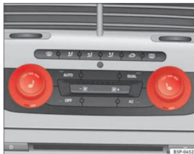
**Fig. 95** Aquecimento dos bancos dianteiros com Climatronic
