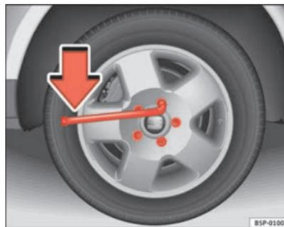
**Fig. 169** Substituição de pneu: desapertar os parafusos da roda
