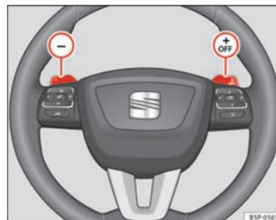
**Fig. 145 Volante com patilhas para a caixa de velocidades automática**
