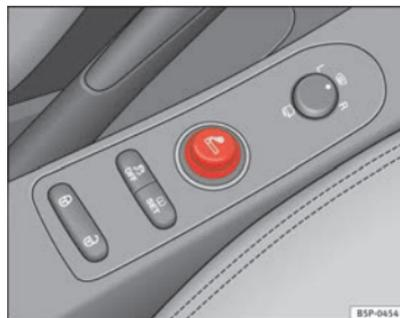
Fig. 116 Isqueiro alojado na tomada de corrente da consola central dianteira
