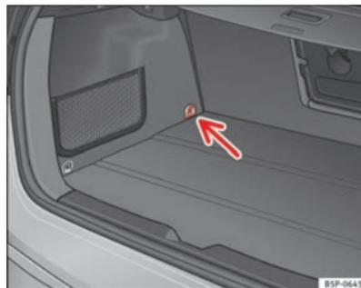
Fig. 32 Anel de fixação Toptether\*
