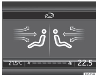
Fig. 131 Visor do navegador com informação do Climatronic
