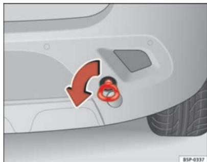
Fig. 199 Aparafusar a argola de reboque na parte traseira do veículo
