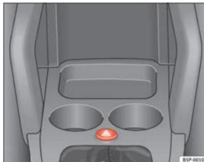
Fig. 75 Painel de instrumentos: comutador das luzes de emergência
