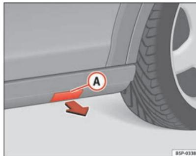
Fig. 172 Embaladeira de plástico com tampa para fixação do macaco
