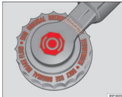
**Fig. 164** Tampão do reservatório do líquido dos travões no compartimento do motor
