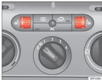
**Fig. 94** Rodas recartilhadas do aquecimento dos bancos dianteiros
