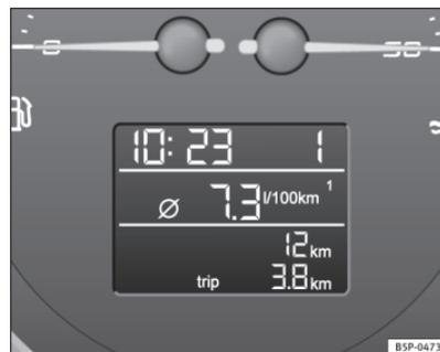
Fig. 43 Visor digital do painel de instrumentos: indicador consumo médio de combustível.
