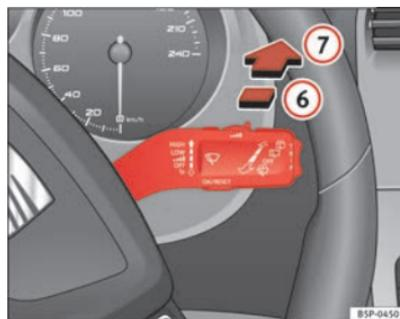
**Fig. 87** Manípulo do limpa/lava-vidros: limpa-vidros traseiro
