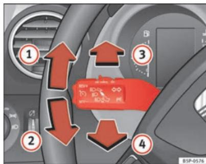
Fig. 76 Manípulo das luzes indicadoras de mudança de direcção e dos máximos
